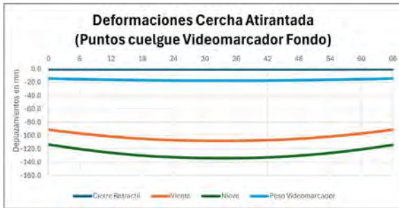
Figura 5. Deformaciones punto de cuelgue videomarcador fondo.
