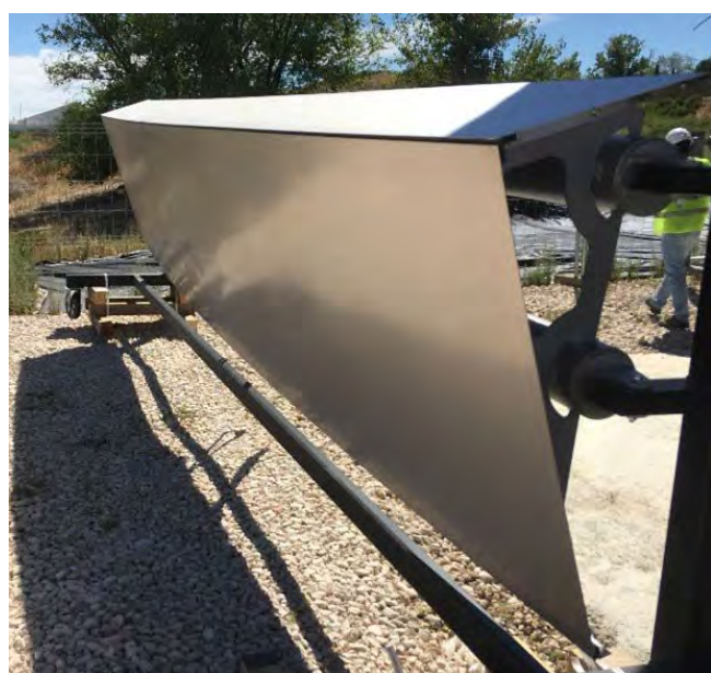
Figura 28. Fotografías de las muestras fabricadas para verificar la planimetría alcanzable por el sistema constructivo y método de fabricación digital previsto.
