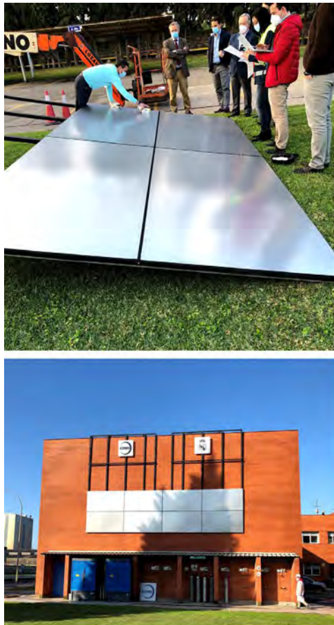
Figura 26. Fotografías de las muestras visuales para determinar límites admisibles de desviación y ejemplo de dibujos y solución instalada de la aplicación de aleatoriedad de lotes en la fachada.
