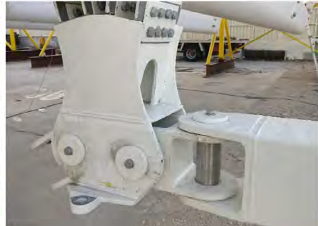
Figura 61. Mecanizado y ensamblado barras de estabilización.
