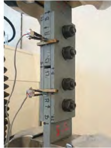
Figura 8. Ensayos coeficiente de rozamiento unión atornillada.
