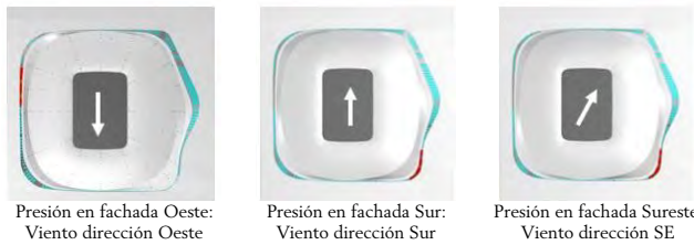
Figura 18. Esquema de las direcciones de ataque del viento escogidas para la modelización del CFD en succión.
