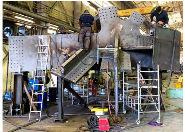
Figura 5. Trípede de conexión -izquierda- y nudo principal de conexión Corona-Torre-Trípede -derecha-.
