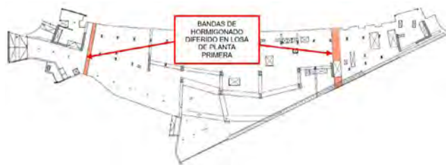
Figura 33 Situación de bandas de hormigonado diferido en losa de Planta Primera
