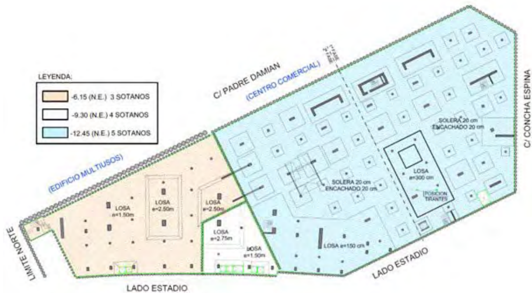
Figura 2. Planta de cimentación.
