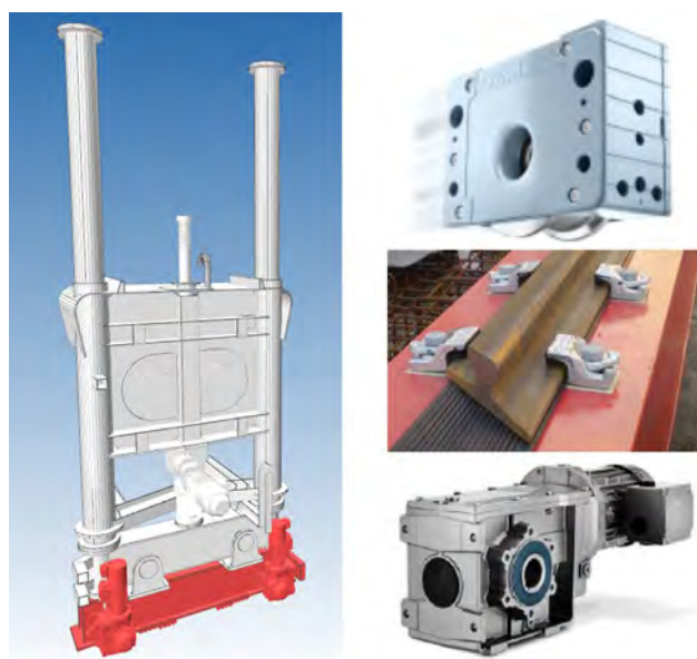
Figura 54. Sistema de traslación.
