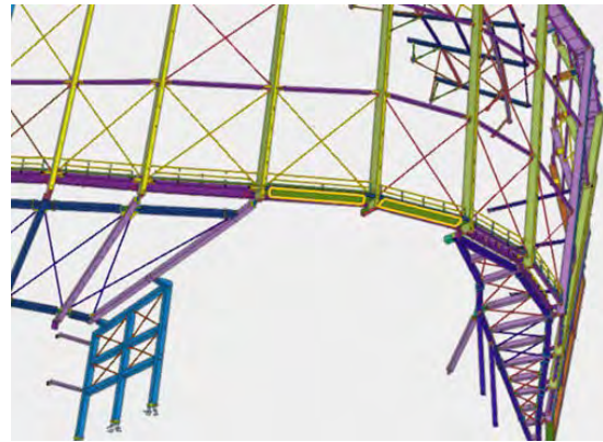
Figura 18. Modelo de taller (INBERSA): Izquierda: Estructura de sofito en torno a torres del oeste Derecha: Estructura de sofito en torno a torres del este.
