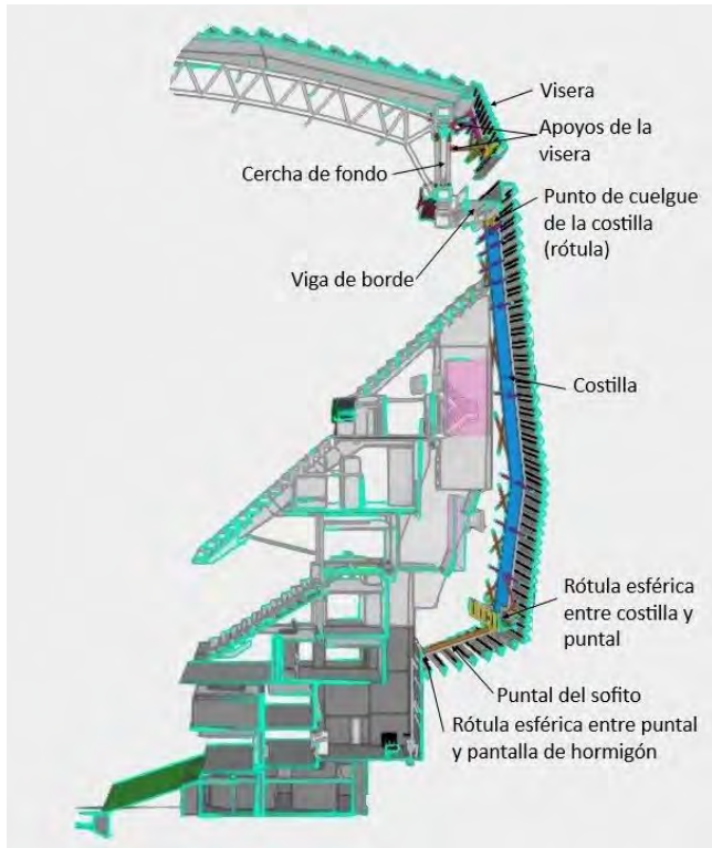
Figura 13. Puntos de apoyo de fachada en los fondos.
