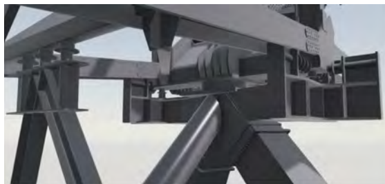
Figura 18. Vistas apoyos y bloqueos provisionales primeras dovelas y prolongación cercha atirantada.
