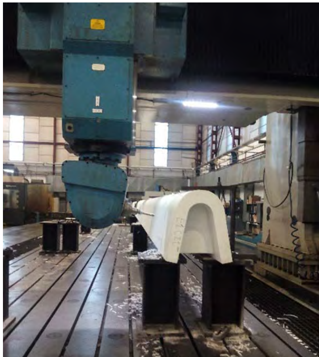
Figura 41. Proceso de taladrado cercha.
