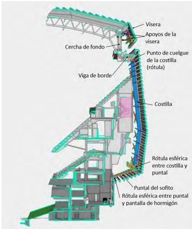
Figura 13. Puntos de apoyo de fachada en los fondos.
