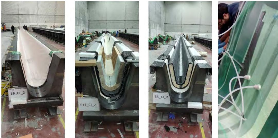
Figura 38. Proceso de fabricación cordón inferior.
