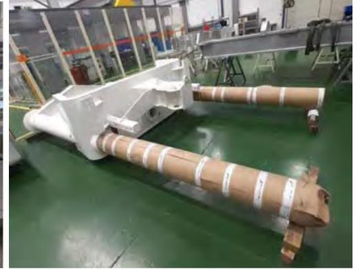
Figura 60. Diafragma ensamblado preparado para el transporte.
