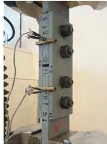
Figura 8. Ensayos coeficiente de rozamiento unión atornillada.
