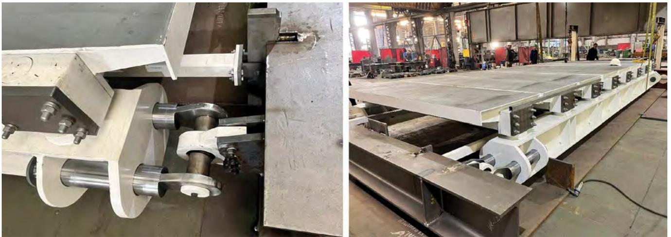
Figura 56. Prueba de funcionamiento puentes basculantes.
