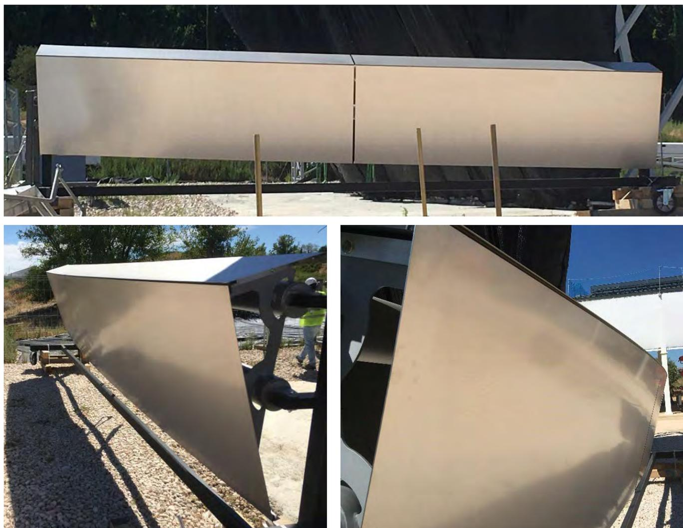
Figura 28. Fotografías de las muestras fabricadas para verificar la planimetría alcanzable por el sistema constructivo y método de fabricación digital previsto.
