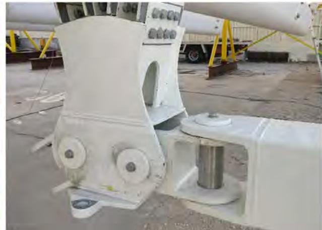
Figura 61. Mecanizado y ensamblado barras de estabilización.
