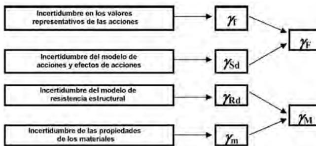
Fig. C.3 – Relación entre los diferentes coeficientes parciales
