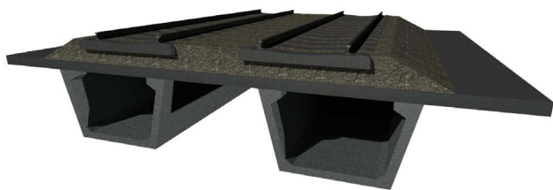
Figura 1. Configuración tipo del tablero de puente FFCC.
