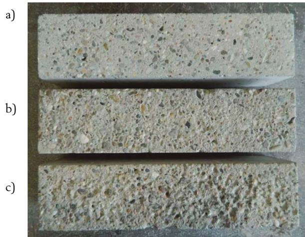
Figura 3. Rugosidad de las probetas de hormigón.
