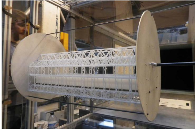
Figura 5. Modelo reducido utilizado en los tests en túnel de viento.
