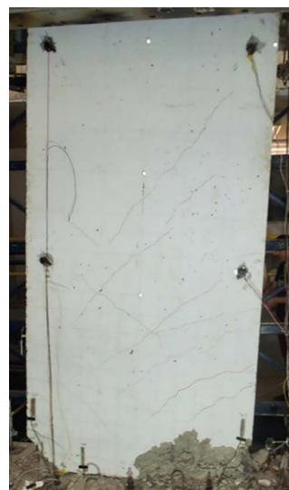
Figura 4. Estado final del muro MOR10.
