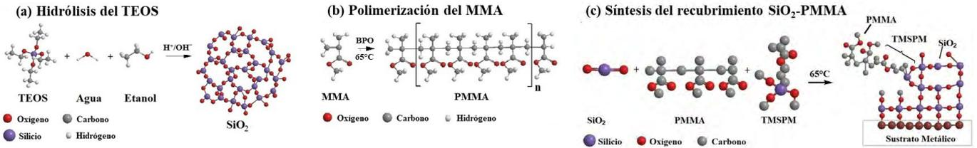
Figura 3. Diagrama esquemático del mecanismo de obtención del híbrido (a) Síntesis del SiO<sub>2</sub>, (b) Polimerización del MMA y (c) Obtención del híbrido SiO<sub>2</sub>-PMMA. (Se omite la representación de los hidrógenos para mayor claridad).
