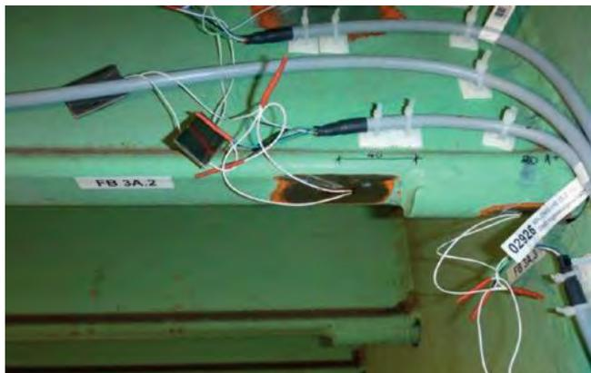
Figura 13. Extensómetros colocados en el tablero (LAP).
