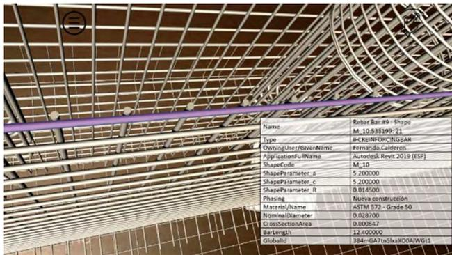
Figura 11. Información BIM de una barra
