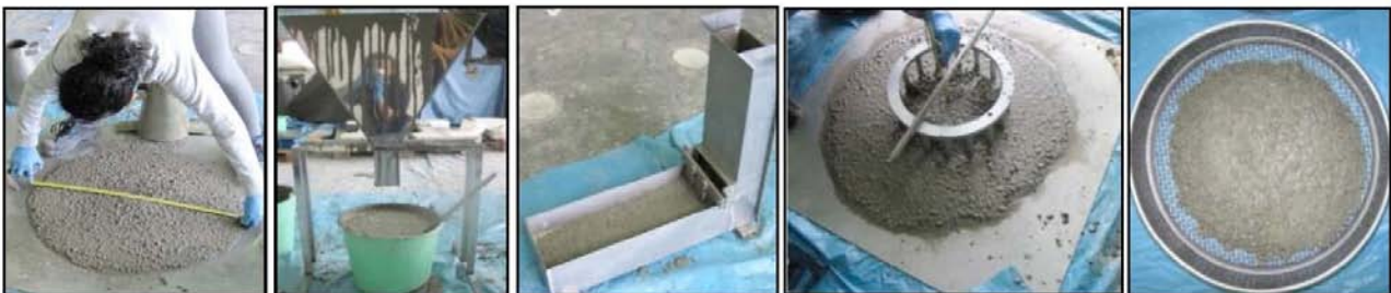
Ensayos empíricos en hormigón autocompactante con árido reciclado fino
