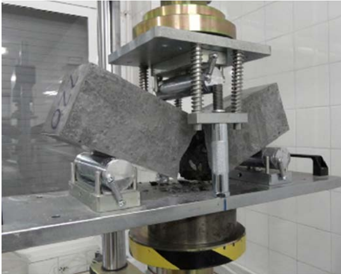
Aspecto rotura de los hormigones en el ensayo a flexión a 3 puntos
