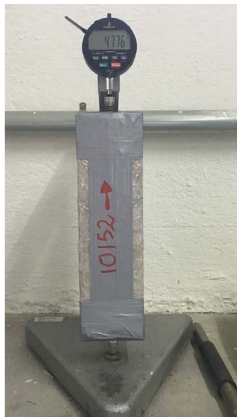
Medida de la expansión sobre prismas restringidos de acuerdo con ASTM C878
