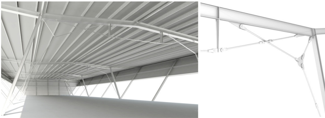
Detalle del pórtico "Skelsion" mostrando la esbeltez de los atirantamientos y los detalles de unión
