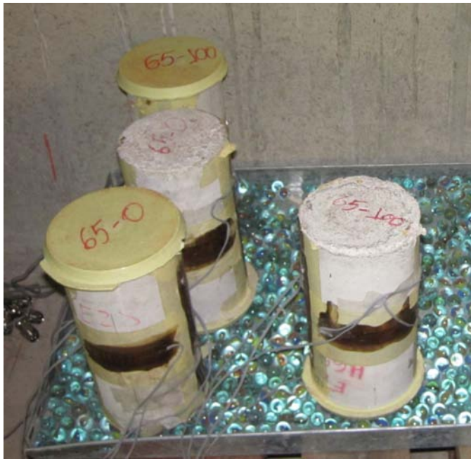
Probetas de hormigón tras descarga
