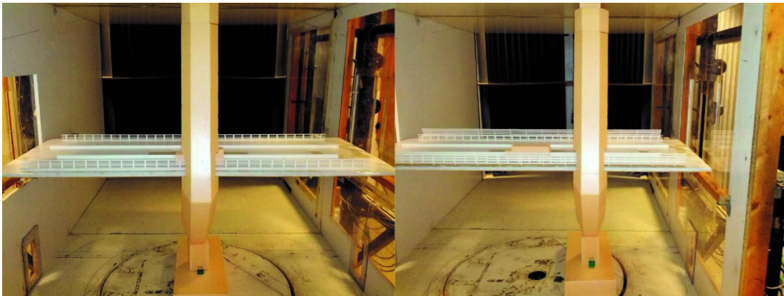
Maqueta de modelo seccional. Estudio de influencia de las torres en la acción del viento sobre los vehículos
