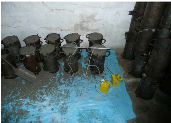
Instrumentación del ambiente y de las probetas de control
