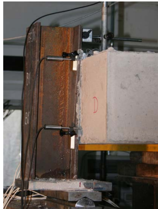
Instrumentación del apoyo en el ensayo experimental de la unión
