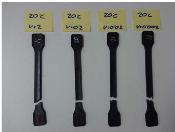
Probetas de polietileno reforzado con fibra de vidrio ensayadas a diferentes velocidades
