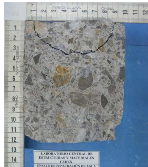
Perfil de penetración de agua
