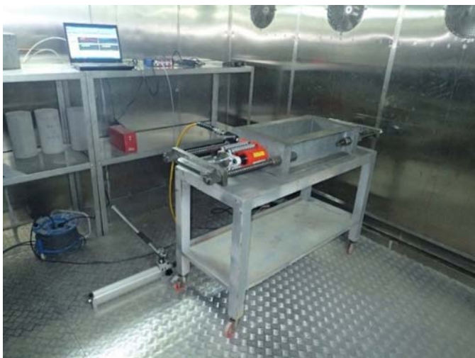
Montaje de los ensayos de relajación sobre cables de Ni-Ti-Nb
