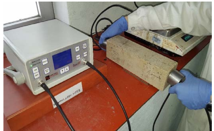
Ensayos de hielo-deshielo (ASTM C 666). Medida de ultrasonidos en las probetas
