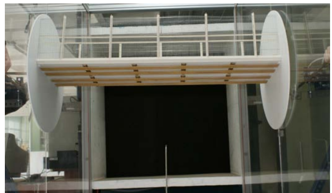
Modelo seccional de la pasarela de Cuenca
