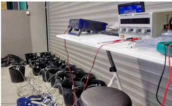
Vista general del montaje para el ensayo de corrosión forzada de barras de acero
