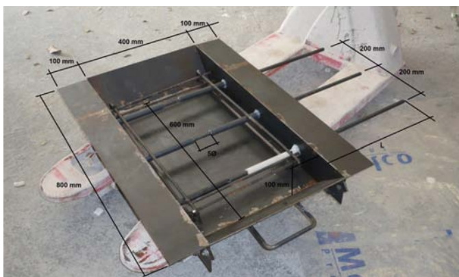
Figura 1. Artesa para fabricación de las muestras de ensayo
