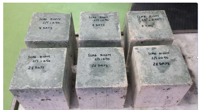
Probetas de hormigón de escoria activada alcalinamente con silicato sódico (waterglass) a los 28 días
