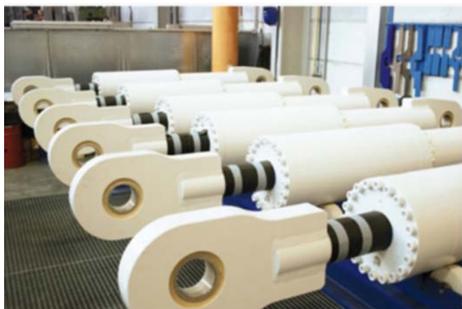
Amortiguadores sísmicos semejantes a los que se dispondrán en el Viaducto 2
