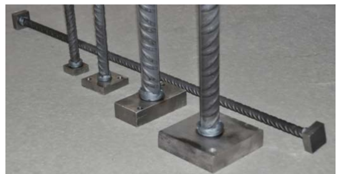
Barras ancladas mediante placas, soldadas por fricción: en segundo plano, las barras de cortante
