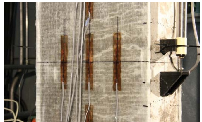
Fisuración de una probeta de hormigón revestida de PRFV en ensayo de tracción
