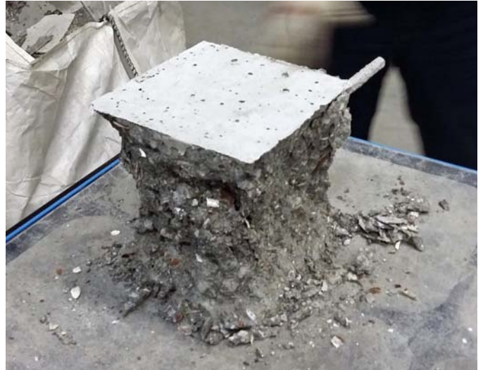
Probeta con sustitución parcial de concha de mejillón tras el ensayo de compresión
