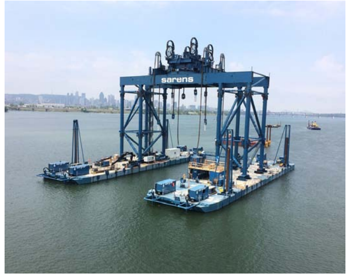
Pruebas de navegación y funcionales del FFI (Floating Foundations Installer) descargado
