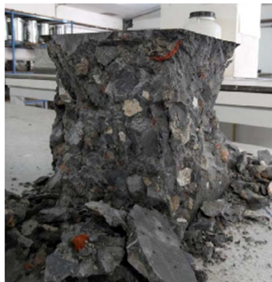
Aspecto de una probeta de hormigón reciclado tras haber sido sometida al ensayo de compresión
