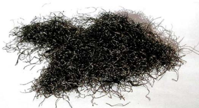
Figura 1. Fibras metálicas recicladas
