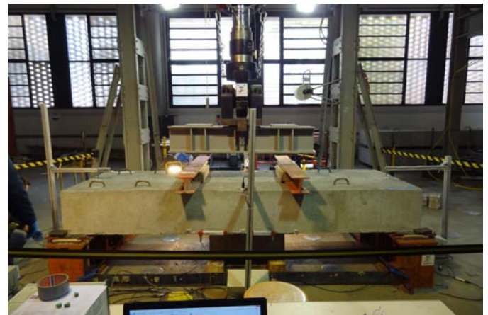
Figura 1. Configuración de apoyo para el ensayo de flexión a escala real
