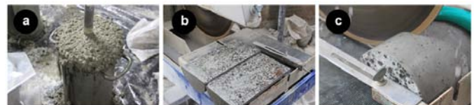
a) Fabricación de las probetas, b) sección vertical: segregación, c) sección horizontal: densidad
