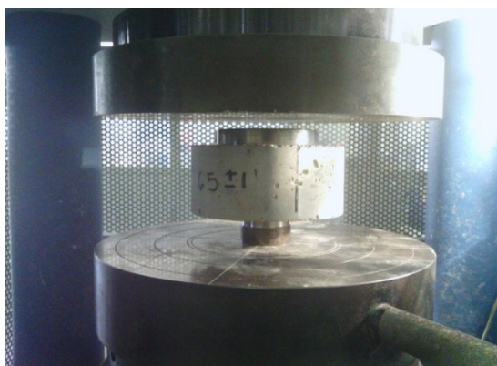
Figura 1. Configuración del ensayo y área resistente de la probeta
