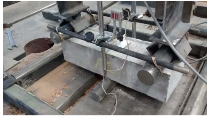
Figura 1. Ensayo de flexión en tres puntos
