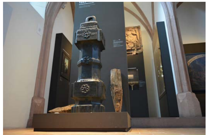
Figura 2. Martinete y puntaza de un pilote de puente en Basilea
