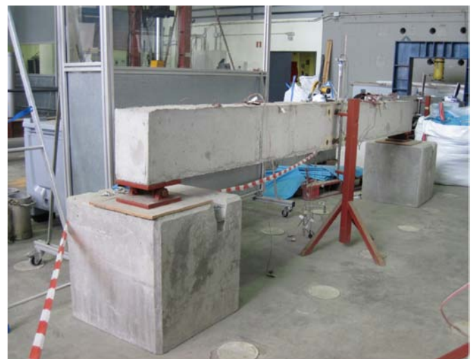
Vigas tras descarga. Registro de recuperación de flechas
