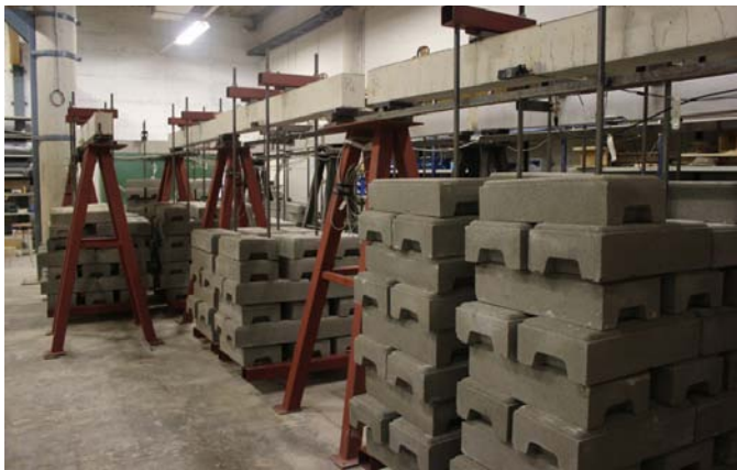
Disposición del ensayo con carga mantenida
