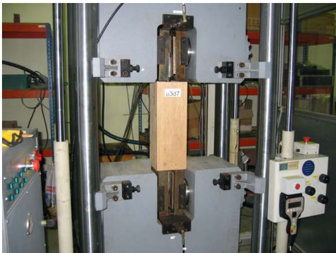
Ensayo a doble tracción implementado en la máquina universal de ensayos
