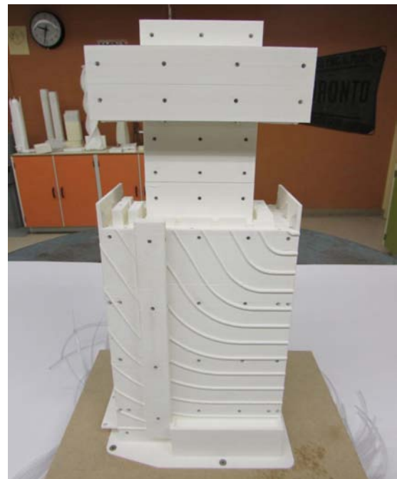
Figura 1. Vista del modelo de presiones con la volumetría modificada
