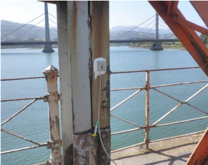
Banda extensométrica en montante
