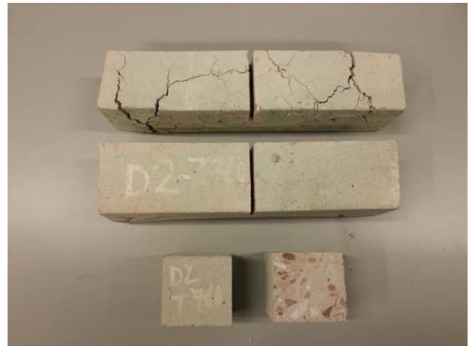
Hormigón enfriado tras ser sometido a 700 °C
