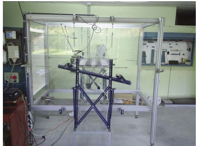
Sistema de muelles soporte de un modelo seccional de tablero
