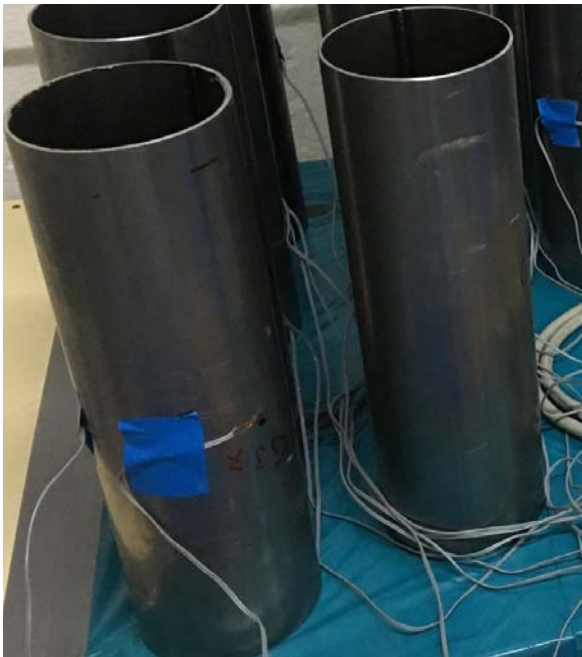
Medida de la expansión en tubos de acero rellenos de hormigón mediante galgas
