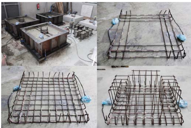
Fabricación de especímenes; Tres configuraciones de armado monitorizadas con galgas extensométricas
