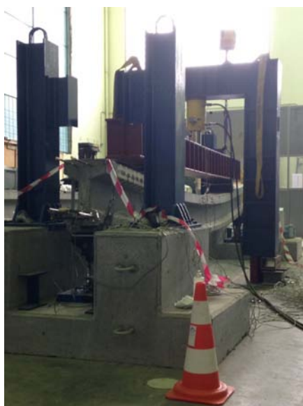
Ensayo de vigas prefabricadas pretensadas
