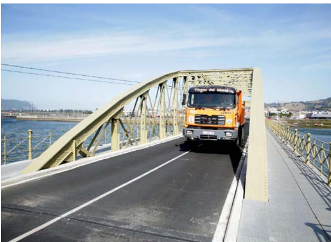
Prueba de carga dinámica excéntrica
