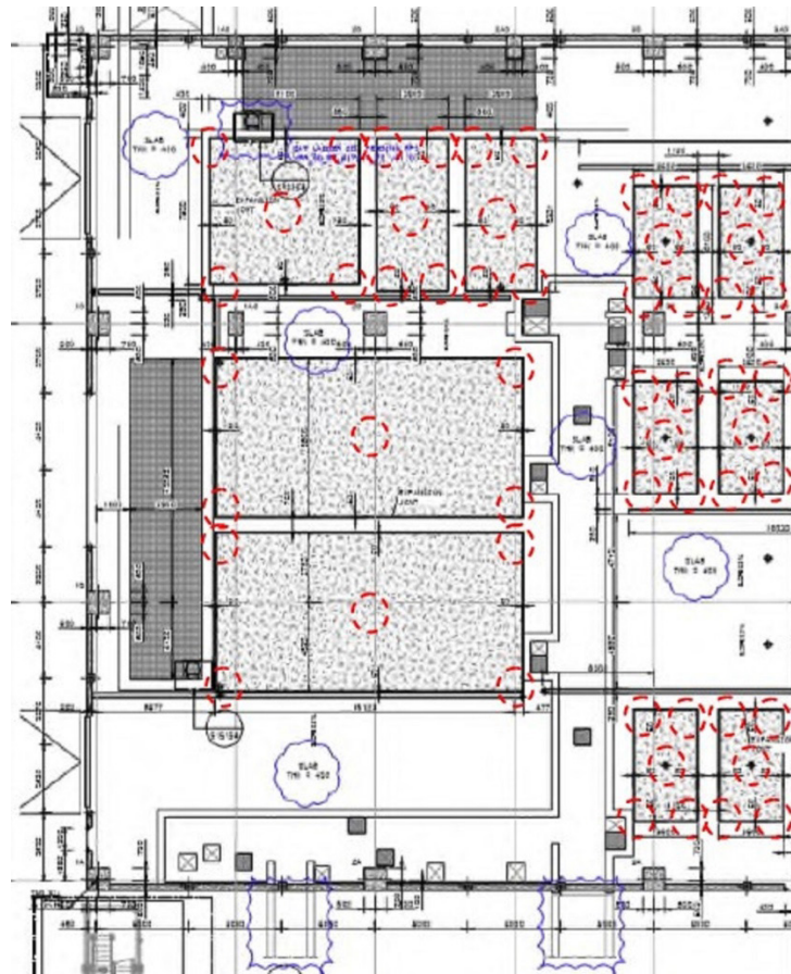
Puntos de control en los bloques de cimentación de los compresores
