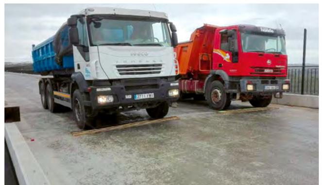
Figura 45. Posicionamiento de los camiones para prueba dinámica.
