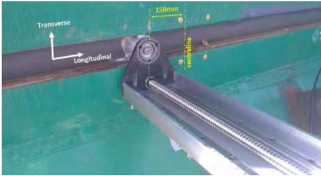
Figura 17. Localización DHD (Deep Hole Drilling).
