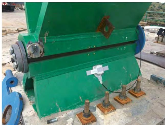
Figura 14. Bandas extensiométricas en la articulación.
