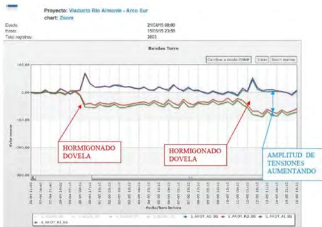
Figura 15. Tensiones en bandas extensiométricas de la articulación.
