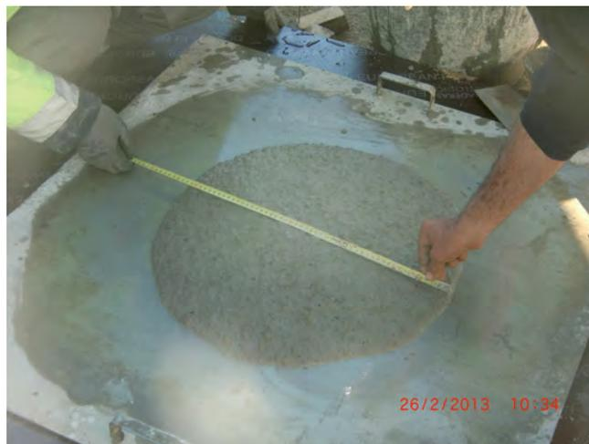
Figura 6. Comprobación de fluidez del hormigón.
