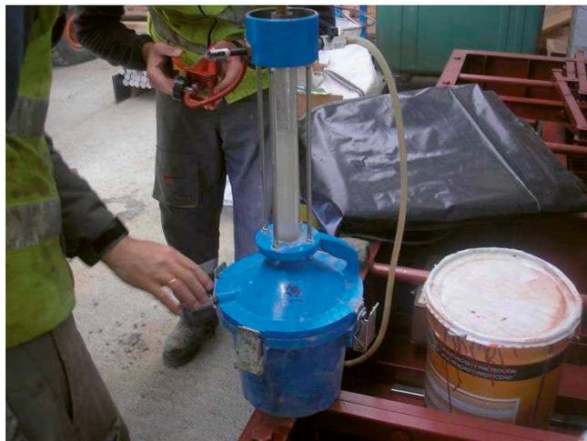
Figura 9. Ensayo de aire ocluido.
