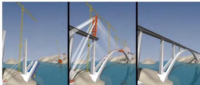
Figura 22. Infografías del procedimiento constructivo.
