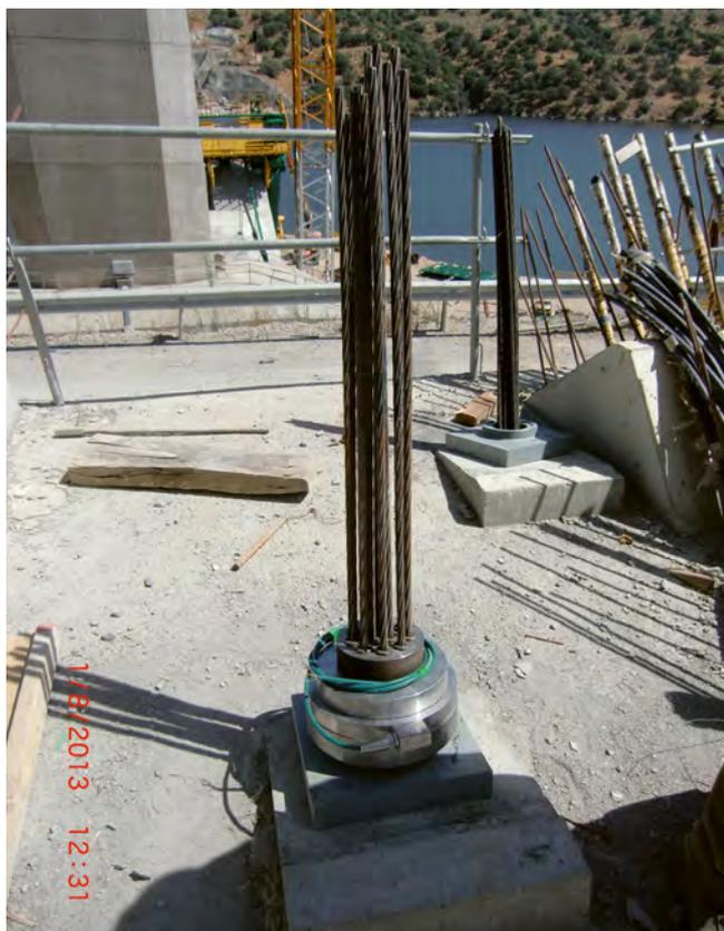
Figura 1. Célula de carga en anclaje al terreno.
