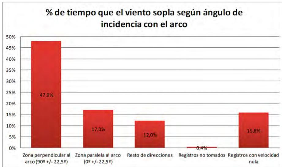
Figura 7. Frecuencia de direcciones del viento. Se aprecia la prevalencia de la dirección perpendicular al plano del arco.
