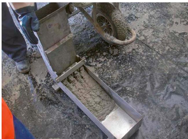
Figura 7. Ejecución de ensayo de caja en L.
