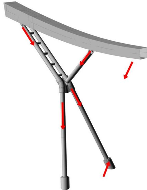
Figura 16. Esquema de general de fuerzas en las pilas principales de apoyo de la cubierta.
