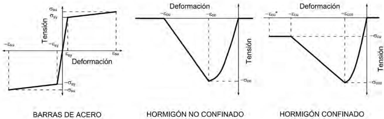
Figura 11. Modelos constitutivos para materiales en fibras de columnas.
