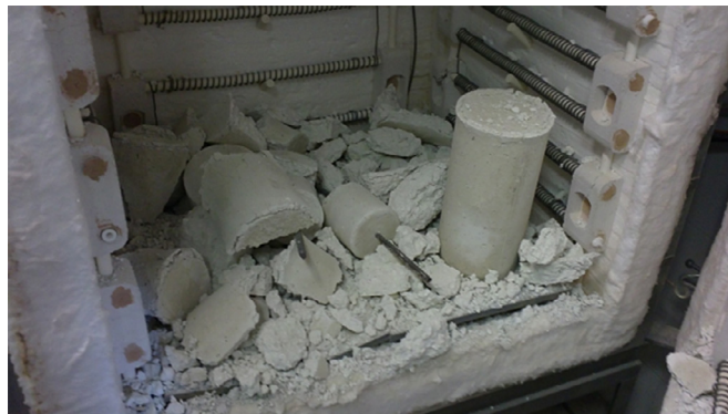
Figura 1. Rotura explosiva en un hormigón convencional durante el calentamiento.
