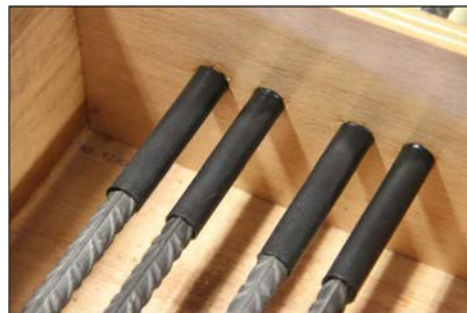
Figura 3. Encofrados de contrachapado fenólico y zona de adherencia inhibida.
