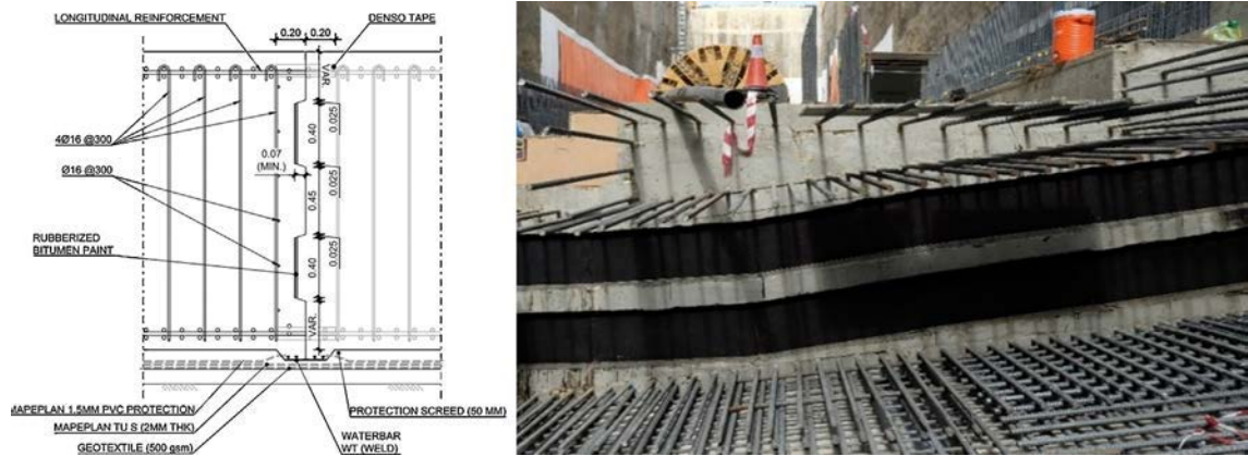
Figura 17. Detalle de la junta de contracción.
