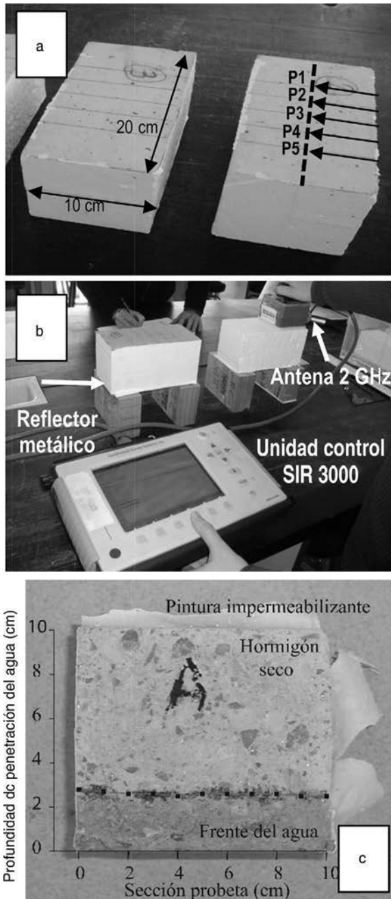
Figura 4. a) Posición de los puntos de registro con el georadar. Separación entre puntos de registro: 2,5 cm. b) Estudio estático con el georadar. c) Probeta de hormigón tras la inmersión y rotura a flexión en la que se ha marcado el frente de avance del agua.
