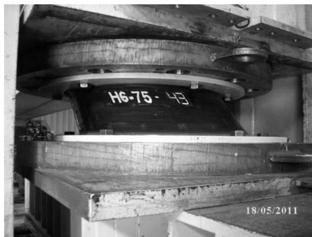
Figura 10. Ensayo dinámico sobre aislador sísmico.
