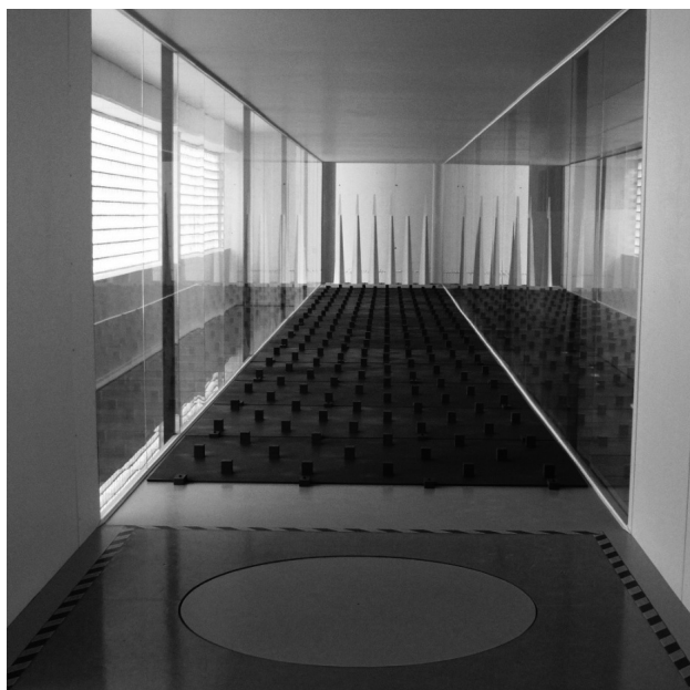
Figura 11. Vista del interior de la cámara de ensayos del túnel ACLA16 donde se muestran los generadores de turbulencia y los elementos de rugosidad. Nótese que las paredes de la precámara están acristaladas para facilitar la visualización
