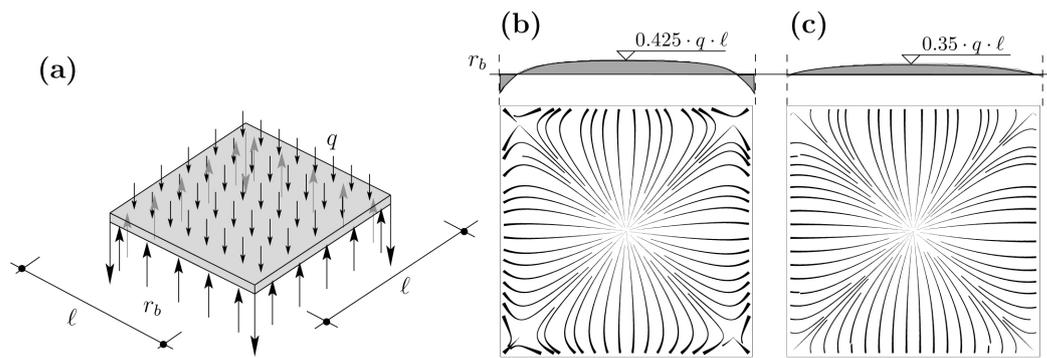
Figura 9. Solución elástica del campo de esfuerzos cortante y distribución de las reacciones de apoyo: (a) losa cuadrada apoyada en sus cuatro lados y cargada uniformemente ( $q$ ); (b) campo de esfuerzos cortantes elástico no fisurado ( $G_{el}$ ); y (c) campo de esfuerzos cortantes elástico fisurado ( $G_{el}/10$ ).
