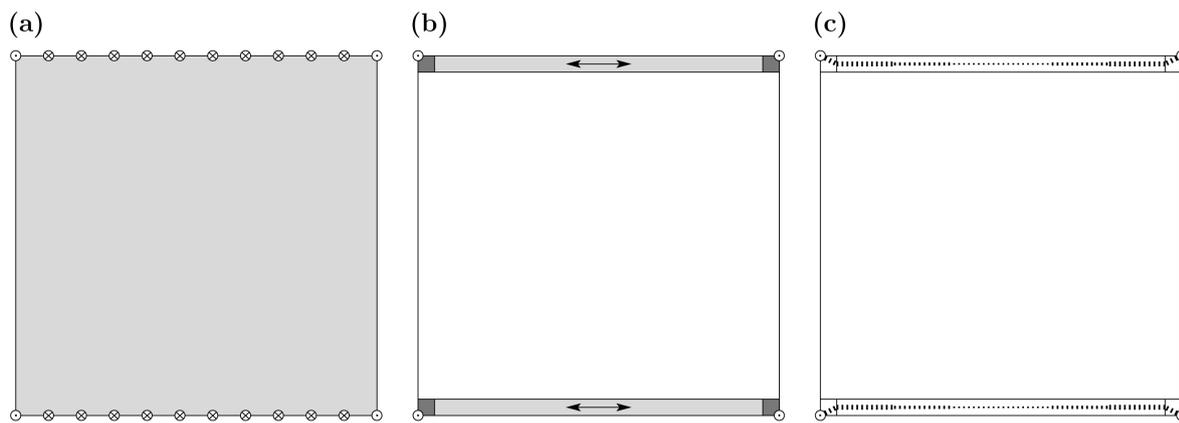
Figura 13. Transmisión de cargas en la losa de la figura 9 según el método de las bandas: (a) geometría de la losa y cargas; (b) bandas de borde; y (c) representación del campo de esfuerzos cortantes.
