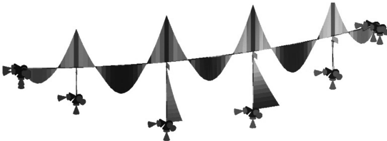
Figura 21. Modelo 3D. Envoltura de momentos flectores positivos a tiempo final.
