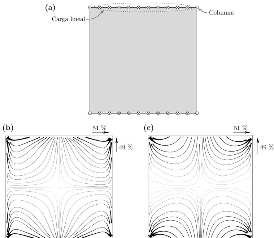
Figura 12. Campo de esfuerzos cortantes de la losa de la figura 9, solución elástica: (a) esquema de carga; (b) solución con módulo de elasticidad transversal  $G_{el}$ ; y (c) campo de esfuerzos cortantes con módulo de elasticidad transversal reducido ( $G_{el}/10$ ).
