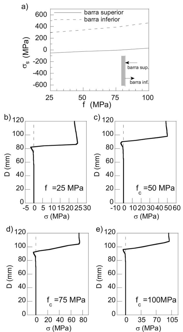
Figura 18. Influencia de la resistencia a compresión: a) Variación de las tensiones en las barras. Perfil tensional para: b)  $f_c = 25$  MPa; c)  $f_c = 50$  MPa; d)  $f_c = 75$  MPa; e)  $f_c = 100$  MPa.
