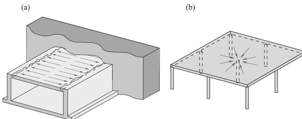
Figura 18. Transmisión de esfuerzos cortantes en losas de hormigón armado: (a) losa superior de un falso túnel; y (b) losa apoyada sobre columnas.
