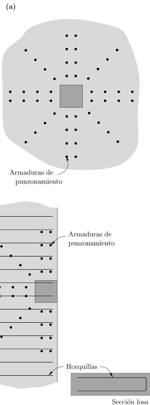
Figura 22. Armaduras transversales: (a) columna central (C3); columna de borde (C2).
