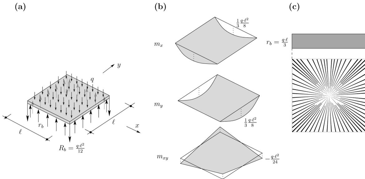
**Figura 8.** Losa cuadrada apoyada en sus cuatro lados sometida a carga distribuida, con reacciones de apoyo en las esquinas: (a) esquema de la losa; (b) solución de equilibrio para el campo de momentos; y (c) campo de esfuerzos cortantes y distribución de las reacciones de apoyo.
