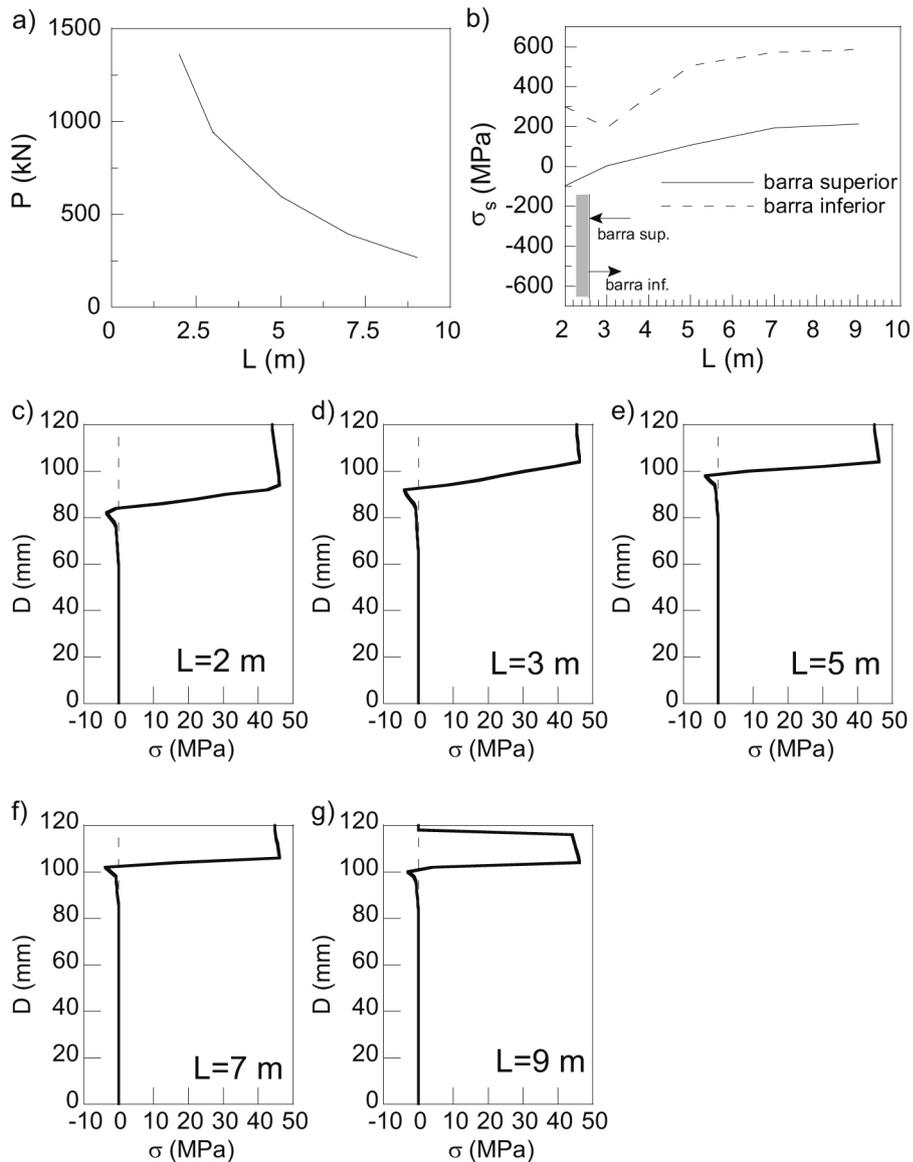
Figura 16. Influencia de la esbeltez: a) Variación de la carga con la altura del panel; b) Variación de las tensiones en las barras según la altura del panel. Perfil tensional para: c)  $L = 2$  m; d)  $L = 3$  m; e)  $L = 5$  m; f)  $L = 7$  m; g)  $L = 9$  m.
