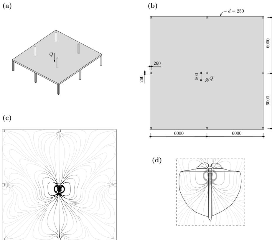
**Figura 24.** Losa empotrada en nueve columnas y sometida a una carga puntual: (a) esquema de la losa y cargas; (b) dimensiones (cotas en [mm]); (c) campo de esfuerzos cortantes; y (d) reparto de los esfuerzos cortantes alrededor de la columna central.
