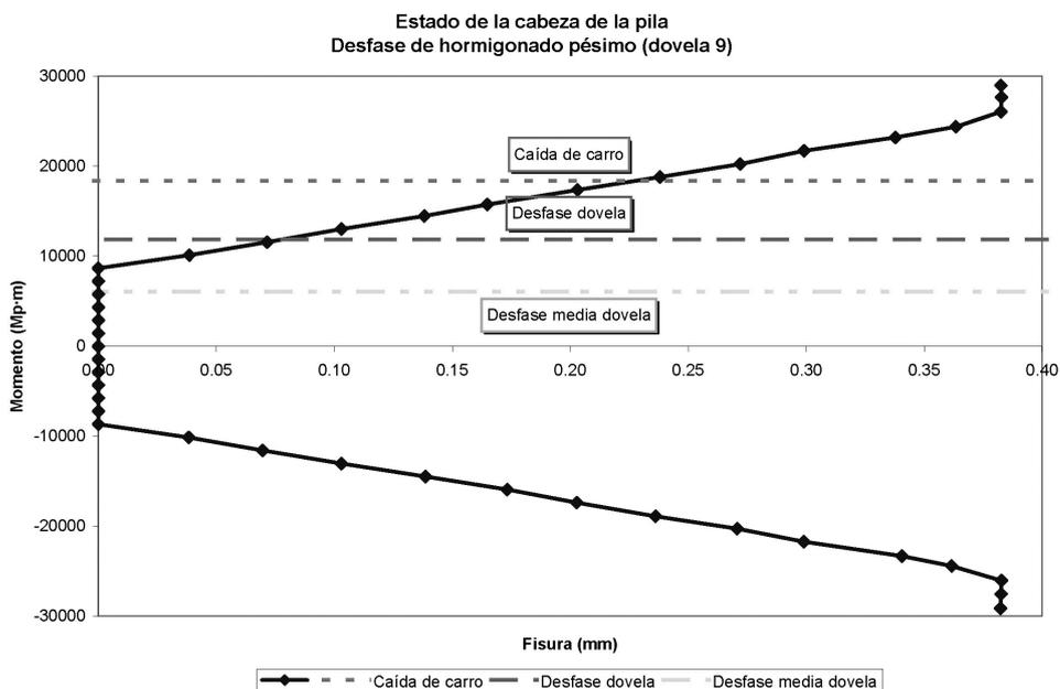
Figura 17. Diagrama momento - fisuración para la cabeza de la pila durante el hormigonado de la dovela 9.
