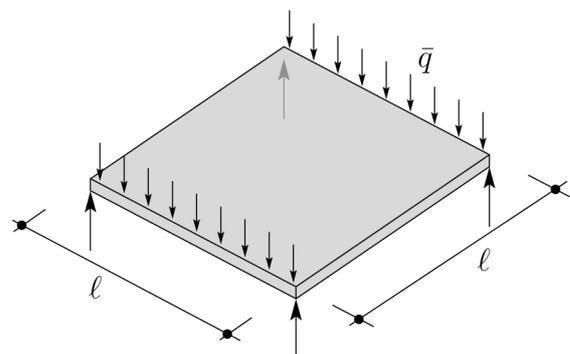
Figura 10. Losa cuadrada apoyada en las esquinas bajo dos cargas lineales.
