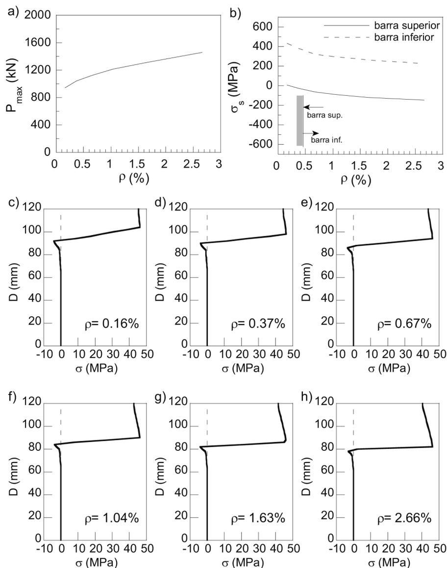
Figura 14. Influencia de la cuantía: a) Variación de la carga con la cuantía de armado; b) Tensiones en la barras de acero. Perfil tensional para: c)  $\rho = 0.16\%$ ; d)  $\rho = 0.37\%$ ; e)  $\rho = 0.67\%$ ; f)  $\rho = 1.04\%$ ; g)  $\rho = 1.63\%$ ; h)  $\rho = 2.66\%$ .
