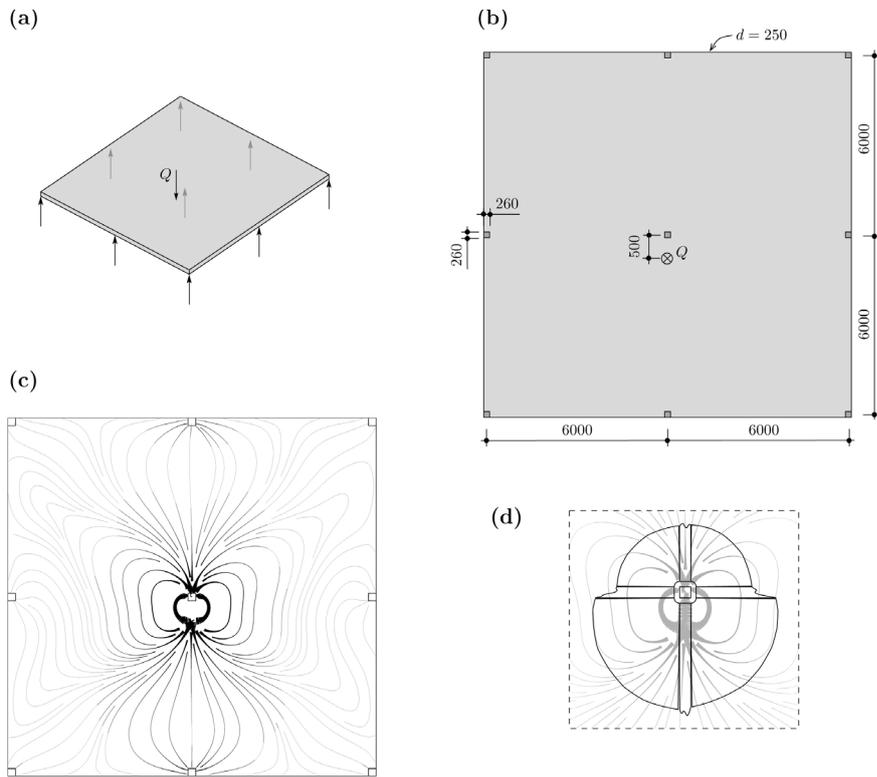
**Figura 23.** Losa apoyada sobre nueve columnas simplemente apoyadas y sometida a una carga puntual: (a) esquema de la losa y cargas; (b) dimensiones (cotas en [mm]); (c) campo de esfuerzos cortantes; y (d) reparto de los esfuerzos cortantes alrededor de la columna central.
