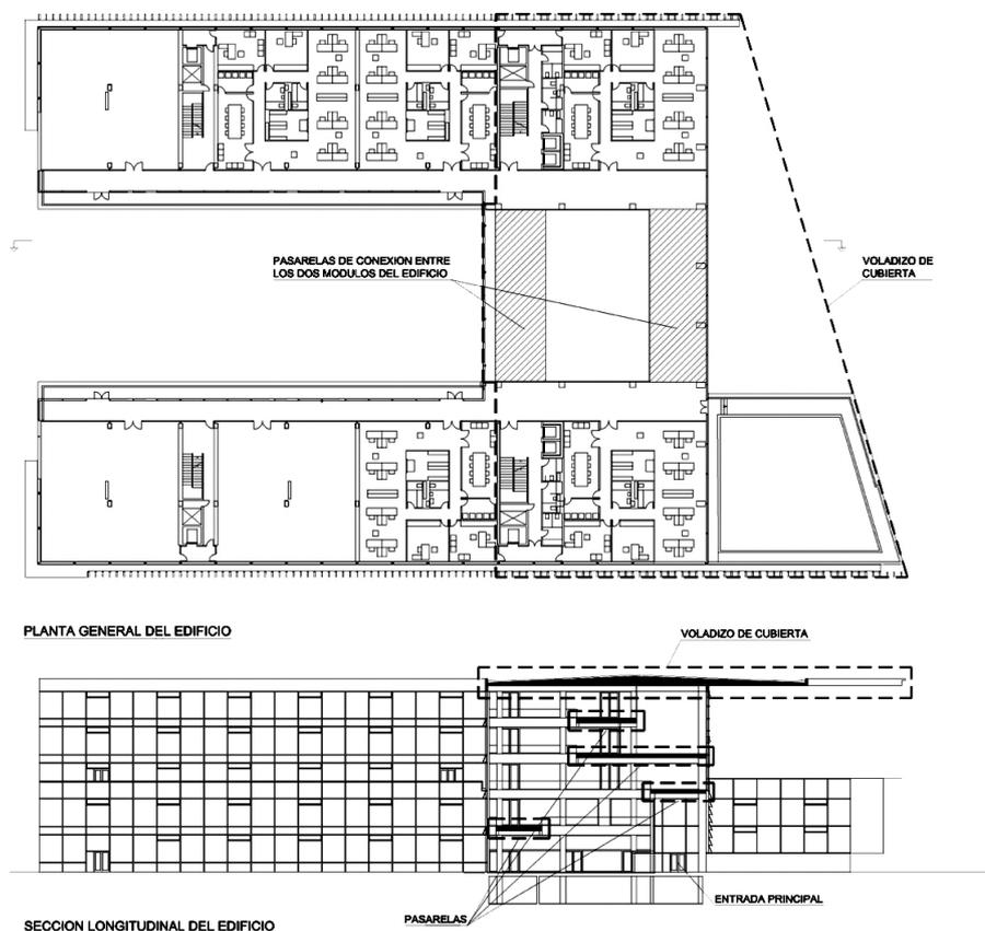
Figura 11. Planta y sección longitudinal del edificio.
