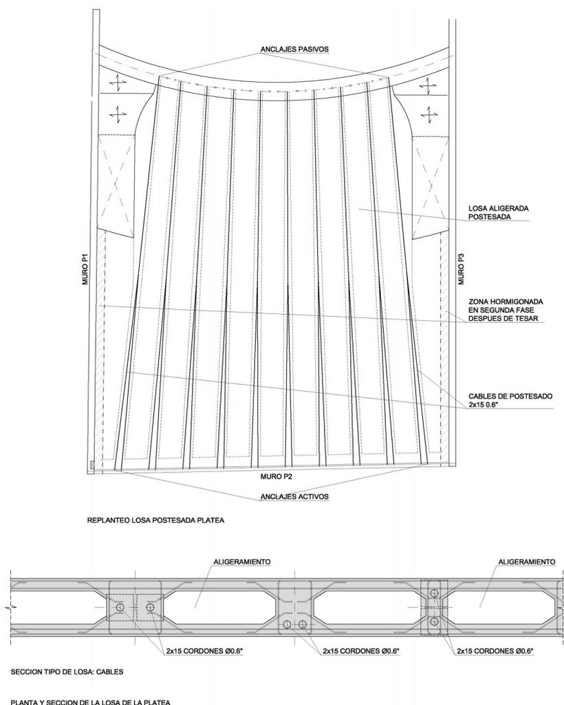
Figura 4. Planta y sección de la losa de platea.
