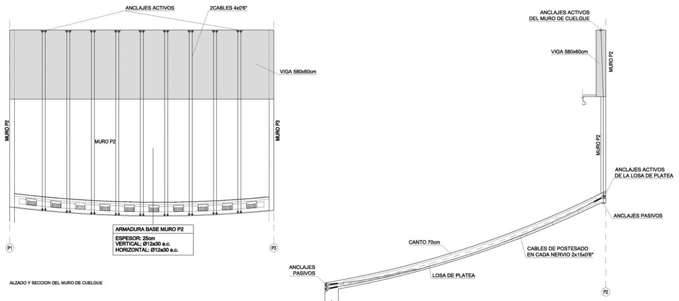
Figura 7. Alzado y sección del muro de cuelgue.
