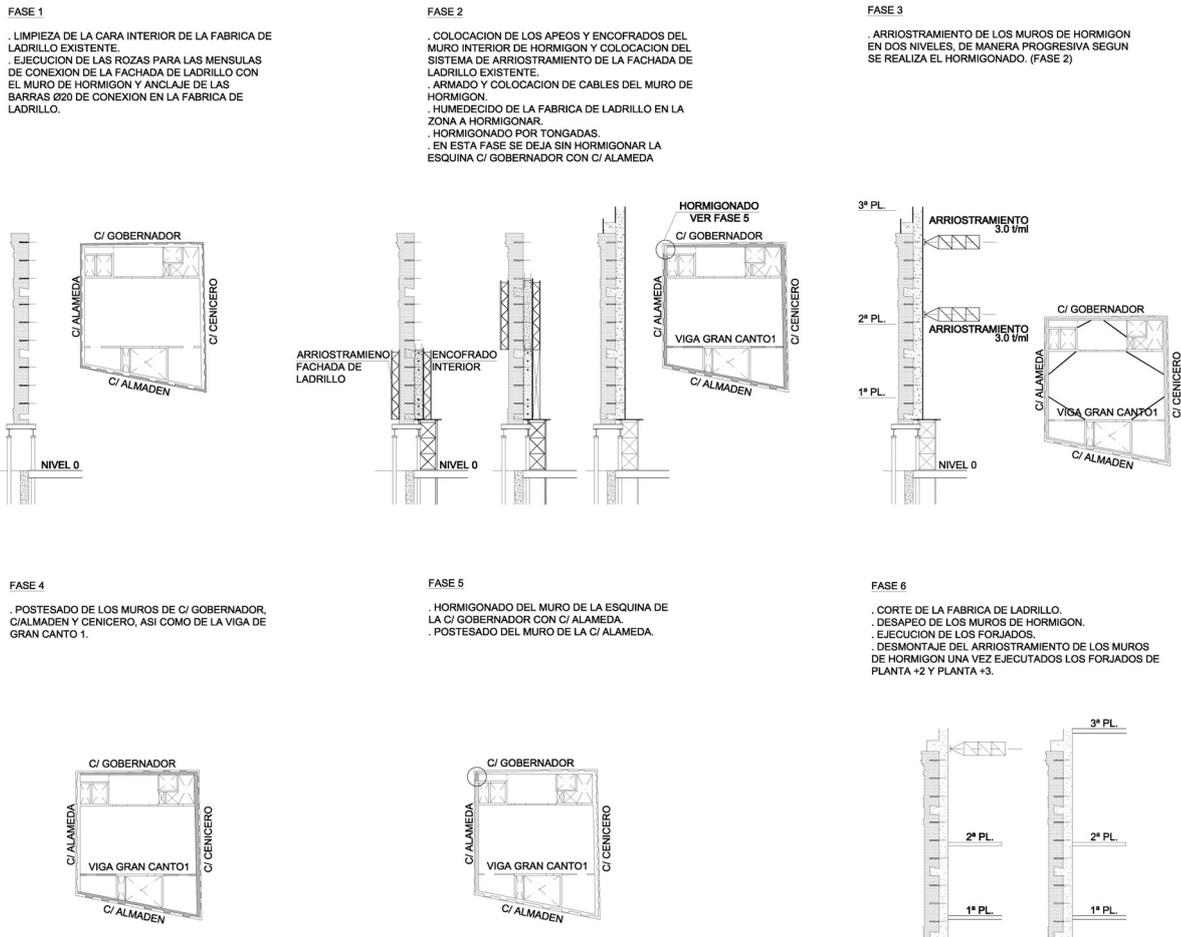
Figura 26. Proceso constructivo del muro perimetral postesado.
