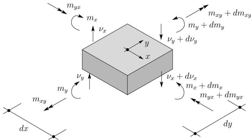
Figura 2. Elemento diferencial de una losa y esfuerzos.
