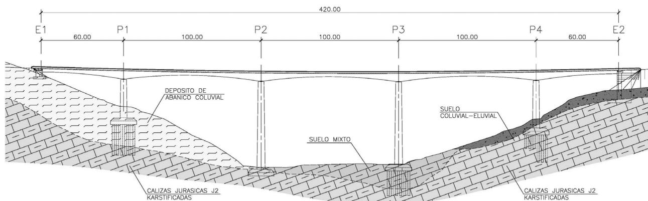
Figura 26. Perfil geotécnico.
