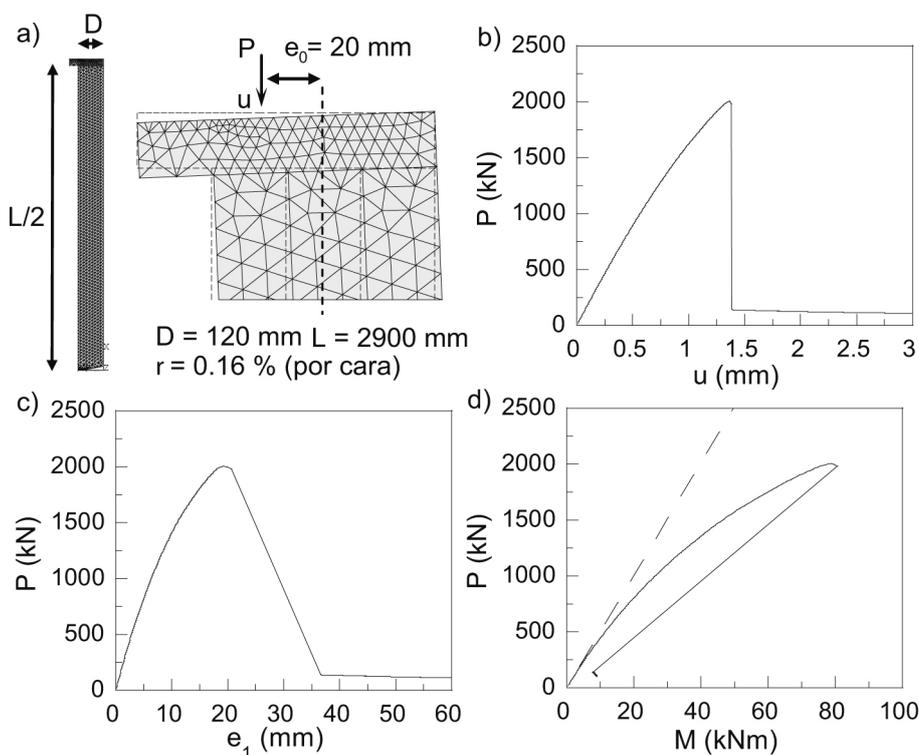
Figura 8. Ejemplo de cálculo: (a) Geometría del panel modelado; (b) Curva carga-desplazamiento en el punto de aplicación de la carga ( $P - u$ ); (c) Curva carga frente a la excentricidad adicional ( $P - e$ ); (d) Diagrama carga-momento ( $P - M$ ).
