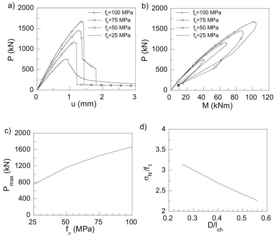
Figura 17. Influencia de la resistencia a compresión: a) Curvas  $P - u$ ; b) Diagramas  $P - M$ ; c) Variación de la carga según la resistencia a compresión; d) Efecto de escala al cambiar las propiedades de material.
