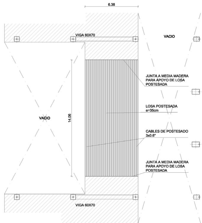
Figura 12. Pasarelas postesadas. Vista exterior y planta.
