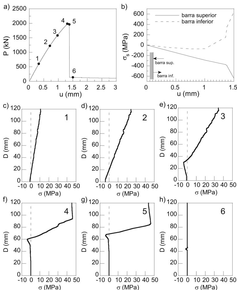
Figura 9. Ejemplo de cálculo: a) Curva  $P - u$ ; b) Tensiones en las barras de acero. Perfil tensional para: c)  $u = 0.35$  mm; d)  $u = 0.75$  mm; e)  $u = 1.00$  mm; f)  $u = 1.36$  mm; g)  $u = 1.38$  mm; h)  $u = 1.50$  mm.
