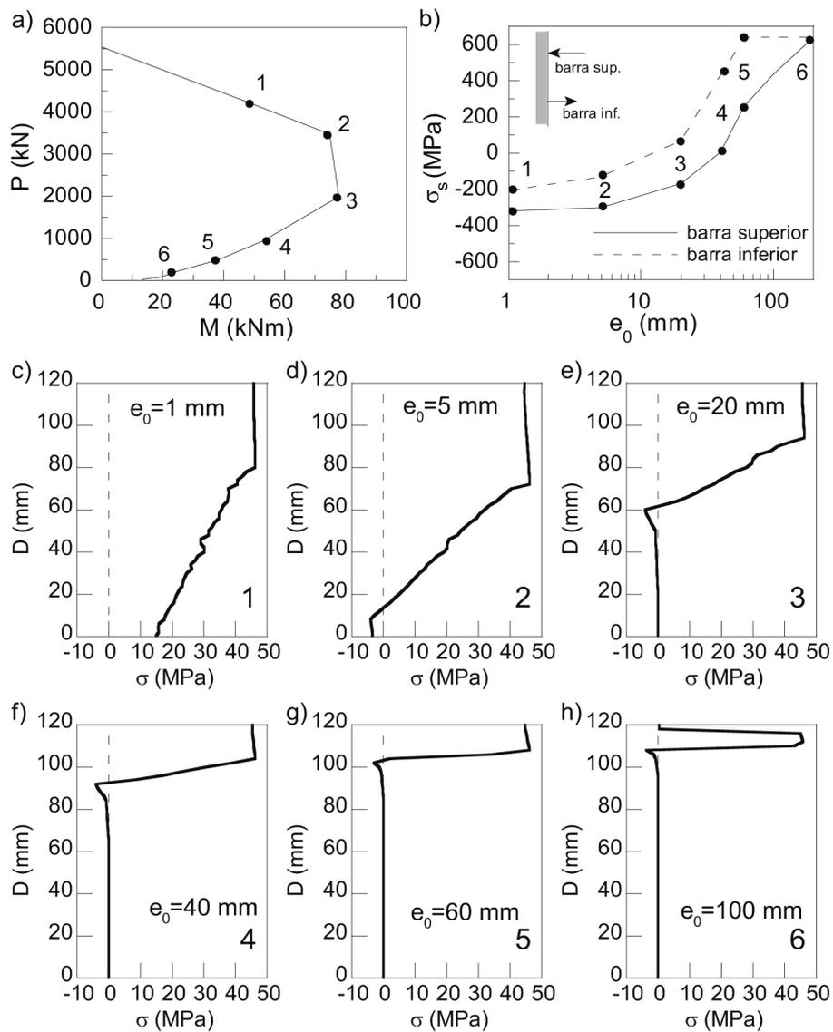
Figura 12. In fluencia de la excentricidad: a) Diagrama de interacción; b) Tensiones en la barras de acero. Perfil tensional para: c)  $e_0 = 1$  mm; d)  $e_0 = 5$  mm; e)  $e_0 = 20$  mm; f)  $e_0 = 40$  mm; g)  $e_0 = 60$  mm; h)  $e_0 = 100$  mm.
