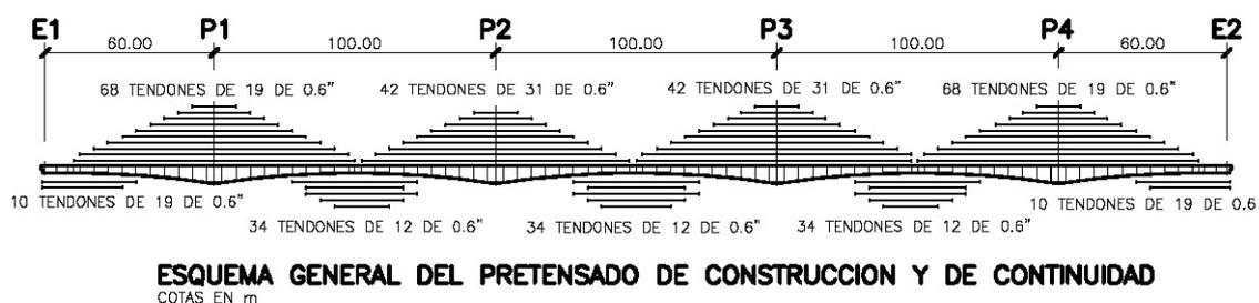
Figura 3. Pretensado longitudinal.
