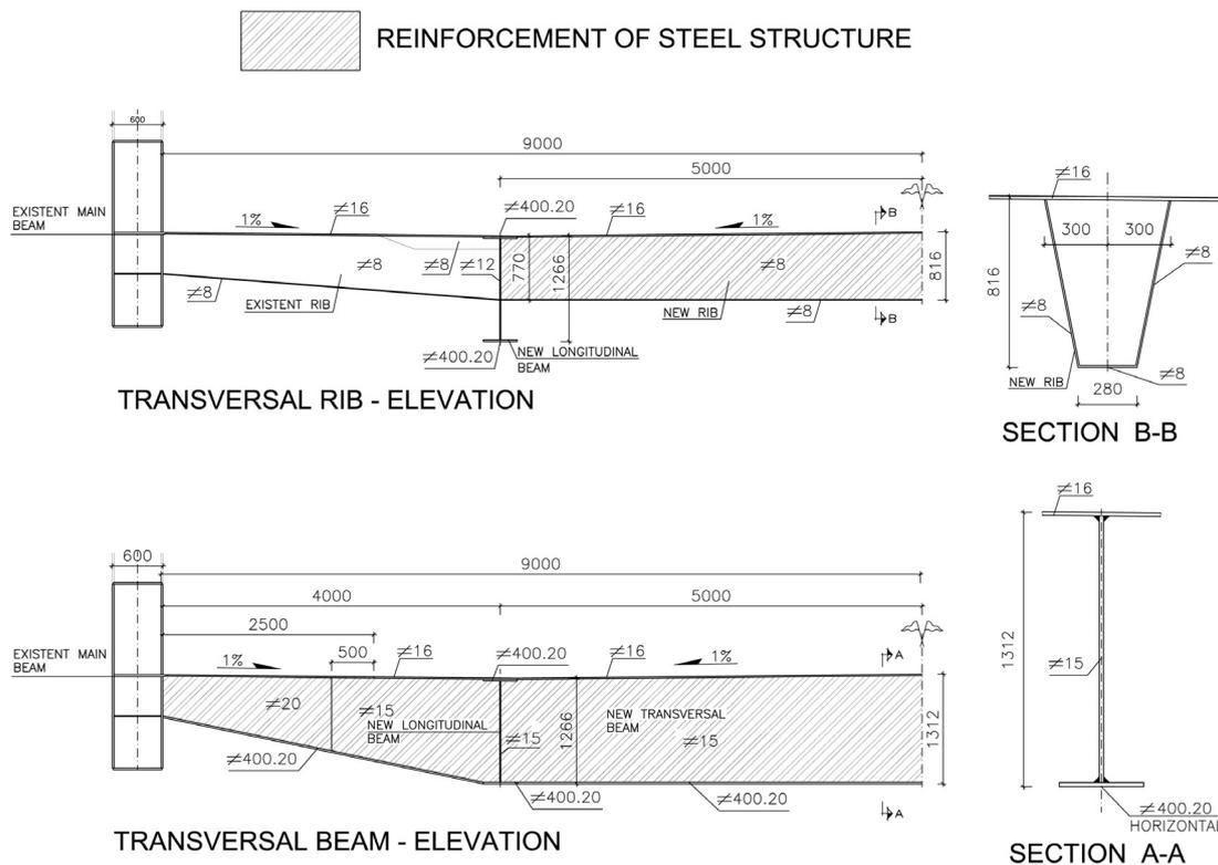
Figura 5. Vigas y nervios transversales.
