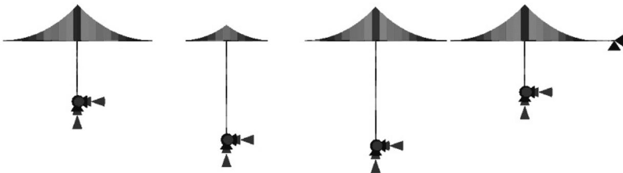
Figura 19. Modelo de cálculo 2D. Momentos flectores tras el fin de la construcción de la T de la pila 2.
