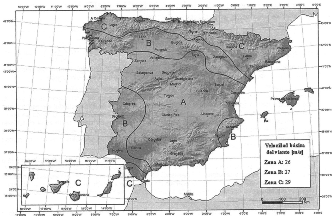
Figura 6. Figura D.1. del CTE-2006 [4] con el valor básico de la velocidad del viento v_b .
