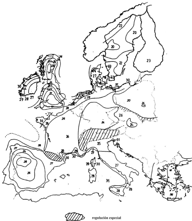
Figura 5. Fig. 7.2 de la UNE-ENV1991-2-4.1995 [2] con valores indicativos de la velocidad básica del viento v_{ref,0} .
