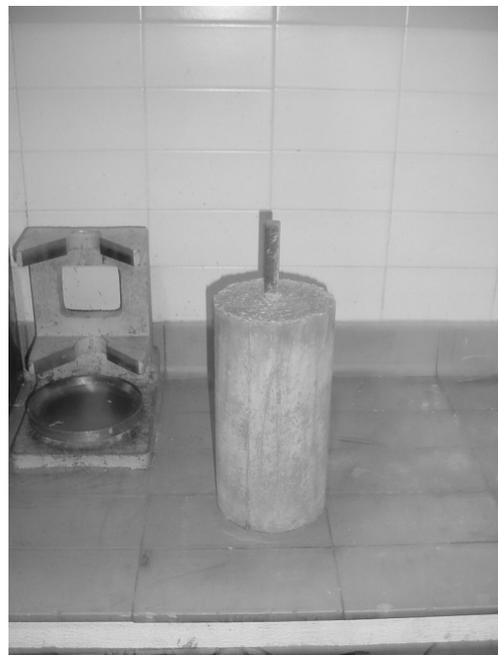
Figura 8.- Probeta mixta acero-hormigón
