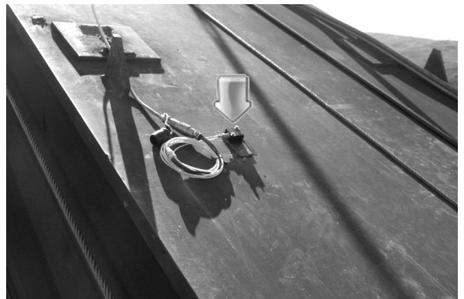
Figuras 6 y 7. Anemómetro-veleta y acelerómetro (este último trasladado posteriormente al interior del arco).
