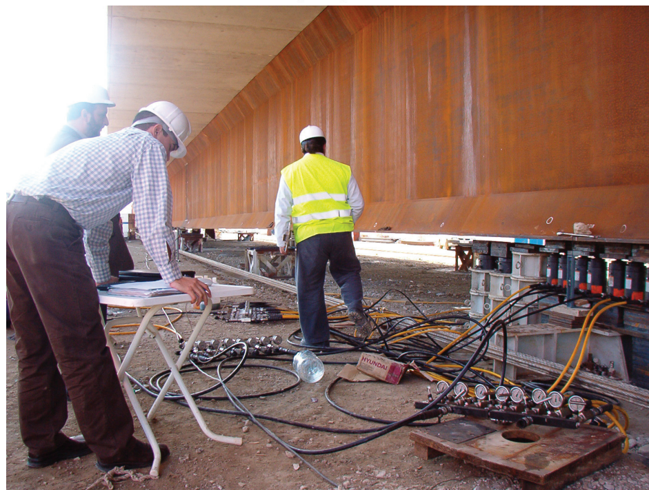
Fig. 28. Medida de la rigidez transversal. Fig. 28. Measuring cross stiffness.
