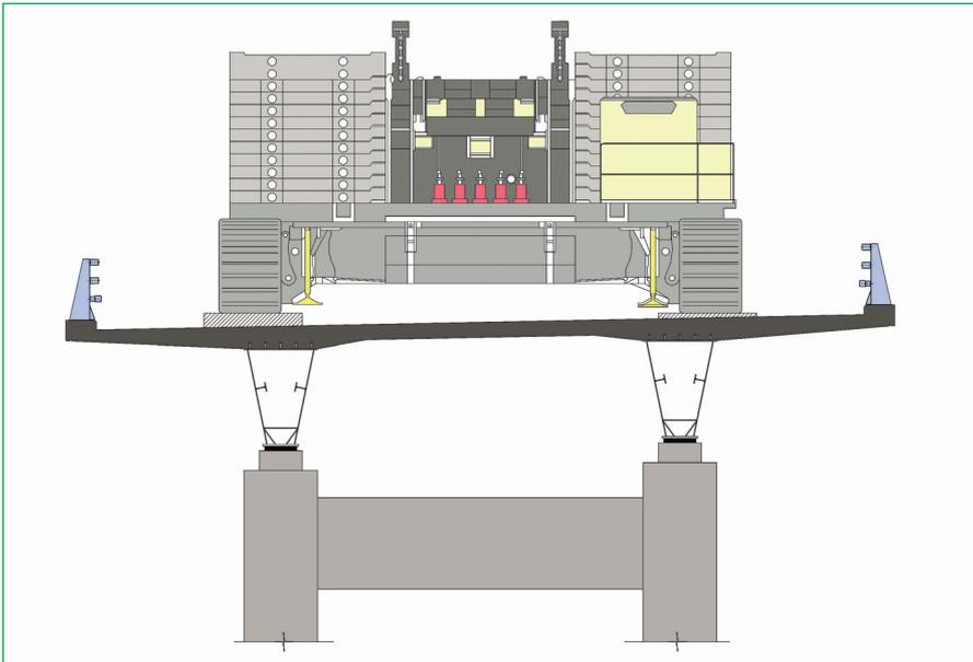
Figura 5. Grúa sobre tablero. Sección.
