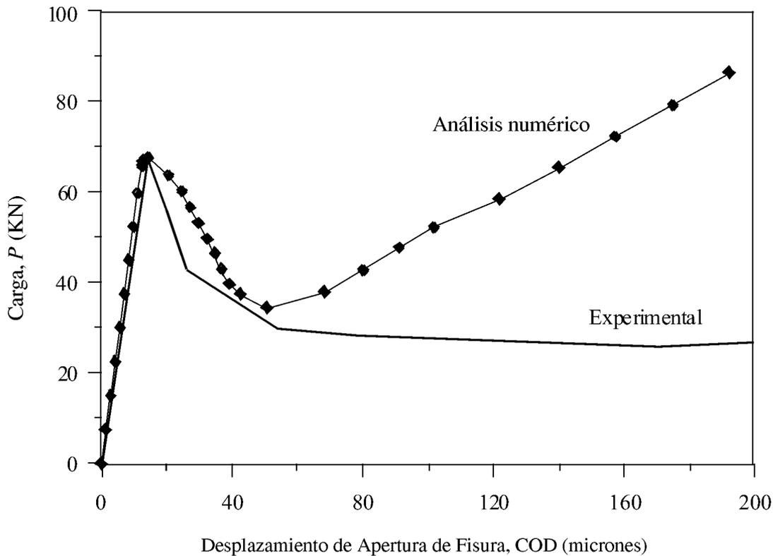
Figura 4. Contrastación de los resultados del análisis numérico con los correspondientes al ensayo de laboratorio.
