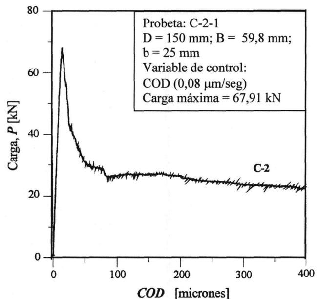
Figura 2. Curva Carga-COD registrada durante un ensayo.
