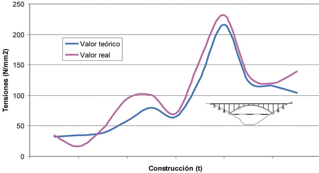
Figura 43. Evolución de tensiones en sección de riñones, durante las maniobras de montaje del tablero sobre arco.
