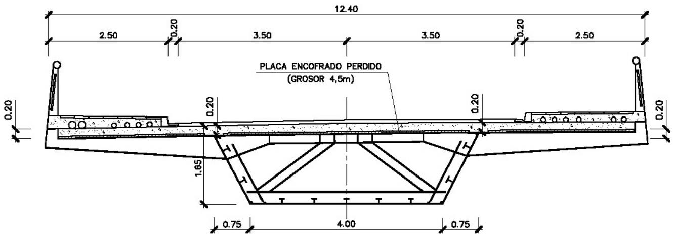
Figura 3. Sección transversal.
