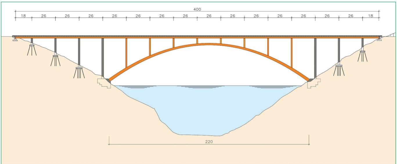
Figura 2. Alzado. Dimensiones generales.
