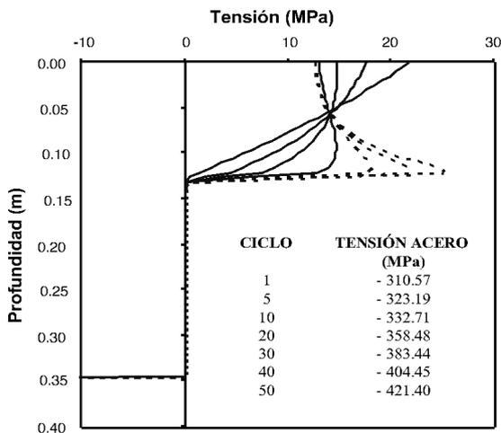
Caso  $M_{min} = 0.7 M_{max}$ . Sección bajo carga máxima
