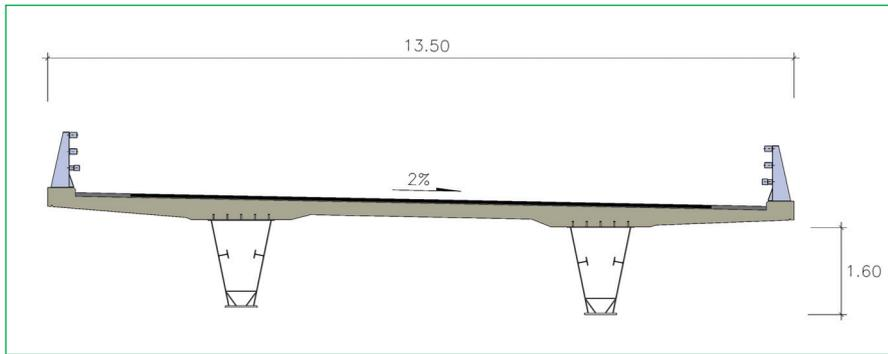
Figura 3. Tablero. Sección.
