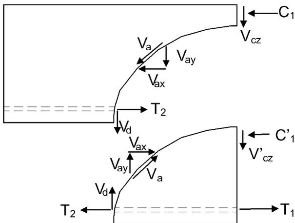
Figura 1. Mecanismos resistentes en una viga sin armadura a cortante.
