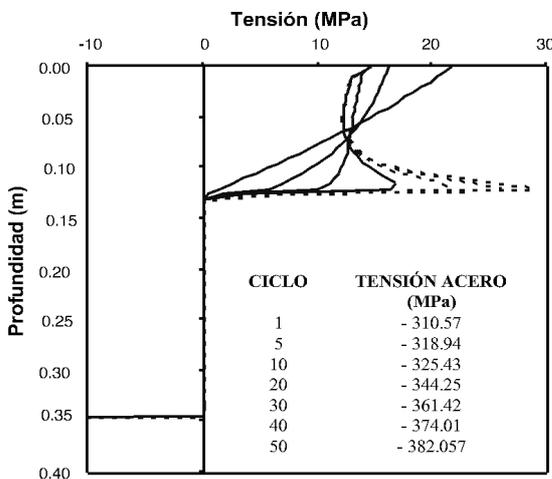
Caso  $M_{min} = 0.3 M_{max}$ . Sección bajo carga máxima
