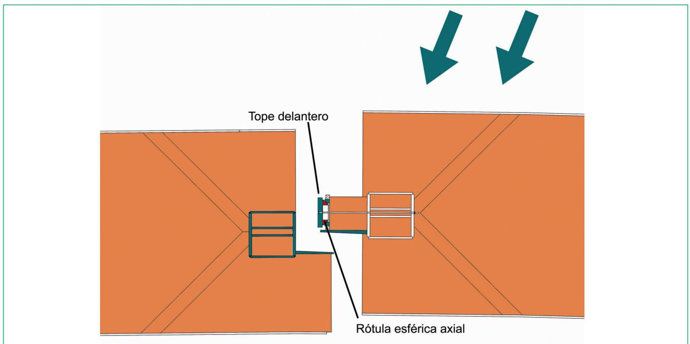
Figura 53. Sistema de enclavamiento automático en zona de clave. Esquema 2.
