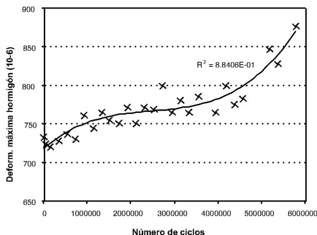
Figura 17. Deformación máxima medida en el hormigón.
