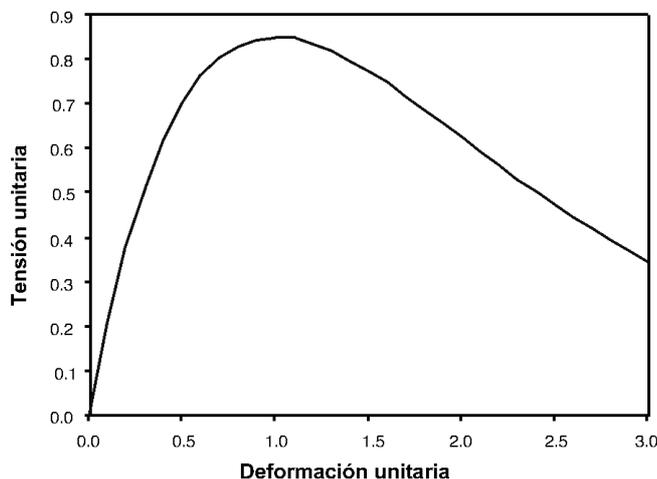
Figura 1. Envolvente de rotura de Karsan y Jirsa.
