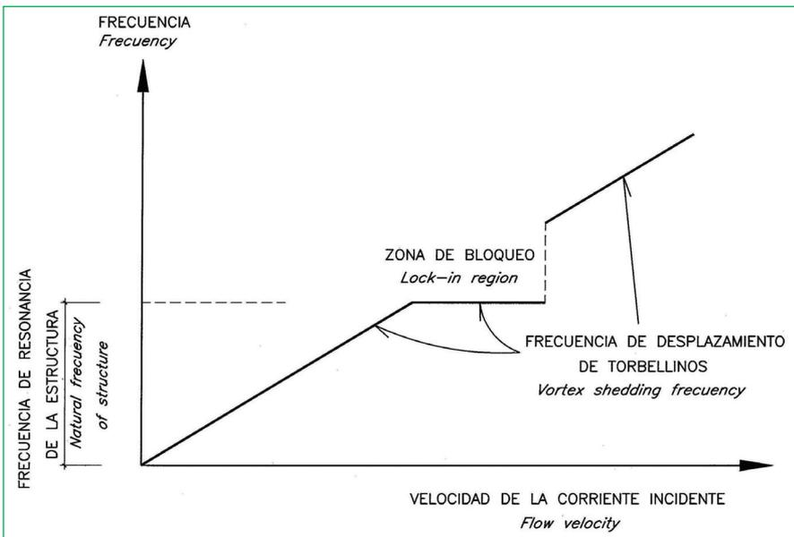
Figura 57. Gráfico frecuencia – Velocidad de la corriente incidente. Zona de bloqueo.
