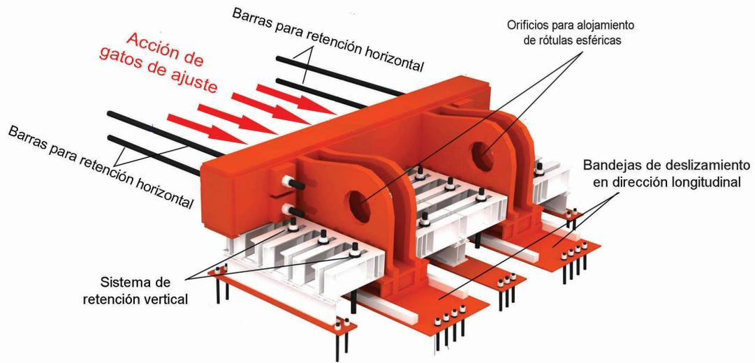
Figura 49. Zona inferior del arco. Esquema.
