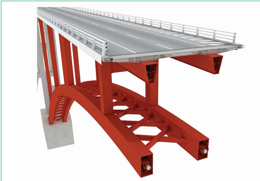
Figura 7. Esquema del conjunto formado por arco, pilas metálicas y tablero.
