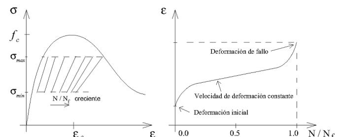
Figura 5. Curvas clásicas en la fatiga del hormigón.
