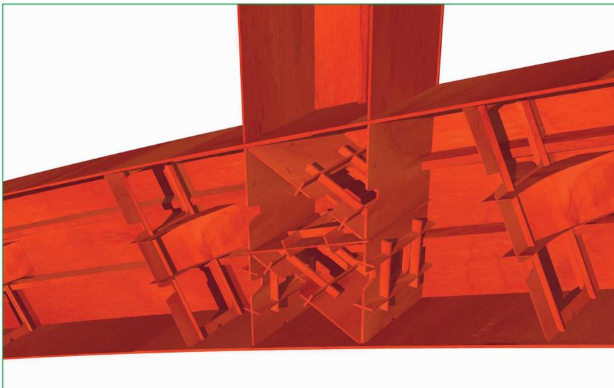
Figura 8. Interior de la pieza de arco con sección en cajón.
