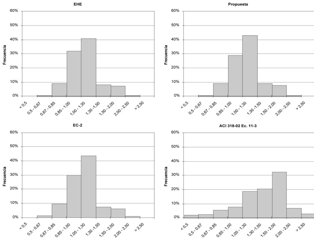
Figura 8. Vigas armadas sin armadura a cortante. Base de datos de Reineck et al. [17].
