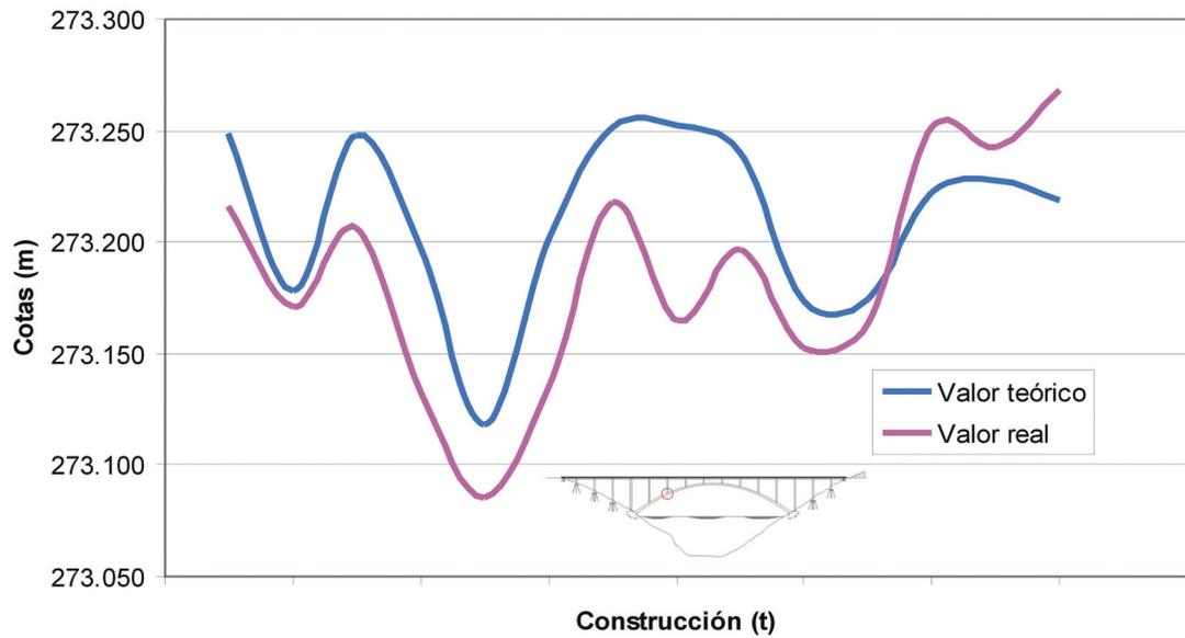
Figura 44. Evolución de flechas en sección de riñones, durante las maniobras de montaje del tablero sobre arco.
