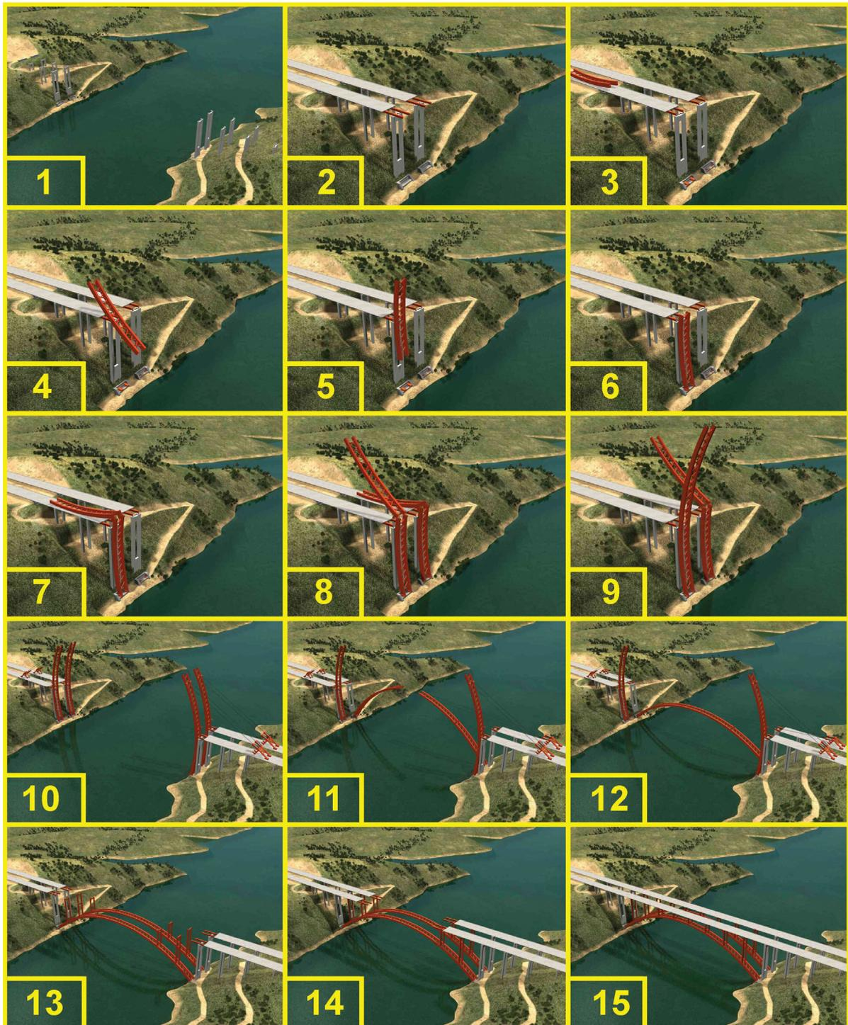
Figura 13. Fases del proceso constructivo.
