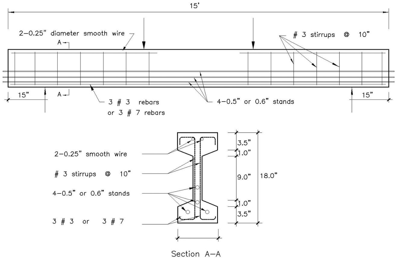
Figura 12. Viga de hormigón pretensado con armadura a cortante ensayada por Elzanaty et al. [18].
