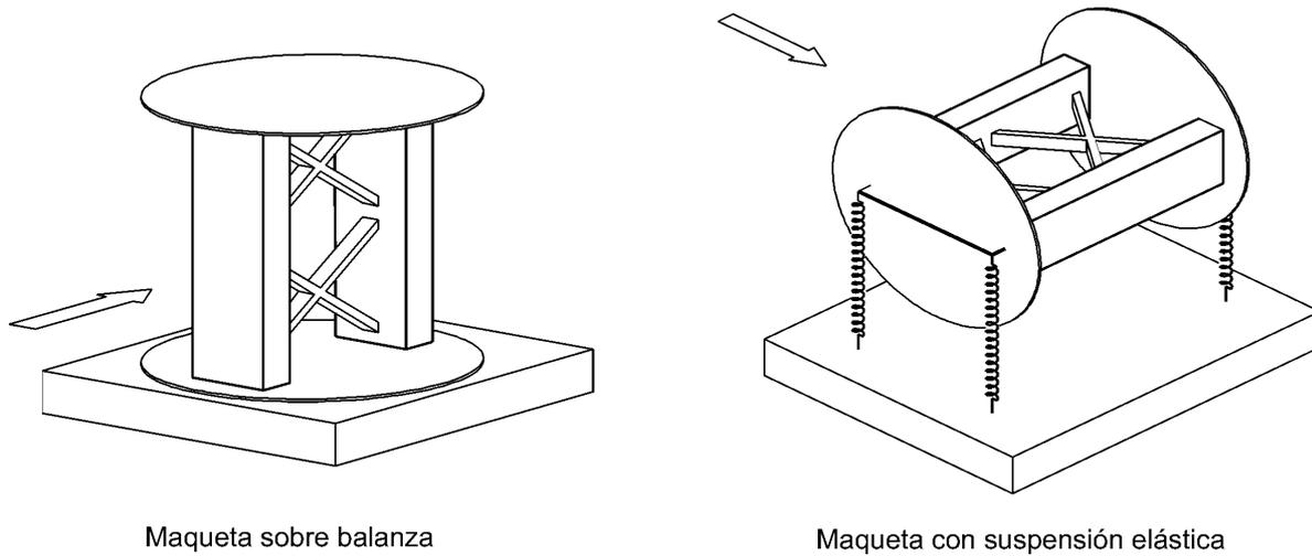
Figura 6. Montaje de los ensayos aerodinámicos.
