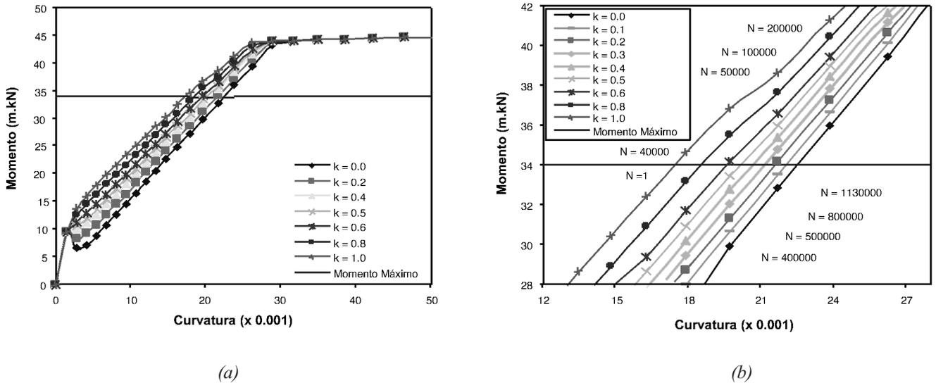
Figura 20. diagrama momento-curvatura para diferentes valores de tensión-stiffening.
