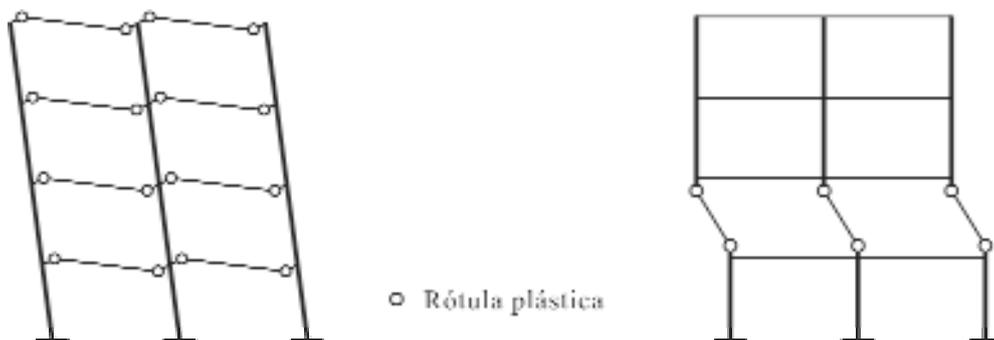
Figura 14. Mecanismos de colapso alternativos en una estructura porticada.
