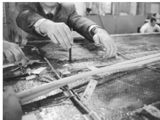
Figura 14. Desgarro del CFRP en apoyo intermedio. Ensayo VHA1-b.
