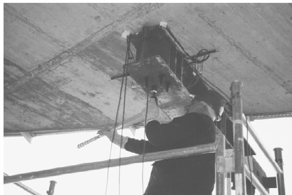
Figura 15. Ensayo de calibración de las uniones pretensadas, instrumentando los T.A.R.
