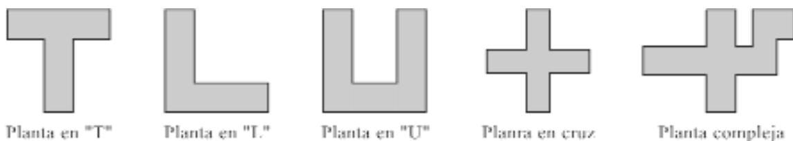
Figura 19. Factores de incertidumbre en el comportamiento sísmico de las estructuras de edificación.
