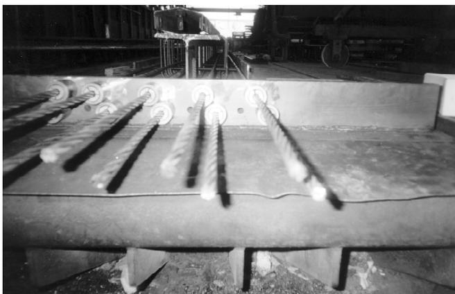
Foto 30. Cables de pretensado. Armaduras activas,
