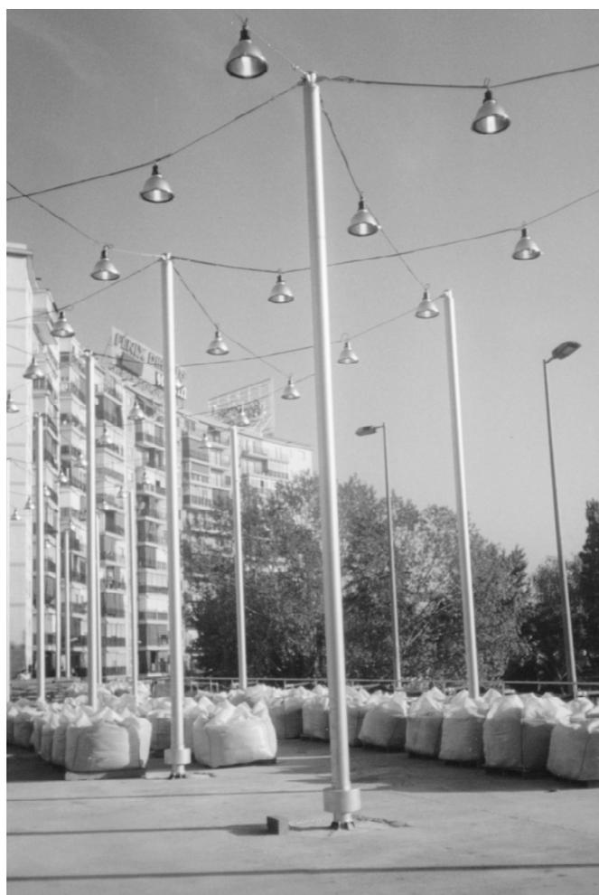
Foto 21. Prueba de carga in situ.
