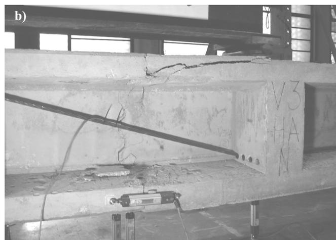
Figura 20. Ensayo V3-HA. Fase de prerrotura (a) y viga descargada (b).
