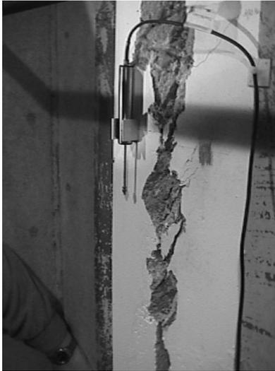
Figura 11. PC-JC. Estado en el que quedó la junta tras la rotura.
