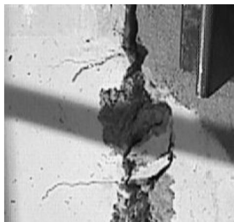
Figura 9. Detalle de la rotura de una llave PC-C.
