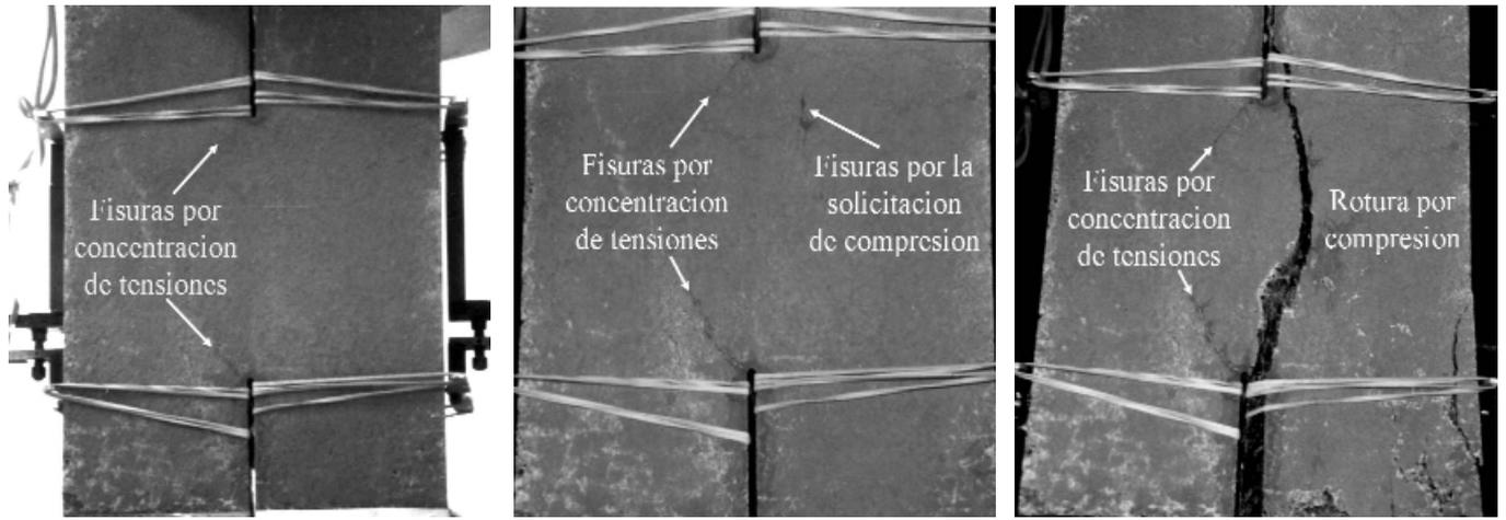
Figura 8. Secuencia de tres fotos de la cara espolvoreada con fluoresceína durante el ensayo de una probeta de hormigón: a) aparición de las fisuras a partir de la punta de las entallas, b) aparición de las fisuras de compresión, c) colapso y estado final de la probeta.
