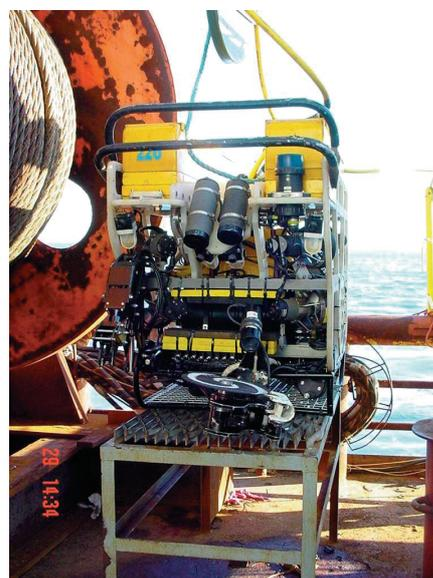
Figura 5.2.10. Vista del robot submarino utilizado para el control de la hinca de los pilotes.
