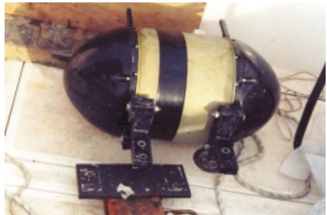
Figura 7.3.4. Cabeza sensora de la ecosonda SEABAT 8101.
