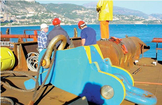
Fig. 5.2.11. Vista del equipo Stevensionner para control de la puesta en tensión de las cadenas.
