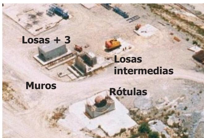
Figura 6.5.6. Ensayos escala 1:1
