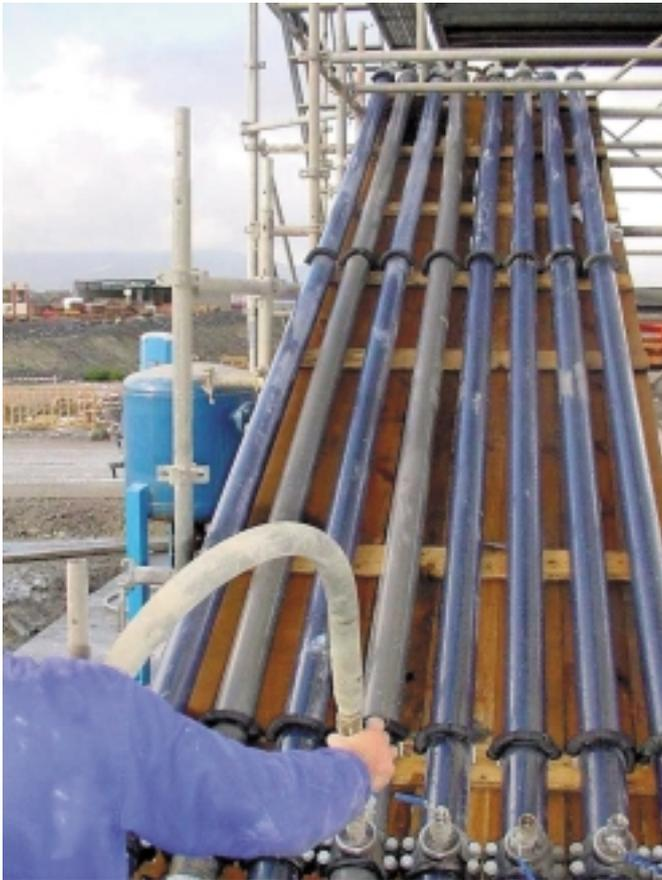
Figura 4.5. Ensayos de tubo inclinado.
