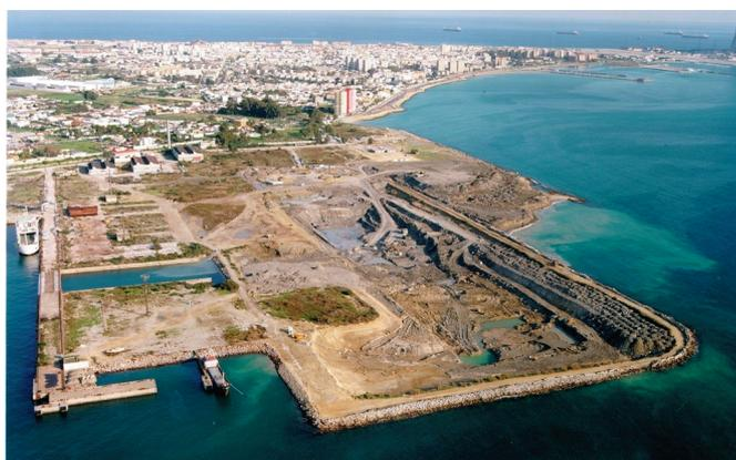
Figura 6.1.3. Excavación de la dársena.
