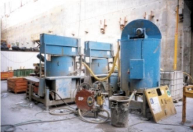
Figura 4.10. Equipo de inyección.
