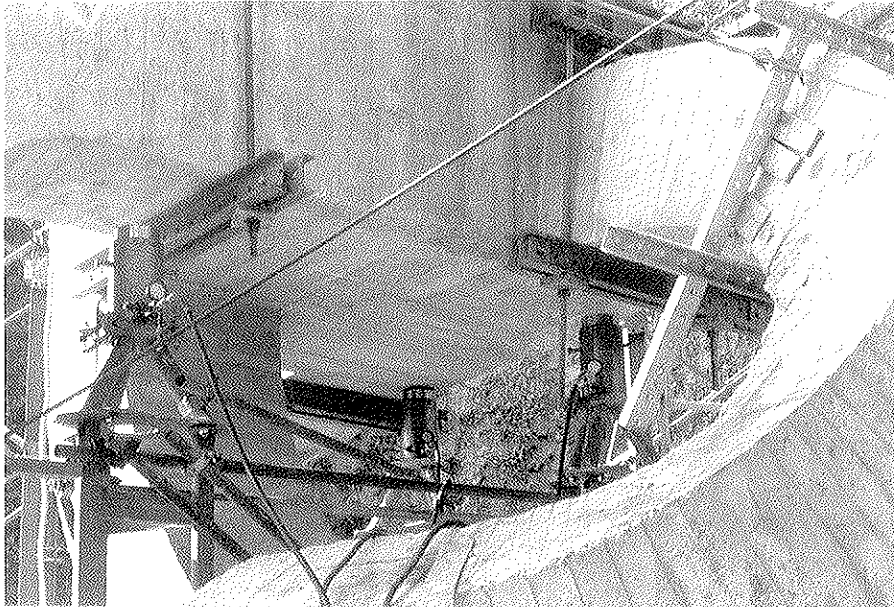
Fig. 11.- Detalle de los gatos hidráulicos para determinación del c.d.g.
