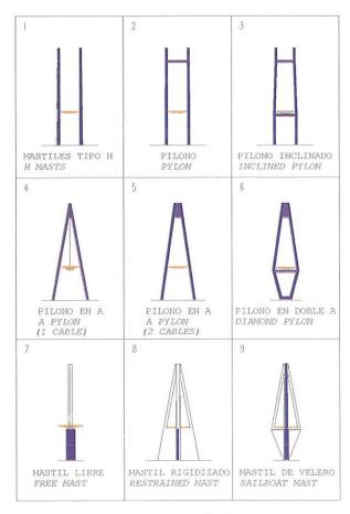
Figura 4. Tipos de pila. Figure 4. Tower types.
