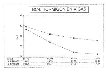
Figura 3. Edificio bajo, luz corta y canto 24 cm (BC4)
