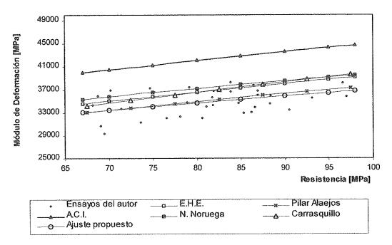
Figura 3. Relación entre el módulo de deformación y la resistencia a compresión.
