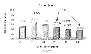
Figura 7. Resistencia a compresión apra cada Granulometría. Entre paréntesis: Relación Árido Gureso / Árido Fino.
