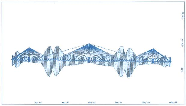
Figura 14. Modelo estructural. Envolvente de momentos flectores en las vigas longitudinales debidos a cargas muerta y viva. Figure 14. Computer model. Bending moment envelope due to dead and live loads for the longitudinal girders.
