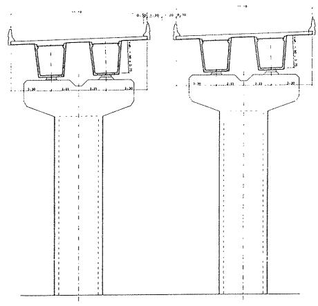
Fig. 2.- Sección transversal por pila.
