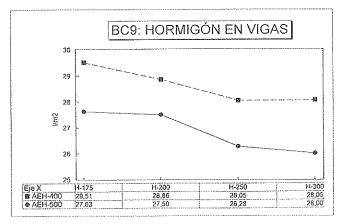
Figura 5. Edificio bajo, luz corta y canto 29 cm (BC9)
