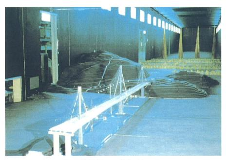
Figura 15. Modelo aeroelástico del puente. Figure 5. Full aeroelastic model of the bridge.
