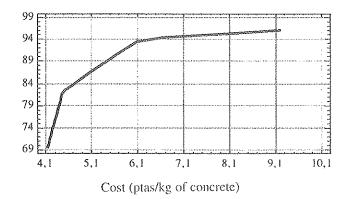
Gráfico 5. Coste mínimo para una resistencia a compresión fijada
