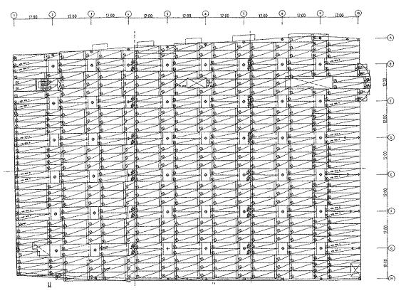
Figura 9. Mallas electrosoldadas. Disposición de las distintas mallas en la placa del primer nivel.
