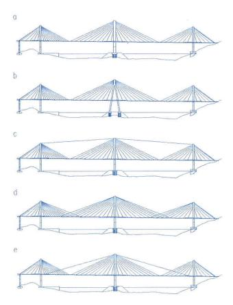
Figura 8. Alternativas para estabilización del mástil central. Figure 8. Alternatives for stabilising the central mast.
