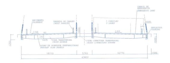
Figura 12. Sección transversal típica del tablero. Figure 1. Typical cross section of deck.
