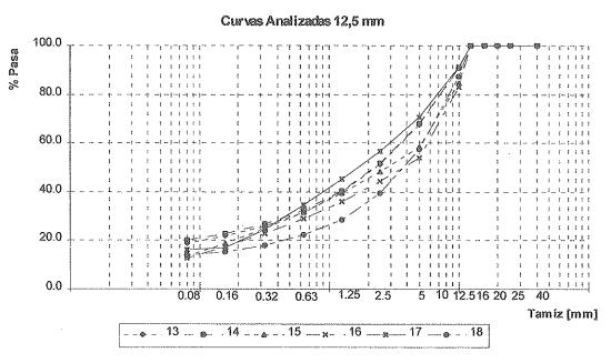
Figura 1. Curvas granulométricas analizadas para tamaño máximo de árido de 12,5 mm.
