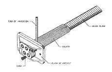
Figura 2. Características del sistema de pretensado utilizado.
