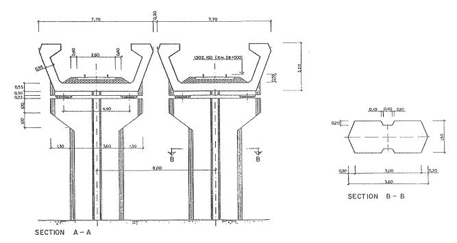
Figura 2. Tableros y pilas. Secciones.
