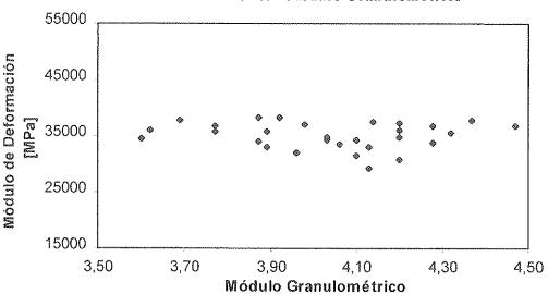
Figura 4. Relación entre el módulo de deformación y el módulo granulométrico.
