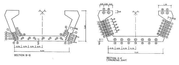
Figura 6. Tablero. Pretensado.
