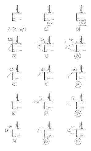
Figura 16. Deflectores ensayados, con indicaciones de la velocidad crítica para -2.5°. Figure 5. Fairings tested, with critical speeds for -2.5° shown.
