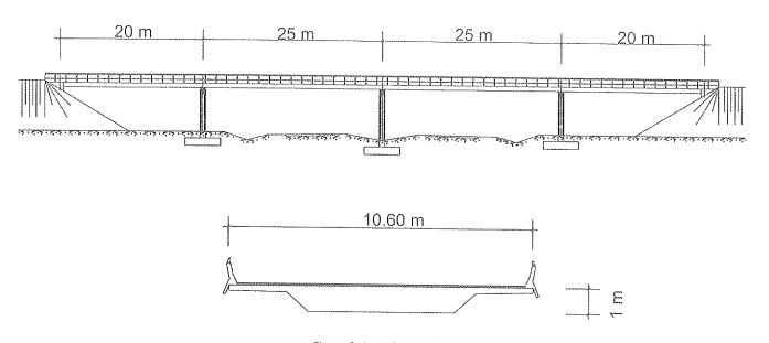
Figura 2. Losa Pretensada.
