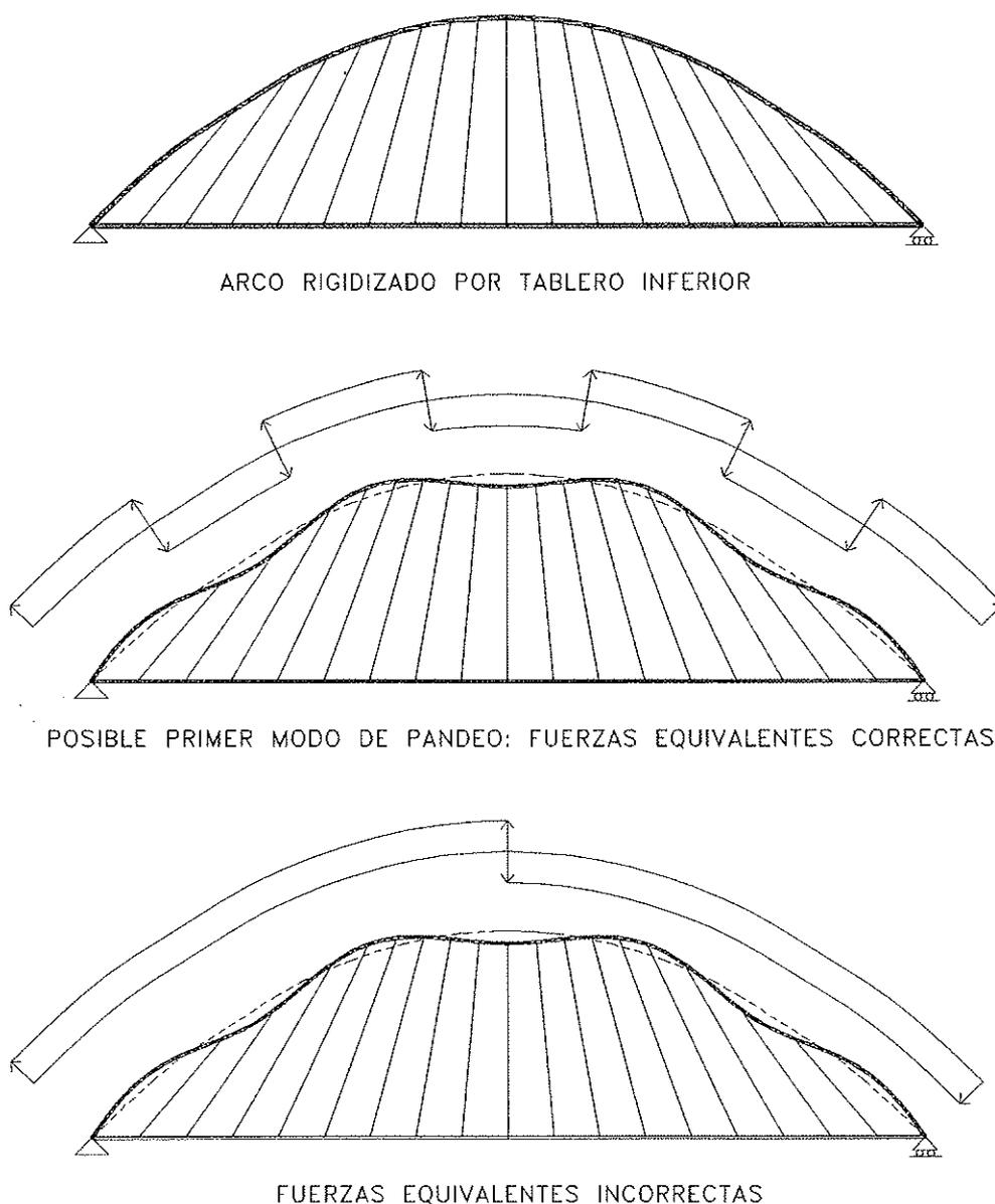
Figura 12. Análisis geoméricamente no lineal con imperfecciones.
