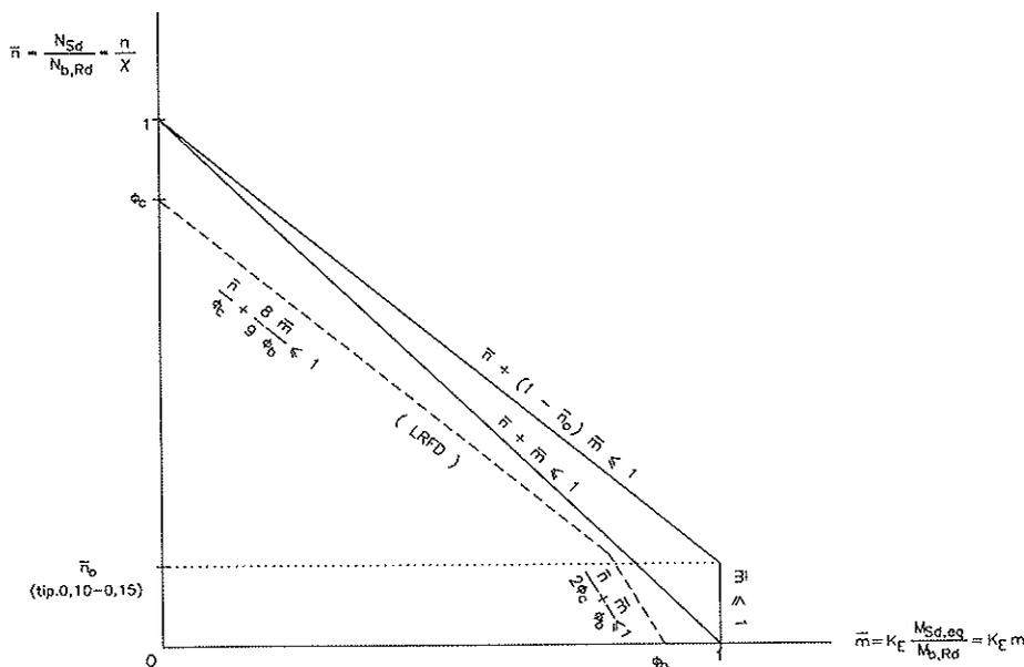
Figura 3. Diagramas teóricos de interacción en flexión compuesta.
