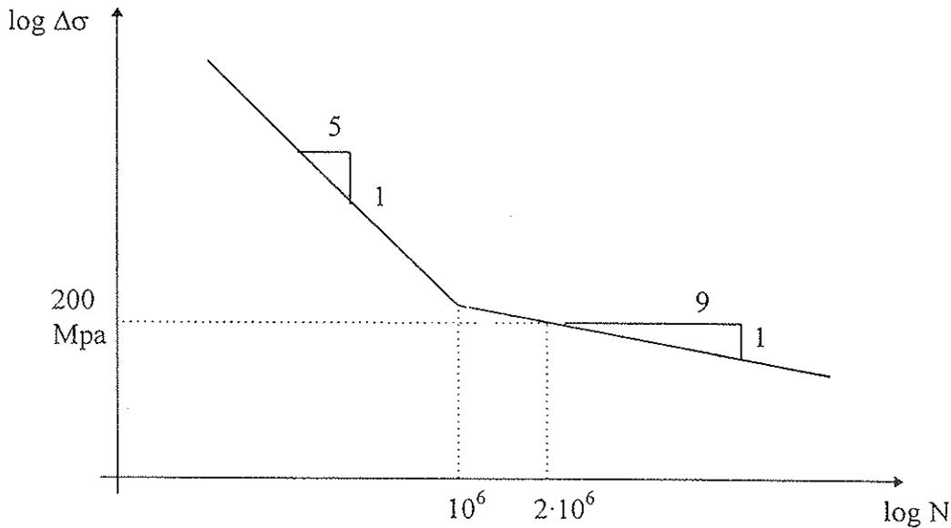
Fig. 9. Definición de la curva S-N característica utilizada en la verificación a fatiga de los tirantes.
