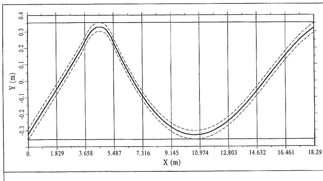
Fig. 5. Trazado, interior a la rosca, de la línea de empujes correspondiente al mecanismo de colapso del arco.
