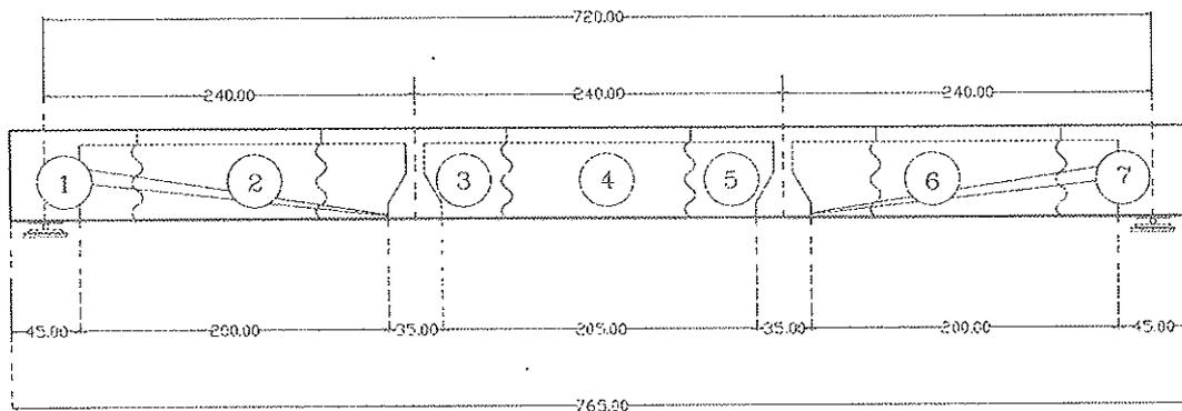
Fig. 3. Definición geométrica de las vigas de dovelas.
