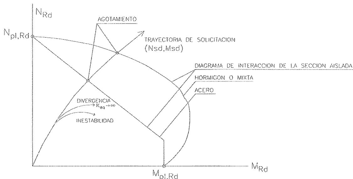
Figura 11. Comprobación de la sección crítica de la pieza
