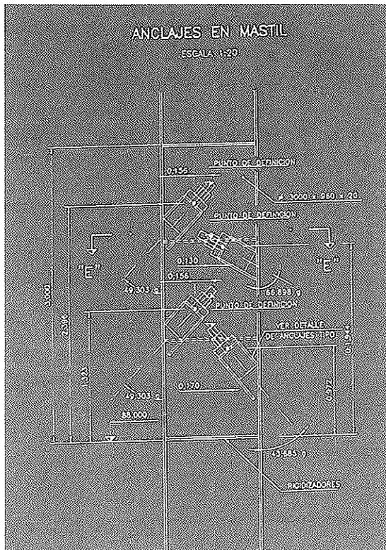
Fig. 6. Detalle de anclajes de tirantes al mástil.
