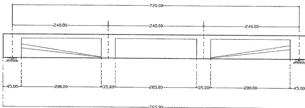
Fig. 1. Definición geométrica de las vigas monolíticas ensayadas.
