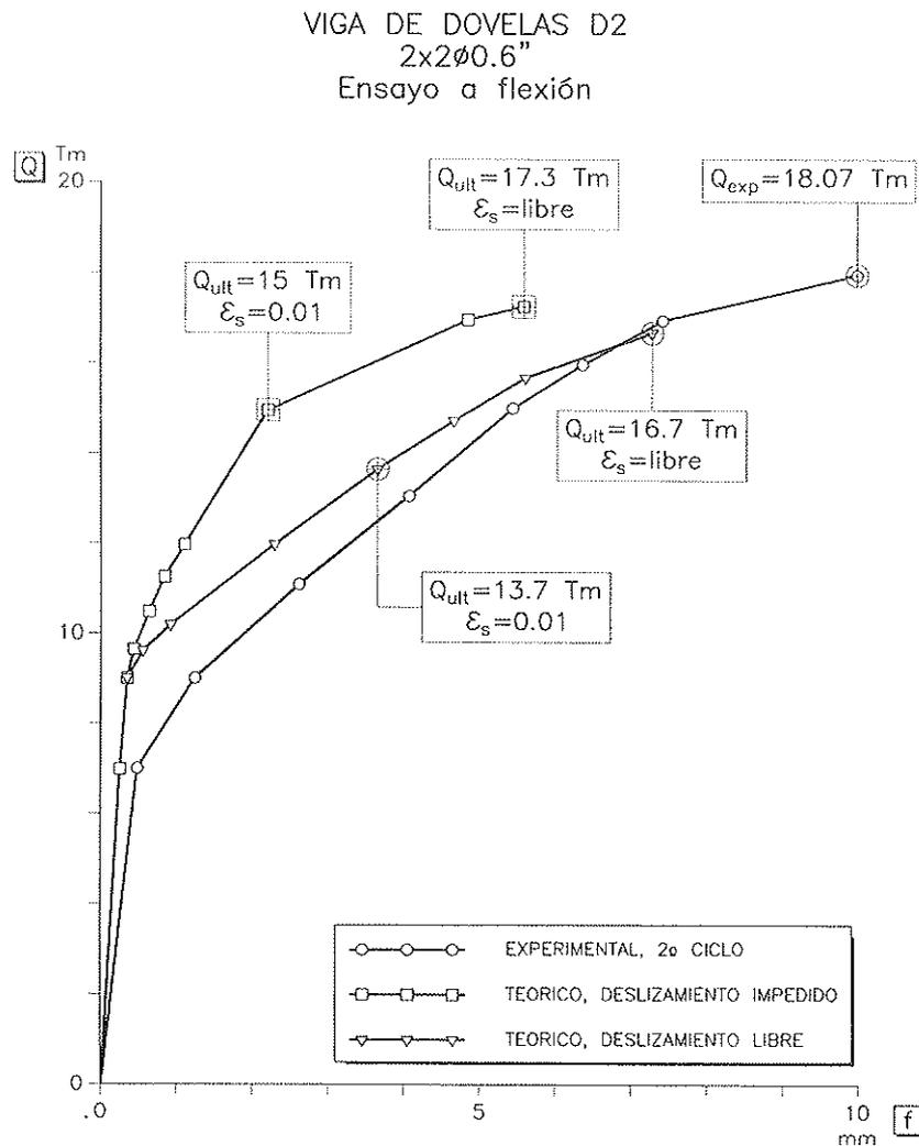
Fig. 16. Curvas cargas-flechas teóricas y experimentales obtenidas para la viga de dovelas D2.
