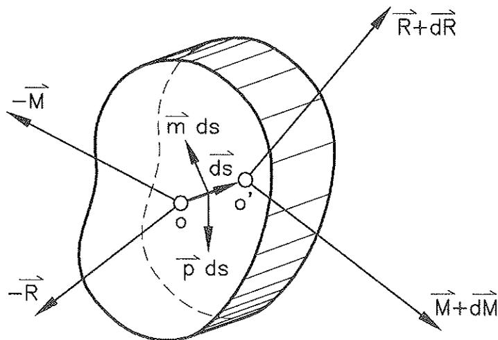
Fig. 1. Fuerzas sobre una sección transversal de espesor diferencial.
