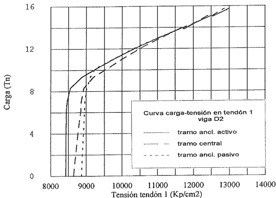
Fig. 9. Curvas cargas-incremento de tensión en el acero de pretensado en uno de los cordones instrumentados de la viga D2. Nótese la diferencia de incremento de tensión de cada tramo de tendón y cómo se igualan las tensiones en rotura debido al deslizamiento en desviadores (Figura 11).
