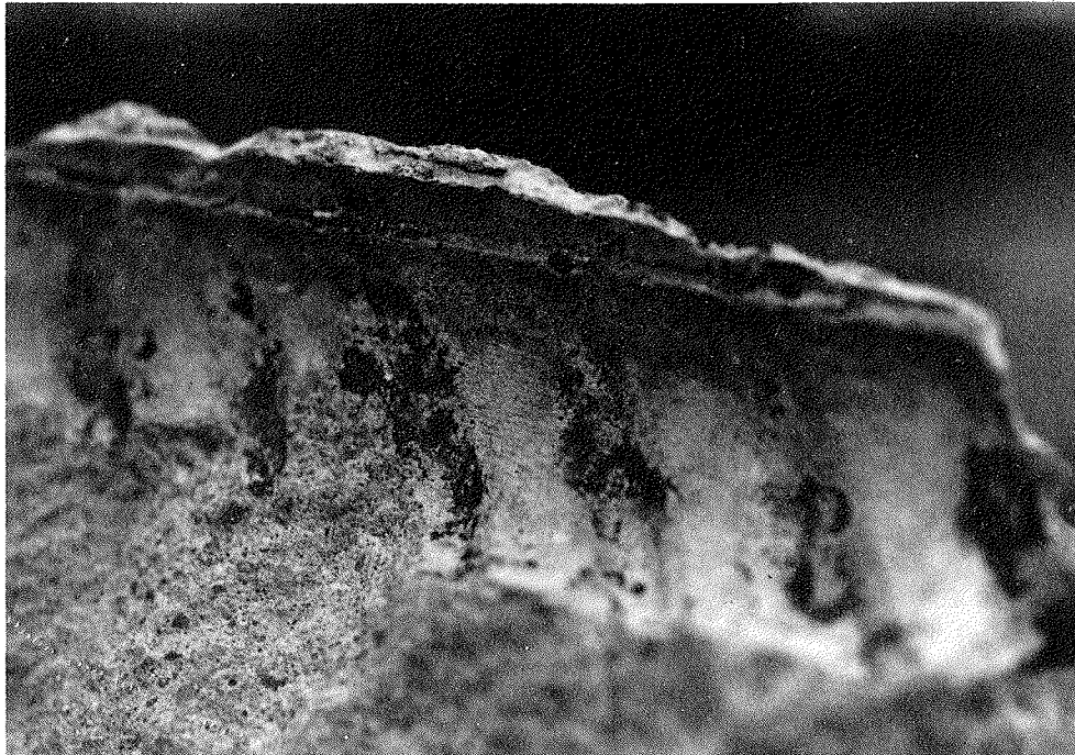
ENSAYOS SOBRE LA INFLUENCIA DE LA OXIDACION Y MANCHAS DE MORTERO EN LA ADHERENCIA DE BARRAS CORRUGADAS
