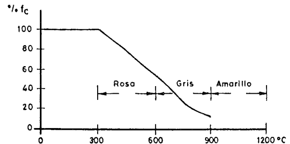
Fig. 3. Cambios de color del hormigón. Según ZOL-DNERS (1960) citado por NEVILLE (1981).
