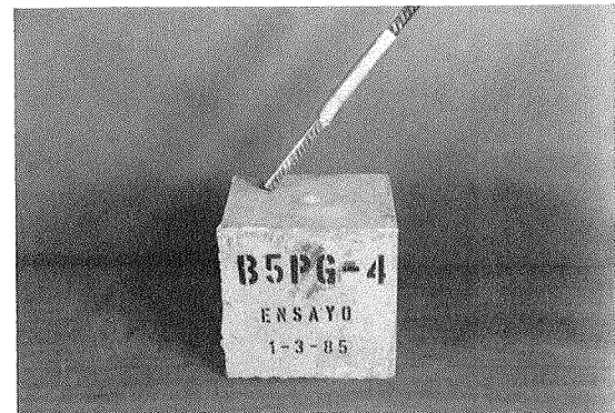
Foto 13. Ensayo de "pull-out". Aspecto de una rotura por adherencia.
