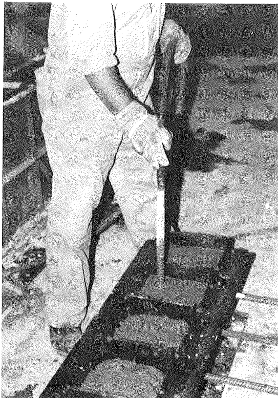
Foto 7. Fabricación de probetas de Pull-out.
