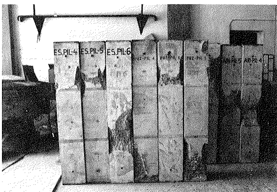
Foto 5. Pilares ensayados a compresión.
