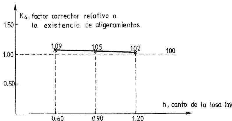
Fig. 26. Factor de corrección  $k_4$ , en función del canto del tablero, relativo a la presencia de aligeramientos, para determinar el rango anual de diseño de la temperatura media en puentes losa aligerada.
