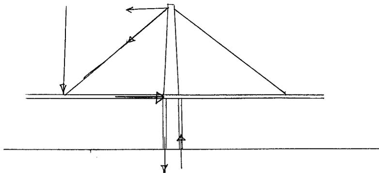
Fig. 41. La falta de cortante en la parte inferior de la pila, permite convertirla en un par de pantallas transversales.
