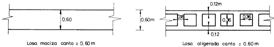
Fig. 14. Secciones losa maciza y losa aligerada analizadas.
