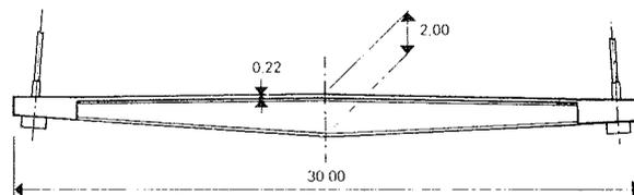
Fig. 39. Propuesta de sección transversal de hormigón, con diafragmas transversales metálicos.
