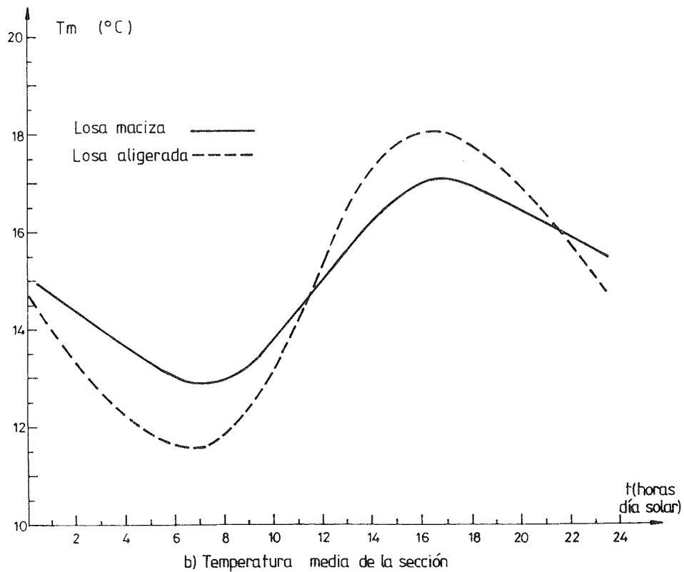
Fig. 16. Evoluciones diarias del gradiente térmico y de la temperatura media para los tableros losa maciza y losa aligerada analizados.
