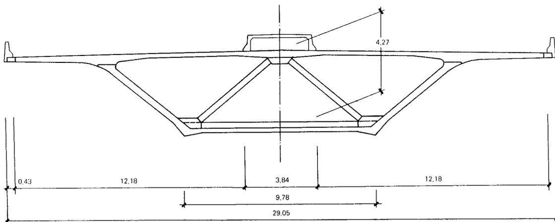
Fig. 30. Sección transversal utilizada en Brotonne ( $L=320$  m) Coatzacoalcos ( $L = 288$  m) y Sunshine Skyway ( $L = 365,76$  m) (representado). Las variaciones entre estas secciones son mínimas. Únicamente, en el último puente citado, el apuntalamiento interior se realiza por parejas de puntales. También se diferencian entre sí en la forma de hormigonado de la sección transversal.
