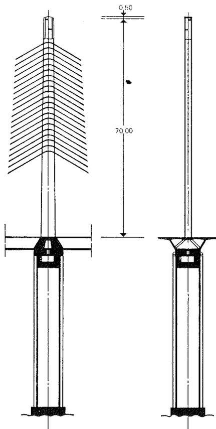
Fig. 44. Puente de Brotonne. Pila principal.
