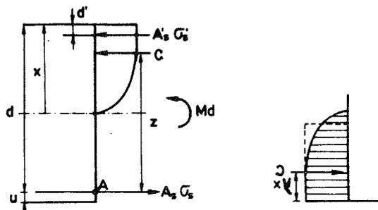
Fig. 2.2. Tensiones y esfuerzos en la sección.
