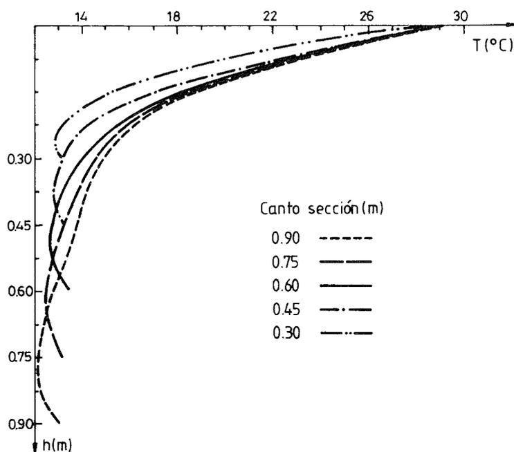
Fig. 11. Distribuciones de temperaturas según el eje de simetría, correspondientes al instante de máximo gradiente térmico, para los diferentes cantos.
