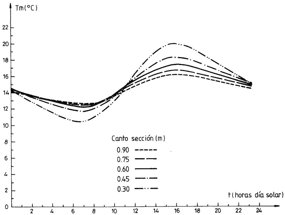
Fig. 12. Evoluciones diarias del gradiente térmico y de la temperatura media, para los diferentes cantos.
