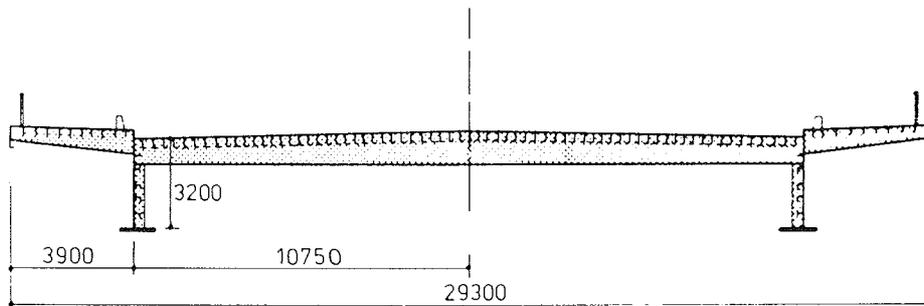
Fig. 20. Sección transversal del Kniebrücke, en Düsseldorf.
