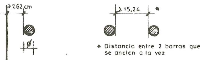
El coeficiente de reducción es 0,8 y actúa simultáneamente con el resto de coeficientes. Sin embargo, no actúa para el caso de barras comprimidas.
