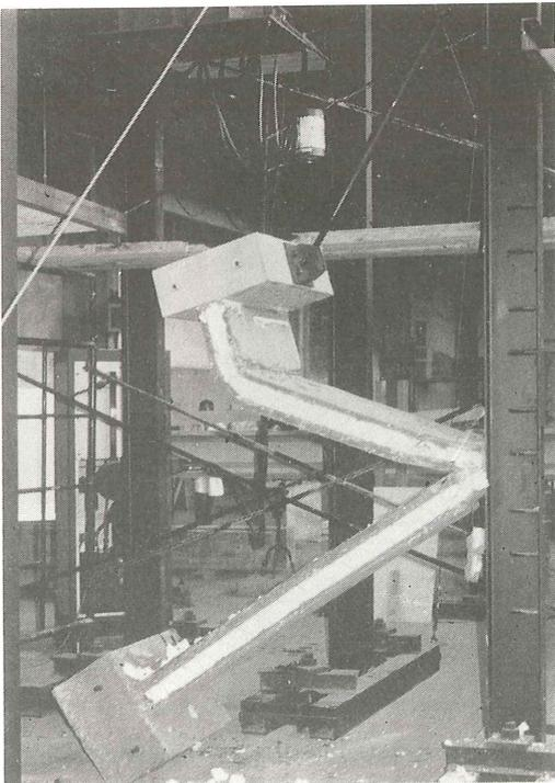
Fig. 15. Aspecto del panel B-2 ( $e = 0,1 h = 1,3$  cm) una vez que se ha producido su agotamiento resistente para  $P_u = 54$  t.
