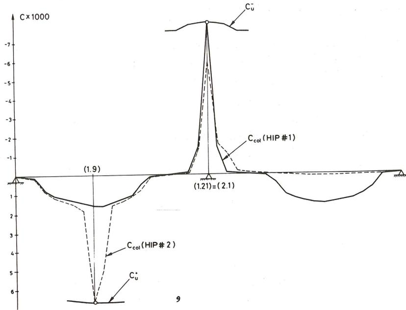
Fig. 9. Viga E2Vt/1/1. Curvaturas últimas y de colapso.
