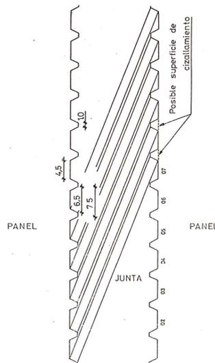
Fig. 12. Posible rotura del hormigón del panel.
