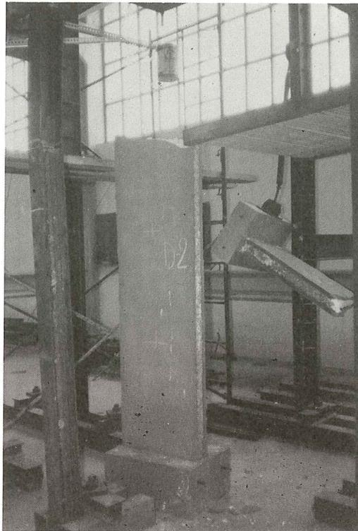
Fig. 19. Aspecto del panel D-2 ( $e = 0,5 h = 6,5$  cm) una vez que se ha producido su agotamiento resistente para  $P_U = 20$  t.
