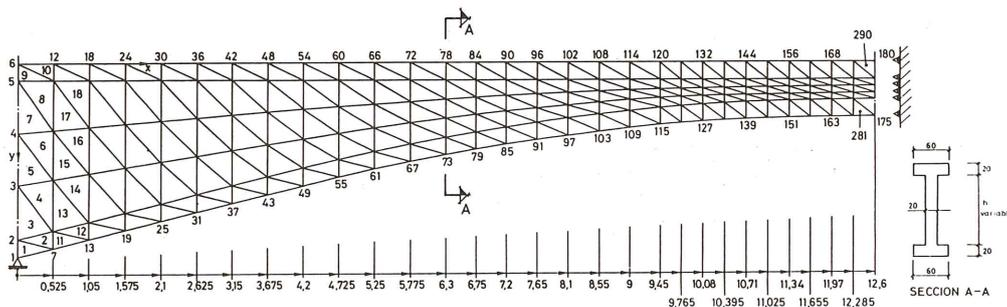
Fig. 6. Discretizaci n de un arco t mpano mediante elementos finitos.
