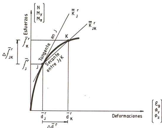
Fig. 6. Rigidez tangente  $\bar{K}_j^r$  y rigidez secante  $\bar{K}_{jK}^r$  de la rebanada.
