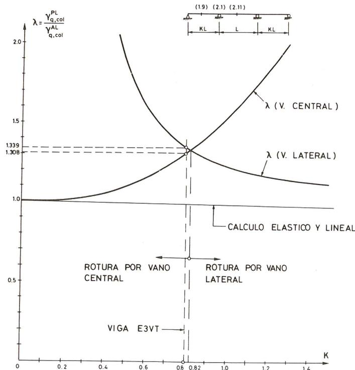
Fig. 3. Mecanismos de colapso en viga continua.
