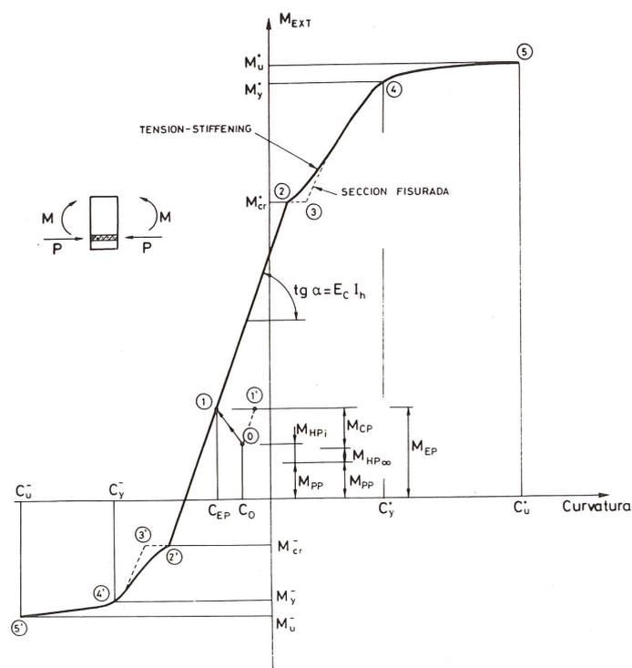
Fig. 1. Diagrama momento-curvatura de una sección pretensada.
