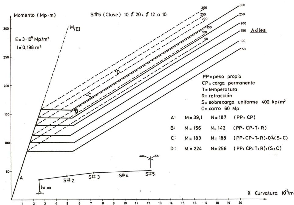
Fig. 8. Diagramas momento-curvatura de la sección S # 5.
