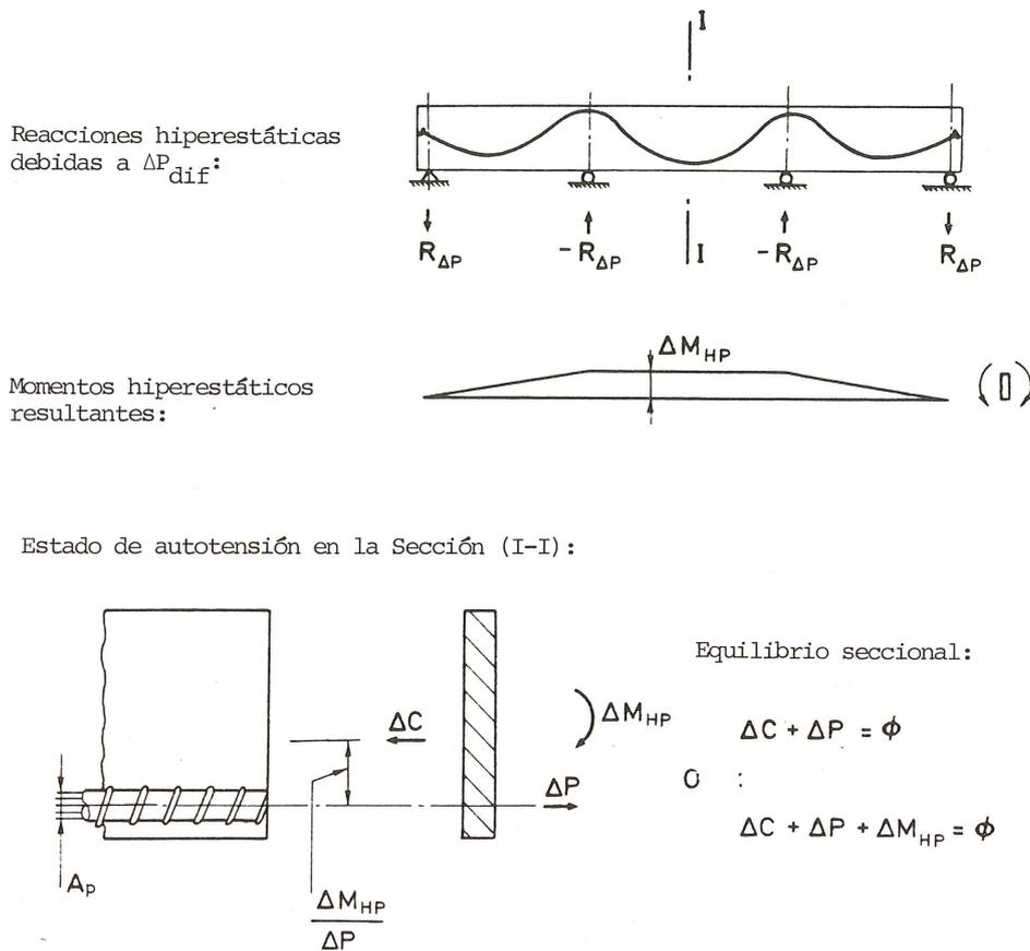
Fig. 2. Estado de autotensión engendrado en una viga continua por el efecto "puro" de las pérdidas diferidas de pretensado.
