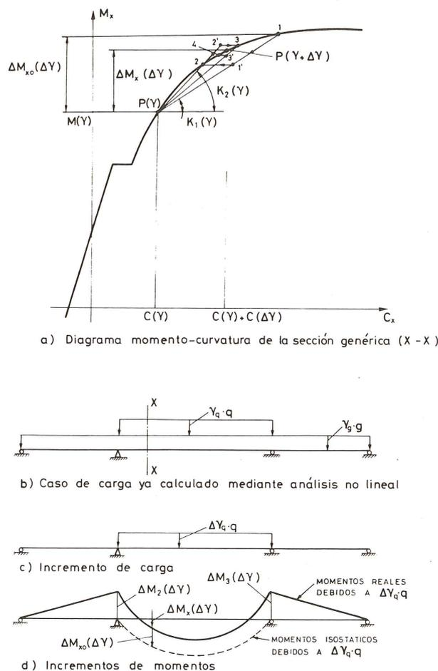
Fig. 2. Método de análisis no lineal de vigas continuas.
