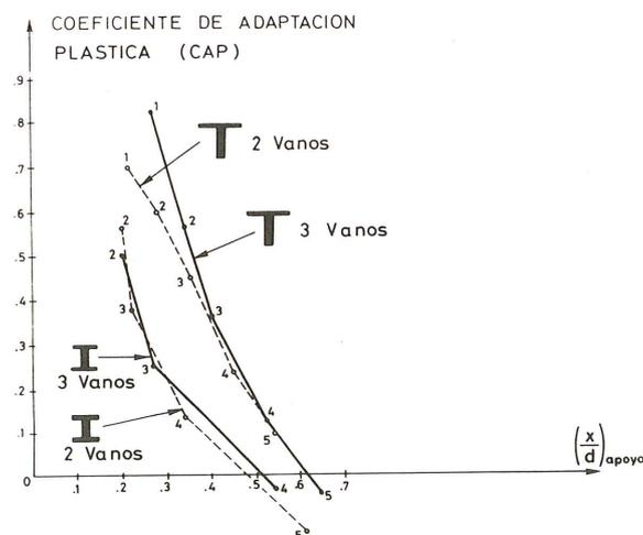
Fig. 1. Relaciones CAP-Ductilidad para las vigas T y doble T analizadas, correspondientes a hipótesis de carga pésima.
