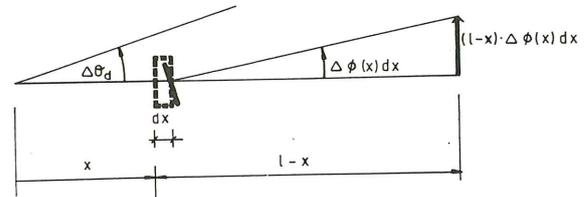
Fig. 12. Incrementos de la deformación de las rebanadas y su incidencia en los corrimientos experimentados por el tramo de pieza prismática.
