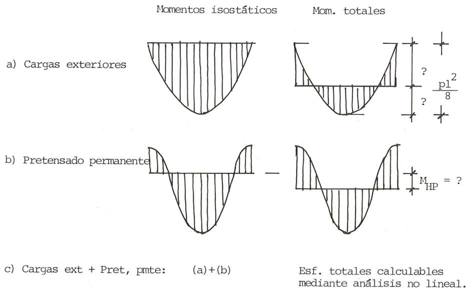
Fig. 5. Inconmensurabilidad de los valores de los esfuerzos en el ELU "debidos" a los efectos separados de las cargas externas y de la acción del pretensado.
