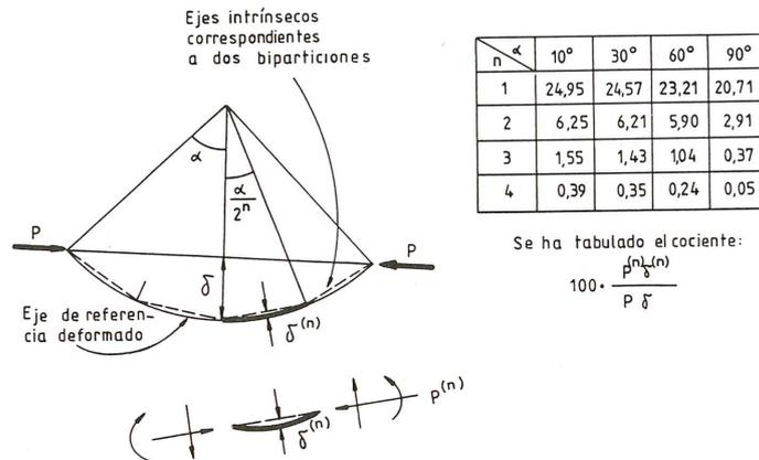
Fig. 3. Barra comprimida con  $n$  biparticiones.
