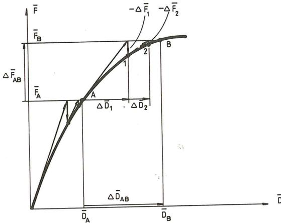
Fig. 16. Método incremental con iteraciones de tipo Newton-Raphson.
