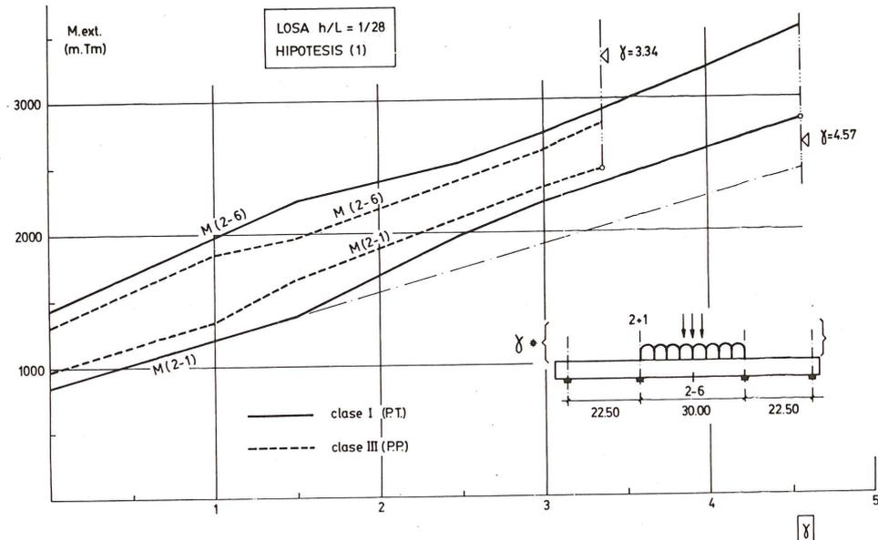
Fig. 2. Puente continuo de tres vanos de sección losa maciza con voladizos. Esbeltez = 1/28. Evolución de los momentos flectores en las secciones críticas según crece la sobrecarga en el vano central. Comparación de soluciones entre pretensado total y pretensado parcial.
