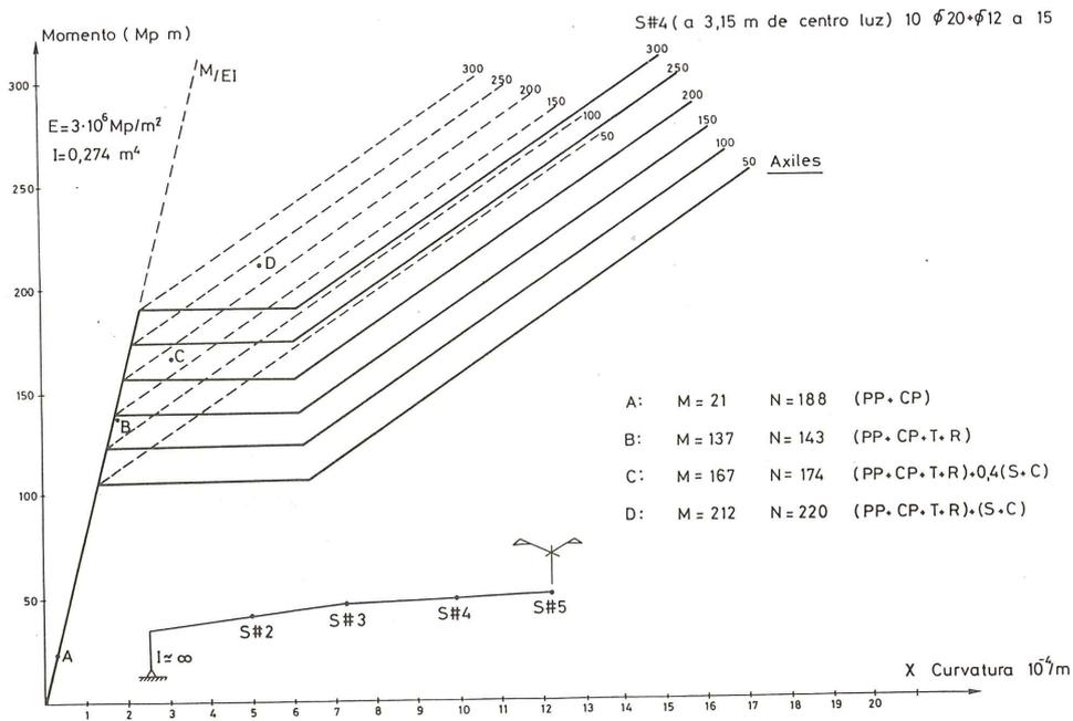
Fig. 9. Diagramas momento-curvatura de la sección S # 4.
