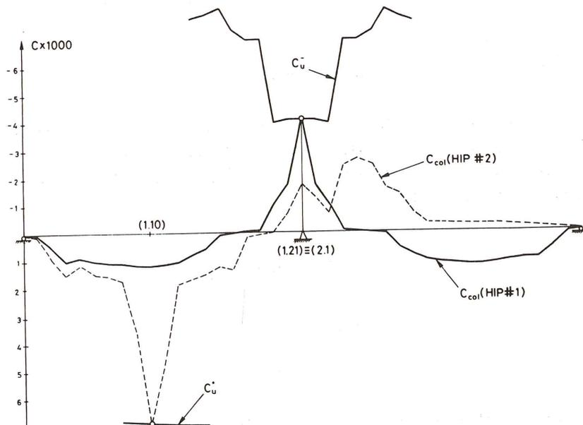
Fig. 10. Viga E2VT/1/5. Curvaturas últimas y de colapso.
