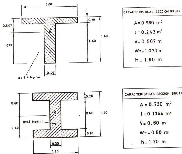
Fig. 3. Secciones transversales de las vigas analizadas.
