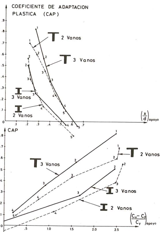
Fig. 13. Relaciones CAP-ductilidad para las vigas T y doble T analizadas, correspondientes a hipótesis de carga pésimas.
