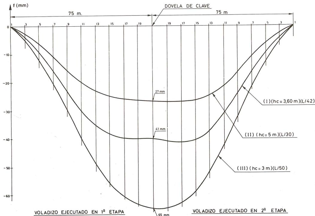
Fig. 8. Flechas residuales del vano central, a partir del momento de alineación de la imposta.
