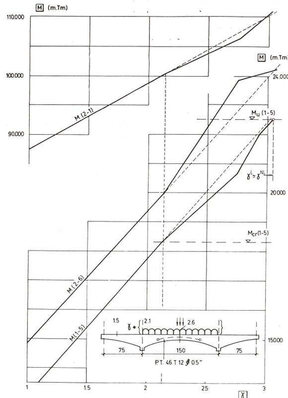
Fig. 4. Puente construido por voladizos sucesivos. Pretensado inferior de continuidad dimensionado en Clase I. Evolución de los momentos flectores en las secciones indicadas, (1-5), (2-1) y (2-6) según crece la sobrecarga en vano central. Inicio de la simulación de la rotura transcurridos 5 años desde la construcción.
