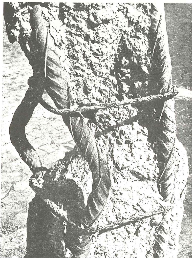
Ensayo de pilares a compresión
