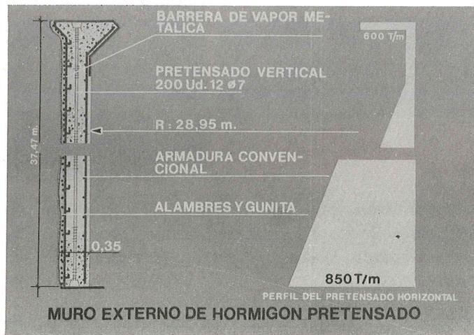
Este muro externo, de hormigón pretensado, incorpora simultáneamente las funciones de recipiente externo y las derivadas de un muro de seguridad; por lo que a este tipo de almacenamientos se les denomina comúnmente “depósitos integrados”.
