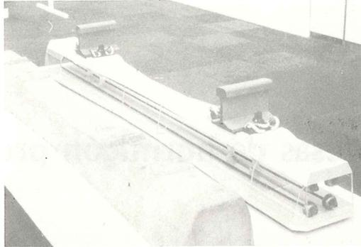
Fig. 1. Disposición de horquillas y elementos de sujeción del carril, junto a una traviesa real
