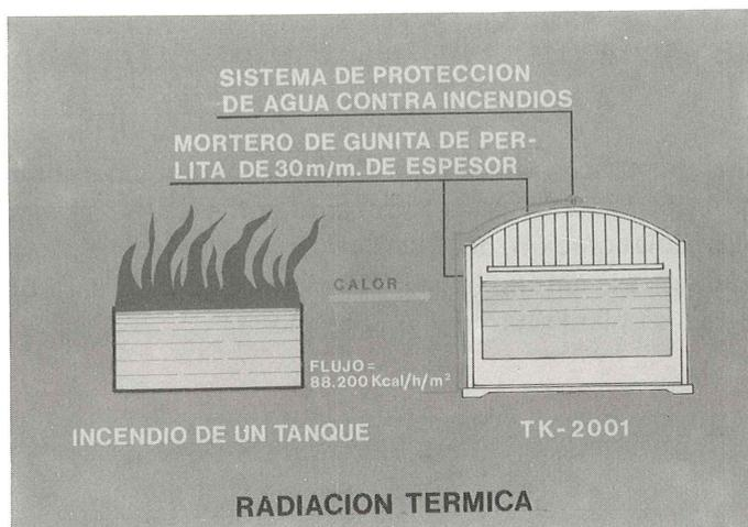
Los efectos de un fuego exterior sobre el muro, son similares a los producidos en el caso de derrame de G.N.L. pero, lógicamente, a la inversa. La distribución de temperatura en la estructura es función del tiempo, y puede determinarse con la ayuda de la ecuación diferencial de Fourier, que contiene los coeficientes de distribución térmica.
