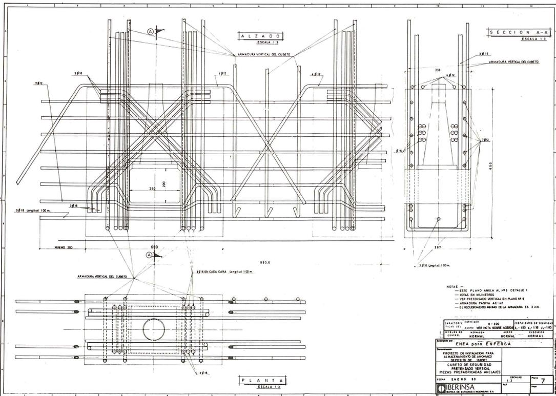
Para la nueva solución, no se ha estimado necesario considerar el coeficiente de mayoración 1,25 para el empuje hidrostático; calculándose el pretensado horizontal necesario de forma que la tensión de pretensado menos la tracción producida por el empuje hidrostático sea igual a  $27 \text{ kg/cm}^2$ .
