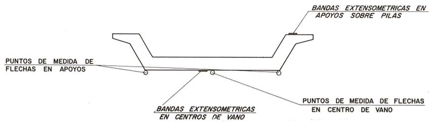
Fig. 11. Puntos de medida, en prueba de carga.
