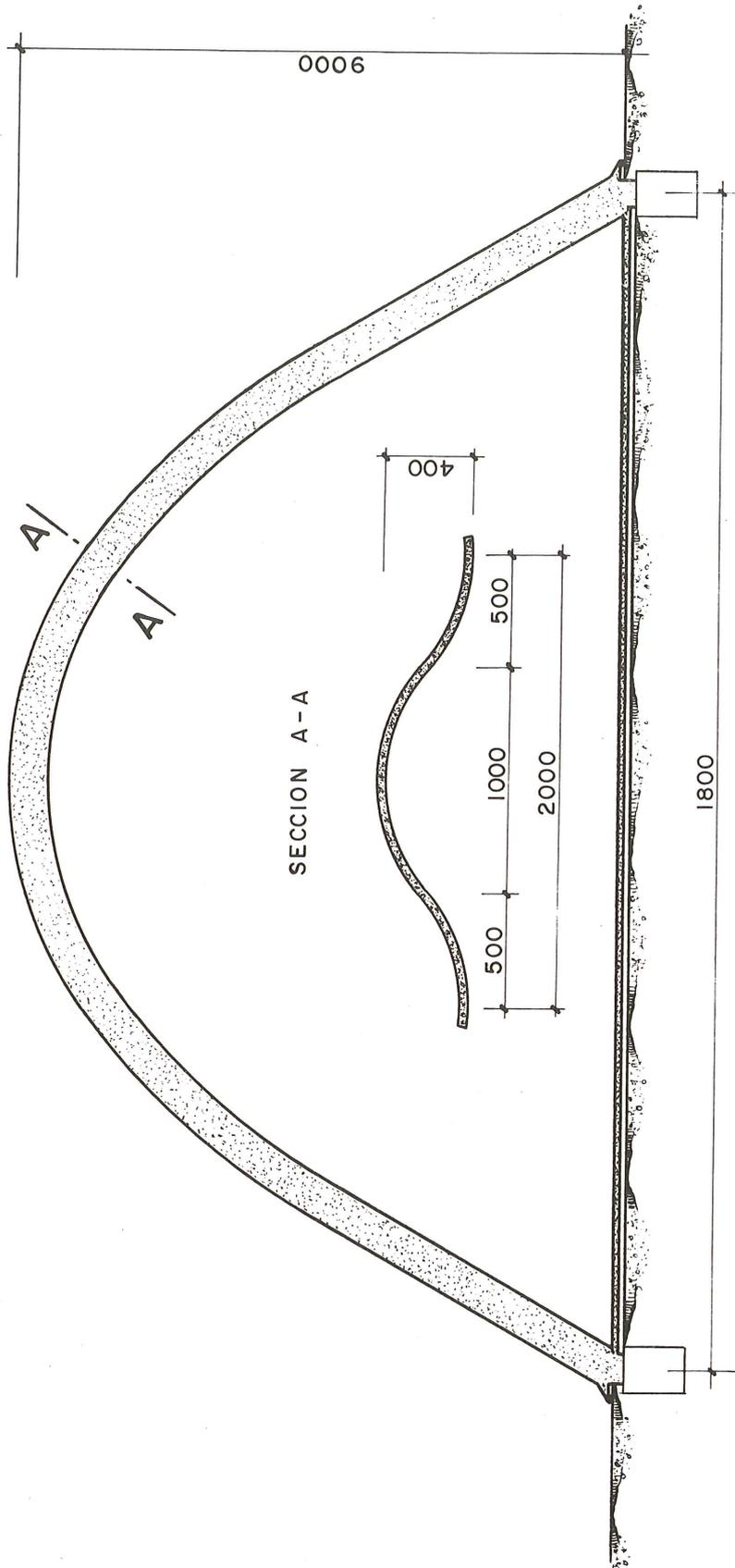
Fig. 41: Nave construida in situ para uso agrícola en URSS.
