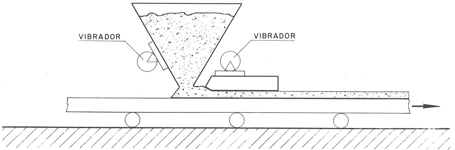
Fig. 9: Fabricación por laminado.
