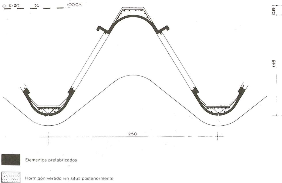
Fig. 34: Hall B del Salón de Exposiciones de Turín: sección transversal de los elementos ondulados.
