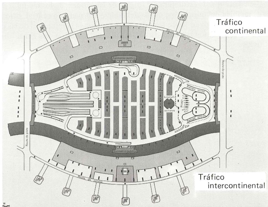
Figura 17.— Parque de estacionamiento de vehículos. Planta superior.
