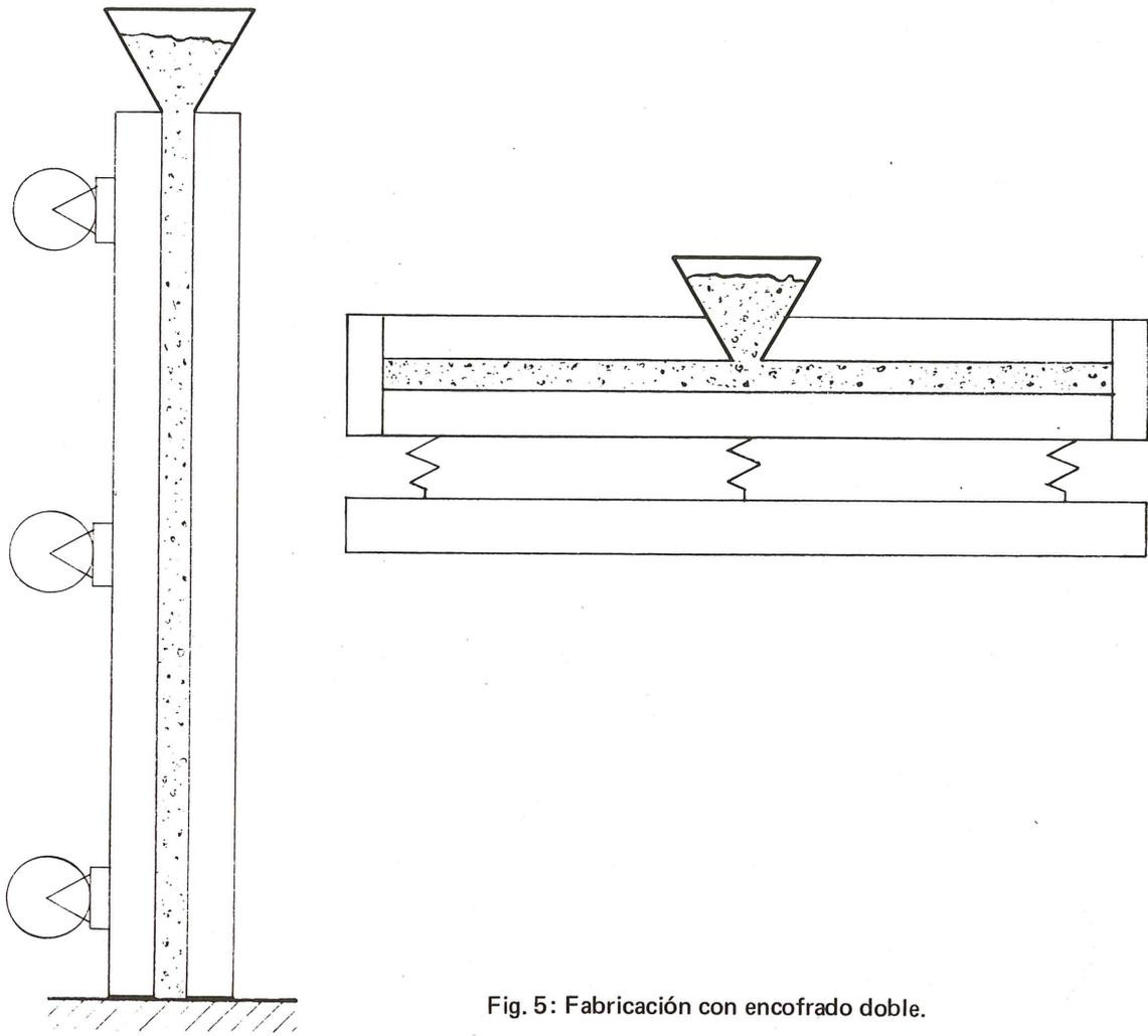
Fig. 5: Fabricación con encofrado doble.
