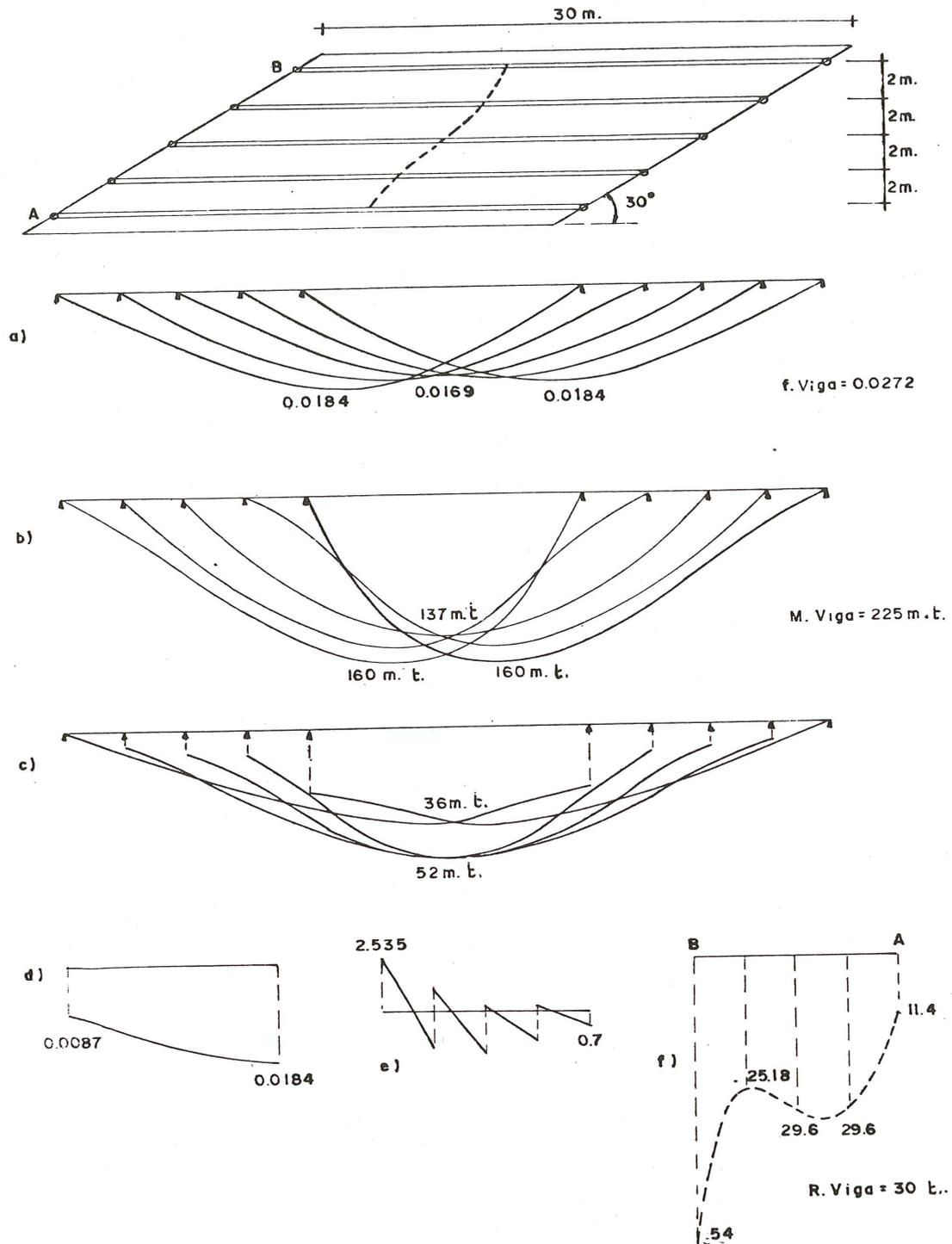
Fig. 3.5. Respuestas de tablero de vigas cajón, sin riostras. a) Corrimientos verticales. b) Leyes de momentos flectores longitudinales. c) Leyes de momentos torsores longitudinales. d) Corrimientos en sección 1-1. e) Momentos flectores transversales en sección 1-1. f) Reacciones en apoyos.
