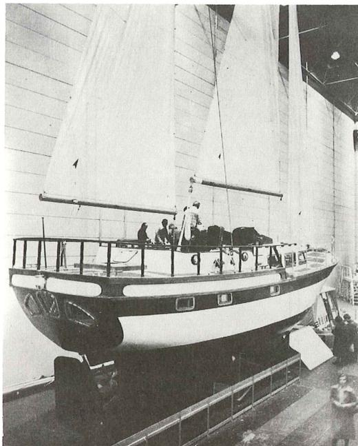
Fig. 14: Yate construido con ferrocemento en Alemania.
