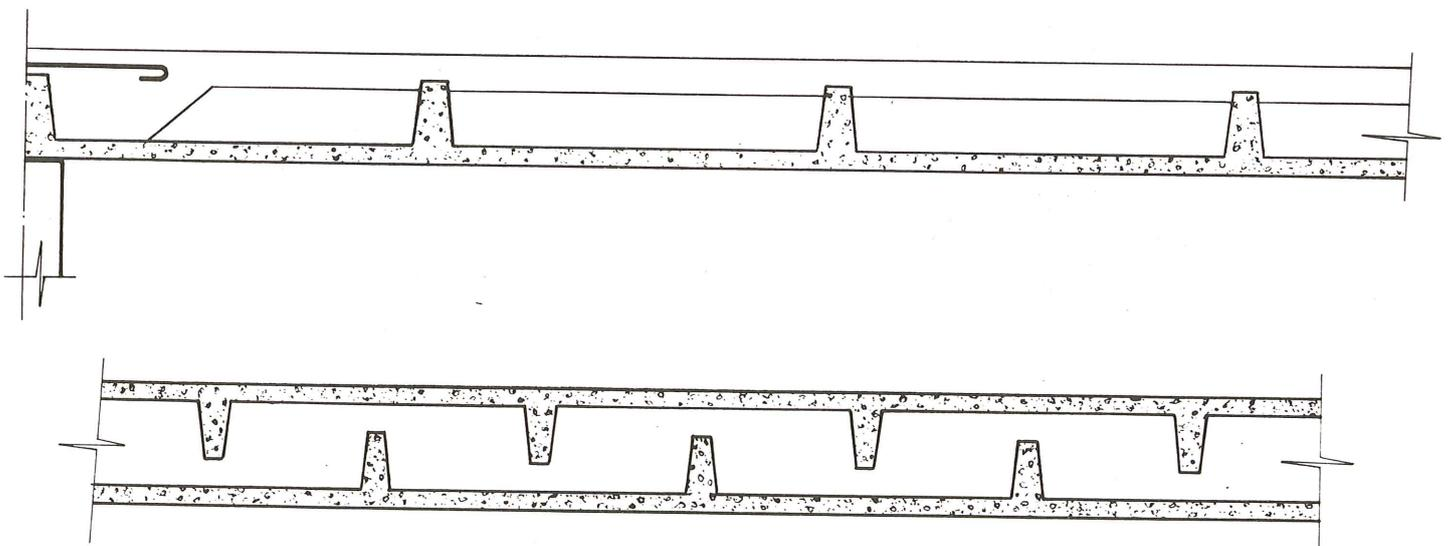
Fig. 21: Placas nervadas de ferrocemento para construcción prefabricada.
