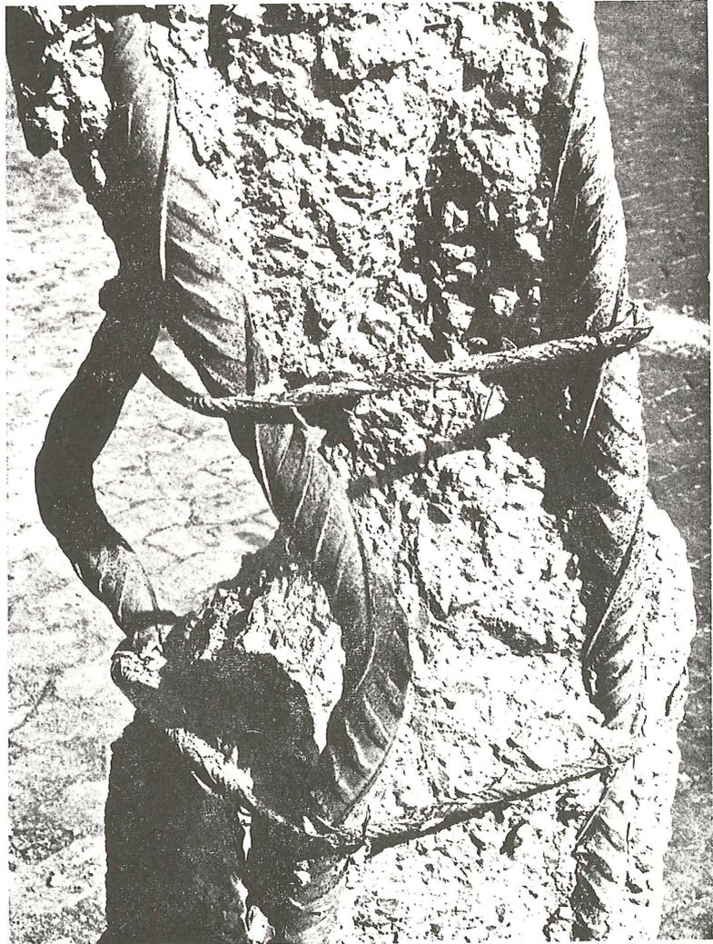
Ensayo de pilares a compresión centrada
