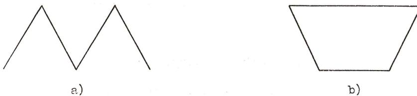
Fig. 12. Lámina plegada de sección simple
