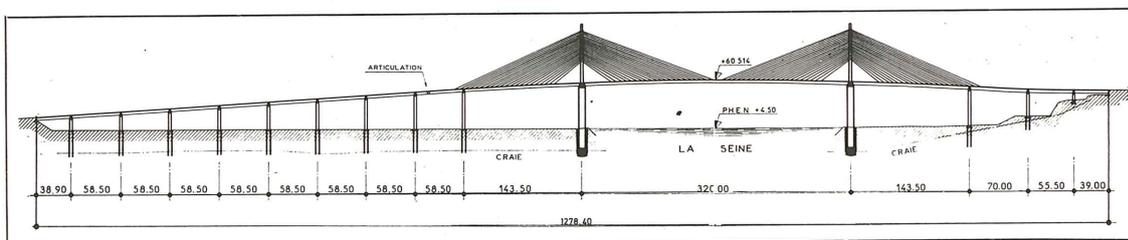
Fig. 1.1. Puente de Brotonne — Alzado general.
