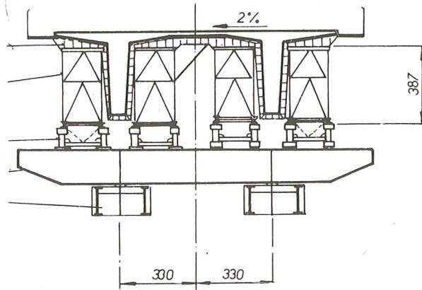
Fig. 10.3 Sección de la cimbra-encofrado del puente sobre el río Szava.
