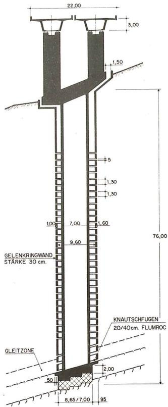
Fig. 9.2 Sección transversal del viaducto Lehnhen
