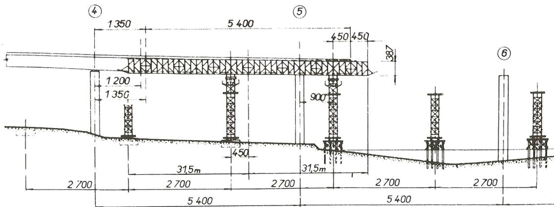
Fig. 10.2 Sistema constructivo en el puente sobre el Sázava.
