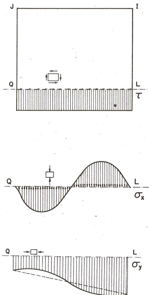
Fig. 15.—Tensiones en el nivel límite de fisuración.
