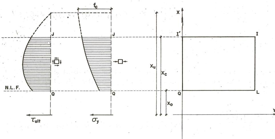
Fig. 22.—Variación de los esfuerzos tangenciales límites a lo largo de la sección vertical.
