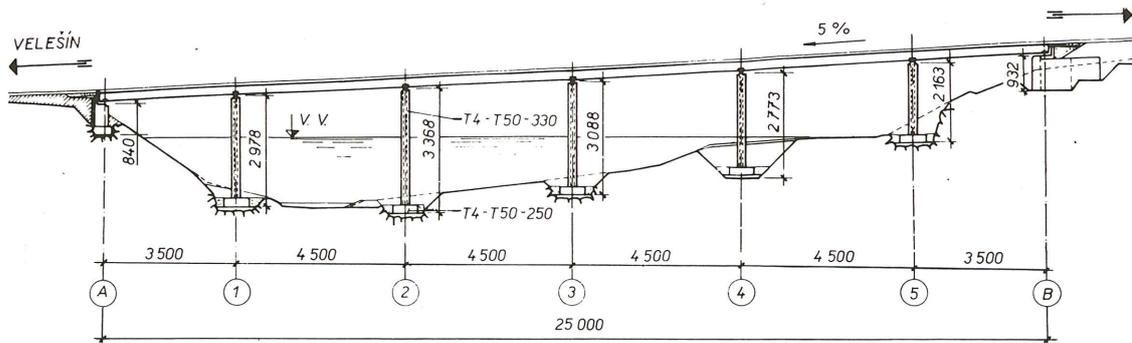
Fig. 10.5 Puente sobre el Rímov construido por empujamiento.
