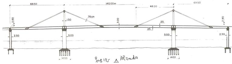
Fig. 3.11 Puente sobre el río Magdalena en Barranquilla, Colombia. Alzado.
