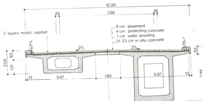
Fig. 13.1 Secciones transversales de los tres puentes sobre el Körös.
