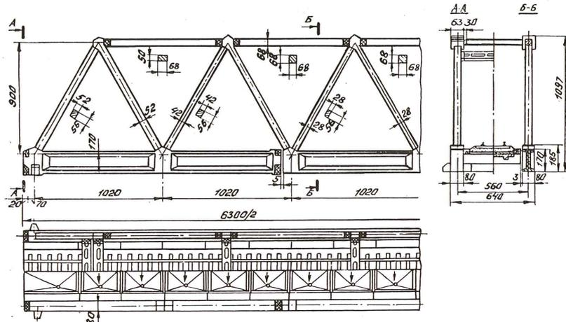
Fig. 7.7 Modelo de puente ferroviario de 63 m.
