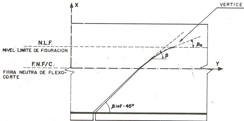
Fig. 2.—Modelo de trazado de fisuras.
