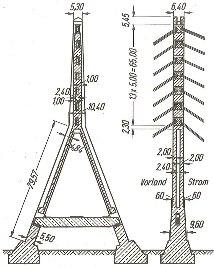
Fig. 2.6 Sección vertical del pilono del puente de Düsseldorf-Flehe.
