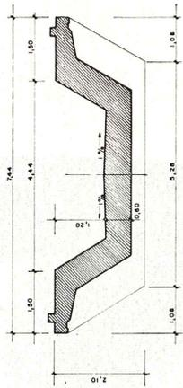
SECCION TRANSVERSAL POR ESTRIBO
