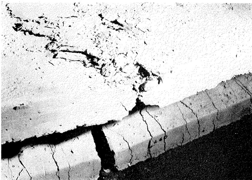
Fotografía 11.— Viga tipo A en rotura.
