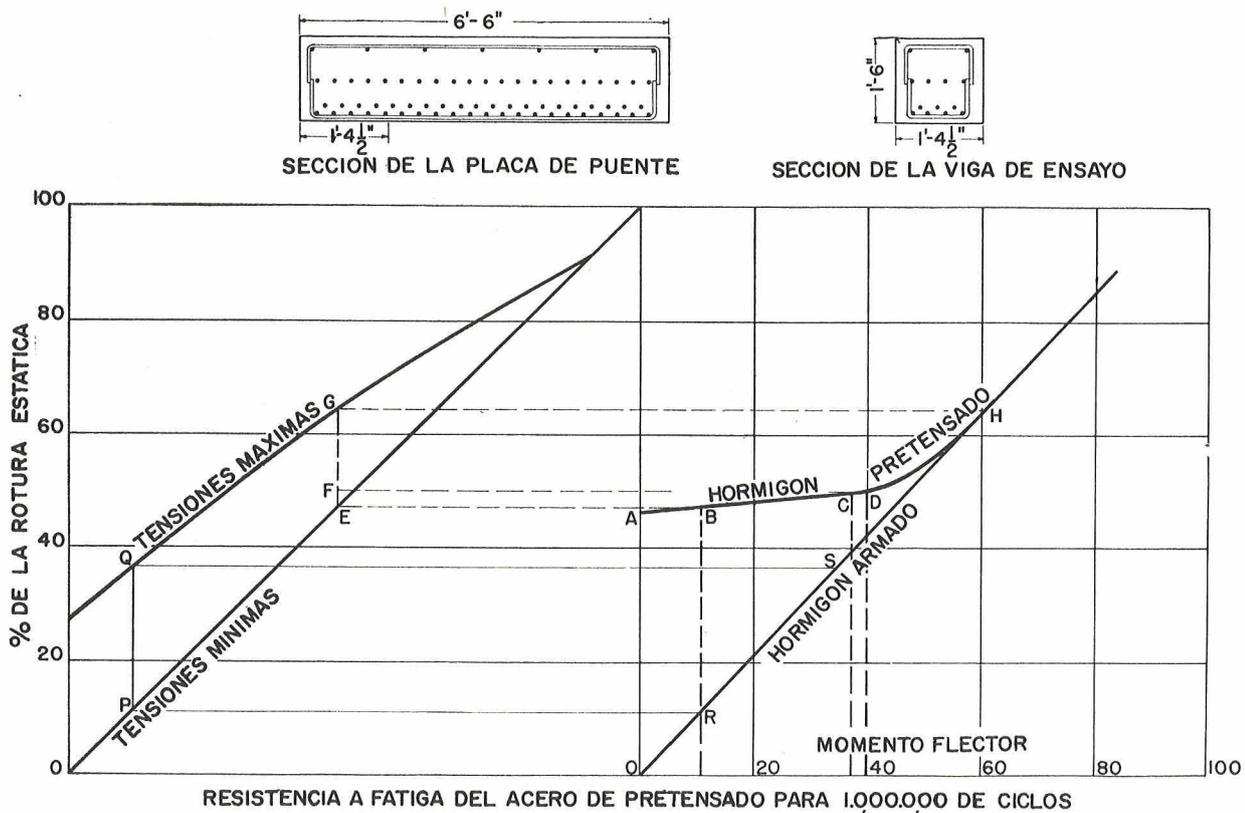
Fig. 5. Gráfico para cargas repetidas, obtenido de los ensayos hechos en la Universidad de Lehigh.
