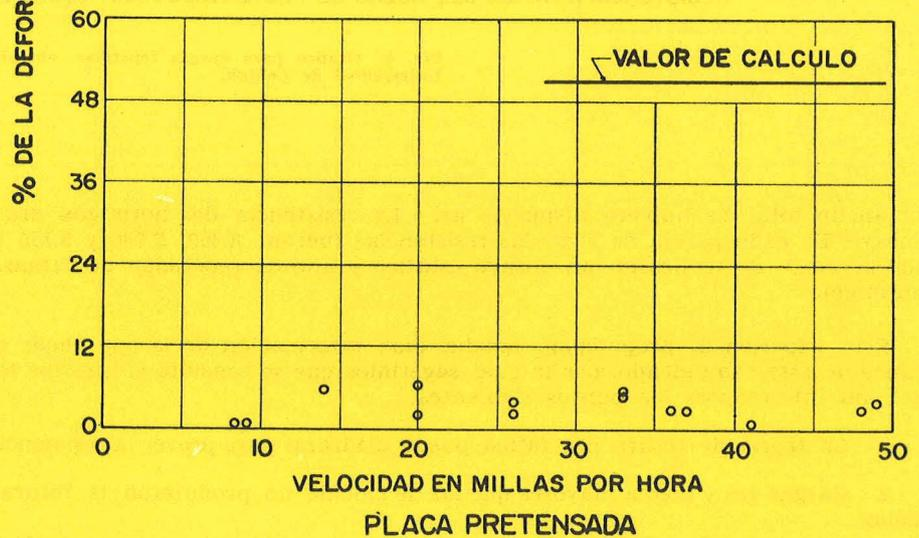
Fig. 4. Impacto total medido sobre el hormigón en el puente de Hunnewell, Missouri.
