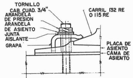
Fig. 16. Detalle de sujeción. Proyecto de la AAR.
