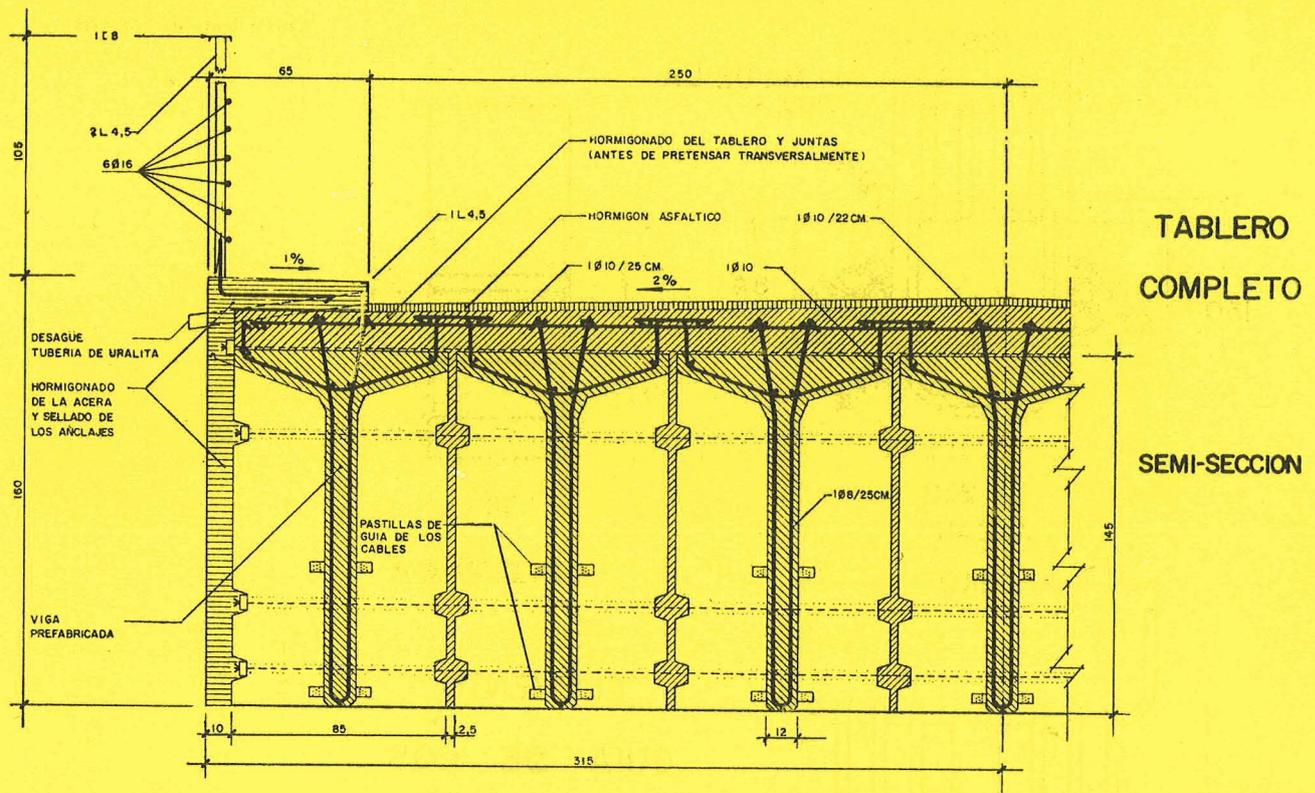
clorocaucho. Las 42 vigas son idénticas, incluso las de borde, para facilitar la producción en serie de los encofrados y las pastillas antes citadas. Cada viga lleva 28 cables de tres hilos, utilizándose, en el tesado, el sistema Barredo.
