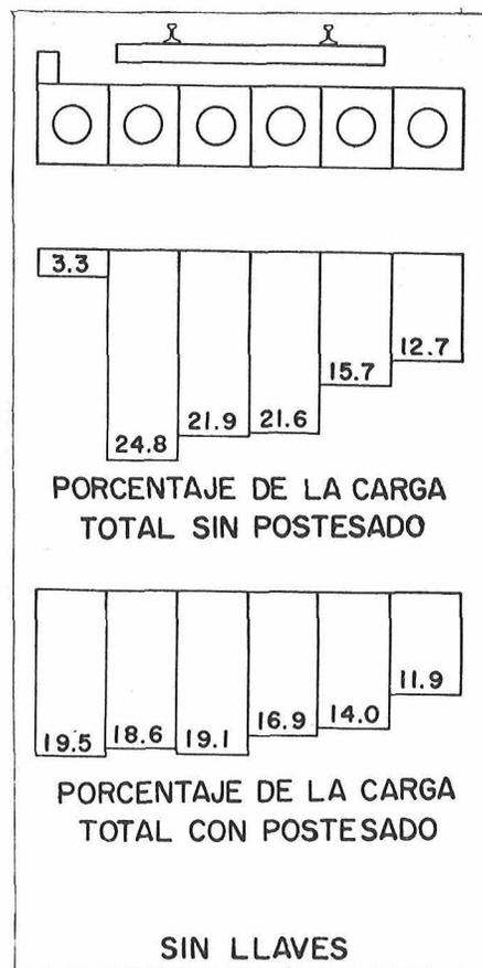
Fig. 11. Distribución trans-versal sin llaves de transmisión de cortante. Puen-te de Pompano Beach, Florida.
