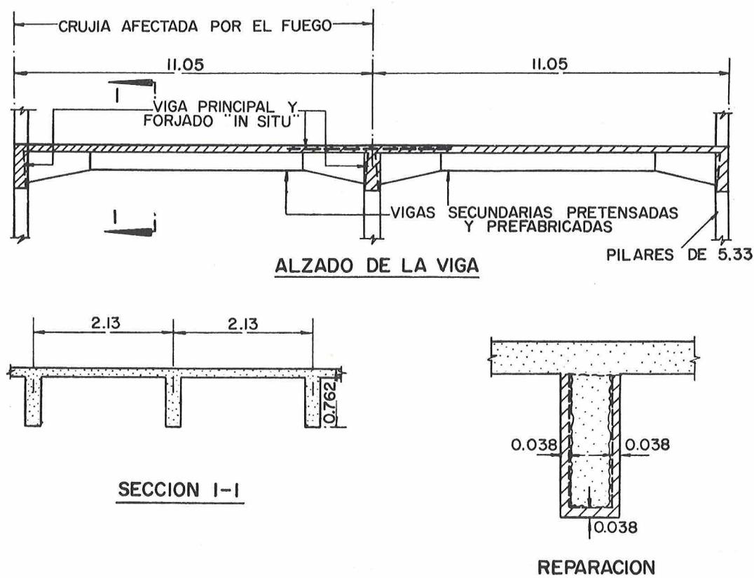
tesadas prefabricadas, elevadas y colocadas con grúa sobre el encofrado de las vigas principales, después de lo cual se ponía la armadura de continuidad entre las vigas secundarias prefabricadas. A continuación de colocar las armaduras de las vigas principales y forjado, se hormigonó formando una unidad monolítica.
