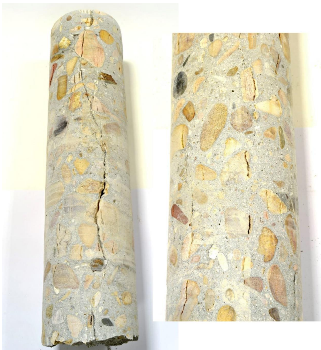
Figura 23. Fisuras longitudinales en testigos resultado de las perforaciones verticales a posteriori para el enhebrado del hilo de diamante durante el proceso de demolición. Foto cortesía del Laboratorio de Química de la Escuela de Ingenieros de Caminos, C. y P. de Madrid, no incluida en [11]
