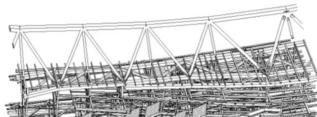
Figura 38. Viga corona. Zona central.
