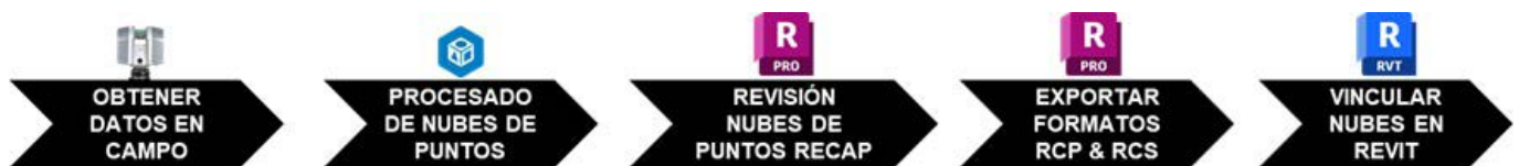
Figura 20. Proceso control calidad modelo con Nubes de puntos..
