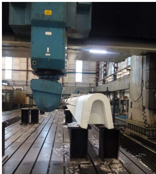
Figura 41. Proceso de taladrado cercha.
