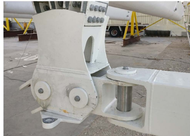
Figura 61. Mecanizado y ensamblado barras de estabilización.
