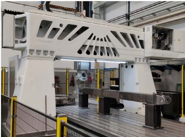
Figura 61. Mecanizado y ensamblado barras de estabilización.
