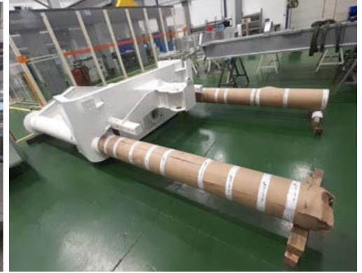
Figura 60. Diafragma ensamblado preparado para el transporte.
