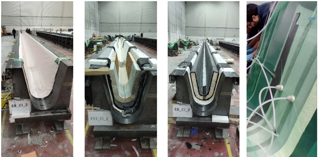
Figura 38. Proceso de fabricación cordón inferior.
