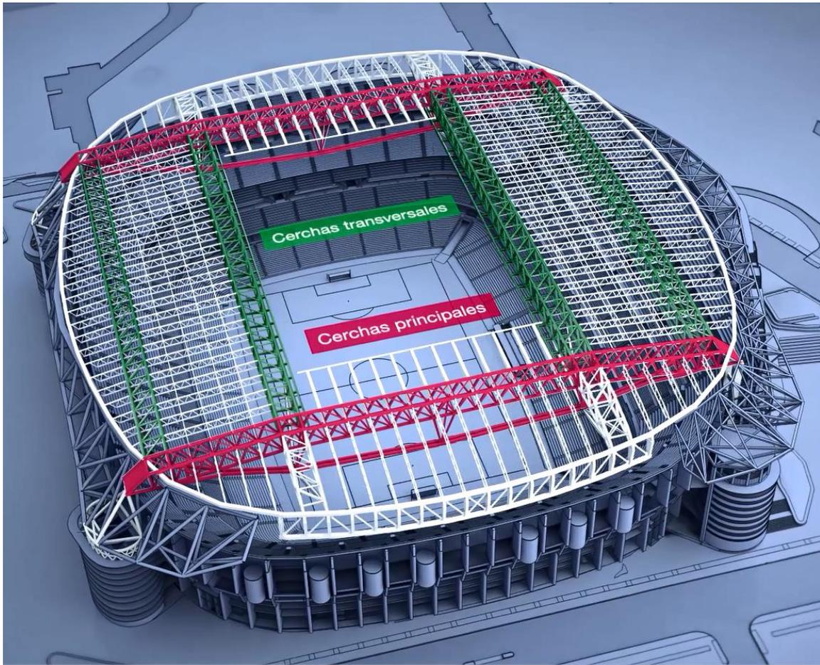
IMAGEN 14 - ESTRUCTURA DE CUBIERTA, PLANTA
