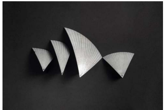
Figura 2. Representación de la solución formal de las superficies de la cubierta de la Ópera de Sydney como parte de la superficie de una esfera. Fuente: "How do you preserve an architectural icon for future generations?".
