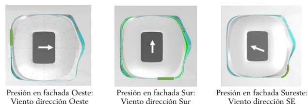
Figura 17. Esquema de las direcciones de ataque del viento escogidas para la modelización del CFD en presión.
