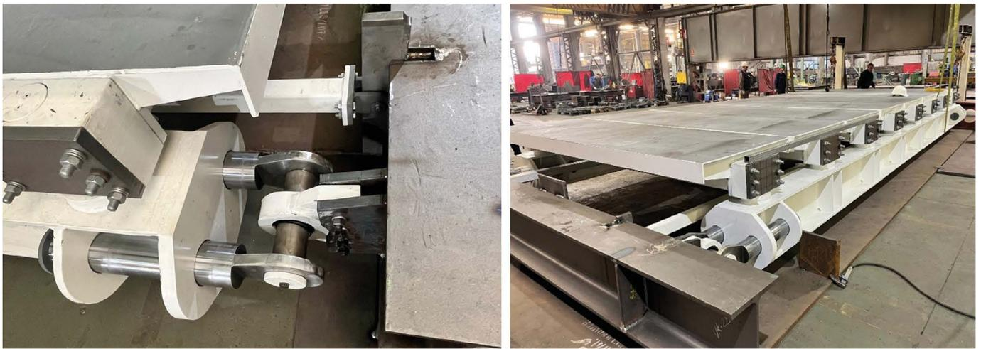
Figura 56. Prueba de funcionamiento puentes basculantes.
