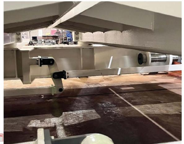
Figura 57. Sistema de centrado mecánico puentes basculantes.
