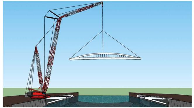
Figura 3. Propuesta de montaje con grúa desde un estribo
