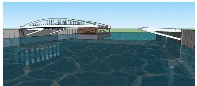
Figura 4. Propuesta de montaje por empuje con ayuda de pontona.
