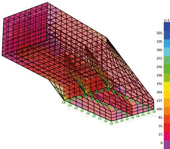
Figura 15. Modelo de cálculo de la percha.
