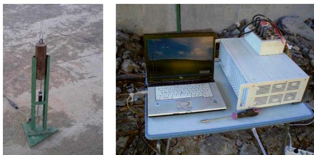
Figura 42. Transductor de desplazamiento tipo potenciométrico (izda) y receptor de datos de señal (dcha).
