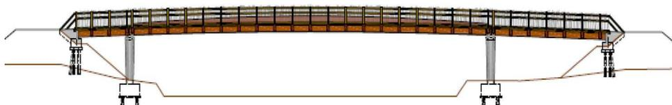
Figura 4. Alzado de la alternativa de viga metálica isostática de 3 vanos.
